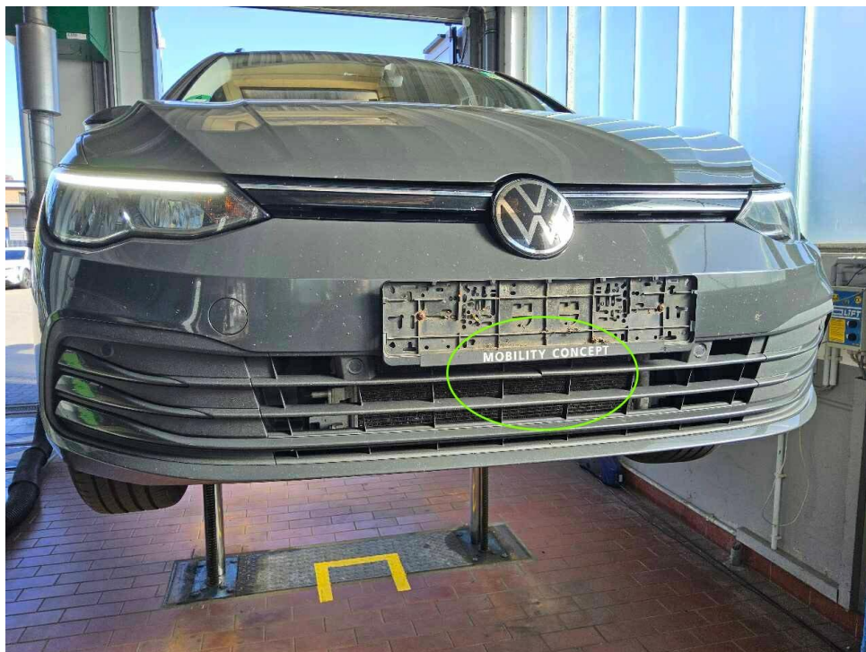
Bild 22 : Gitter Stoßängerverkleidung vorne gebrochen
