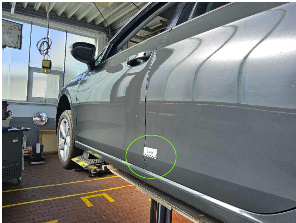
Bild 26 : Tür hinten links leicht eingedellt und verkratzt
