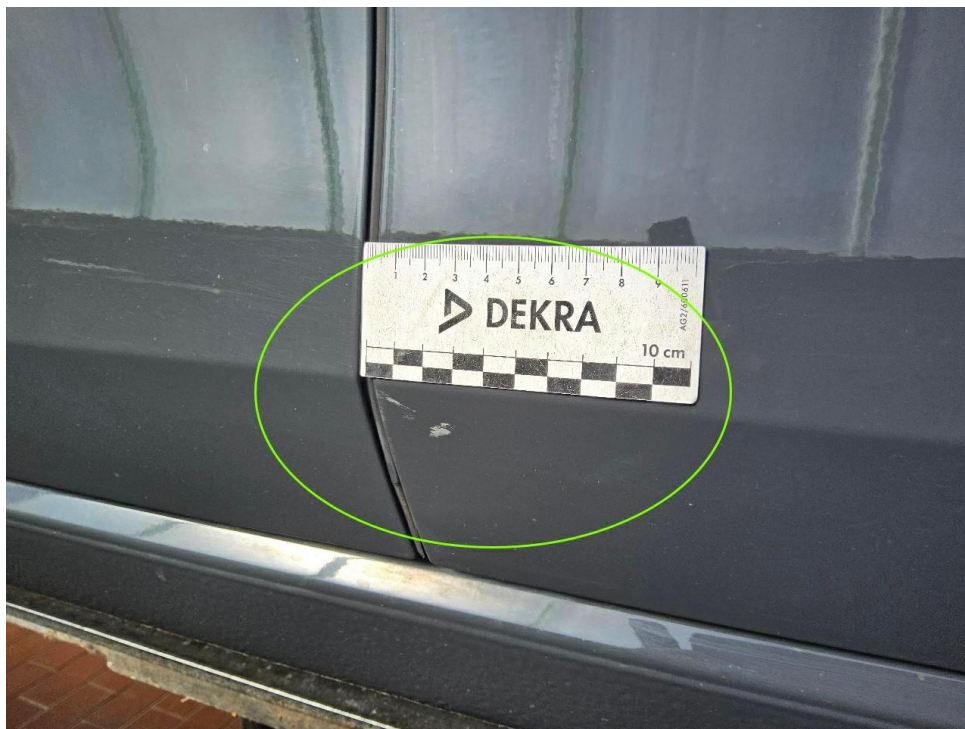
Bild 27 : Tür hinten links leicht eingedellt und verkratzt
