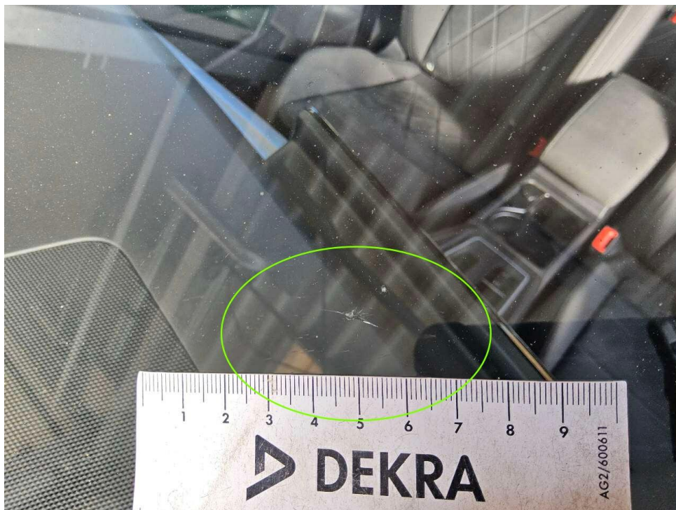
Bild 15 : Windschutzscheibe Steinschlag mit Rissbildung
