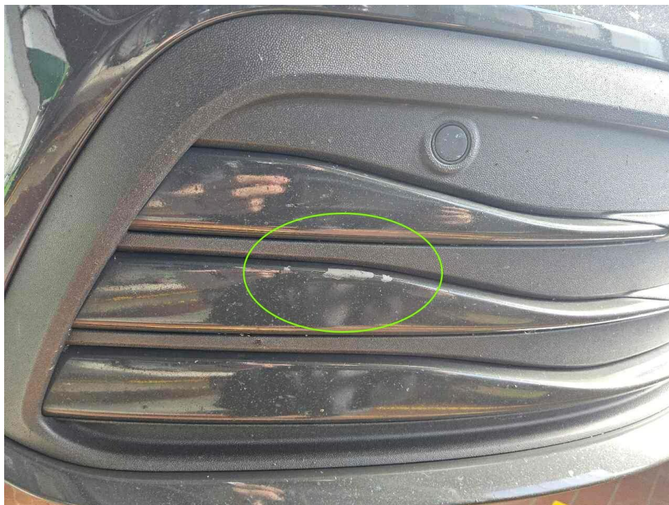
Bild 25 : Stoßfängerverkleidung vorne links Lackabpaltung
