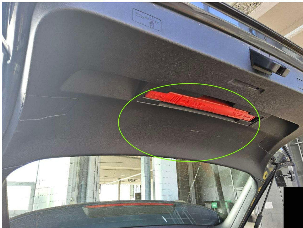
Bild 20 : Verkleidung Heckklappe leicht verkratzt
