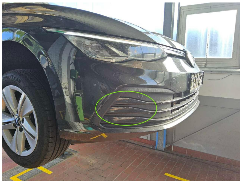
Bild 24 : Stoßfängerverkleidung vorne links Lackabpaltung
