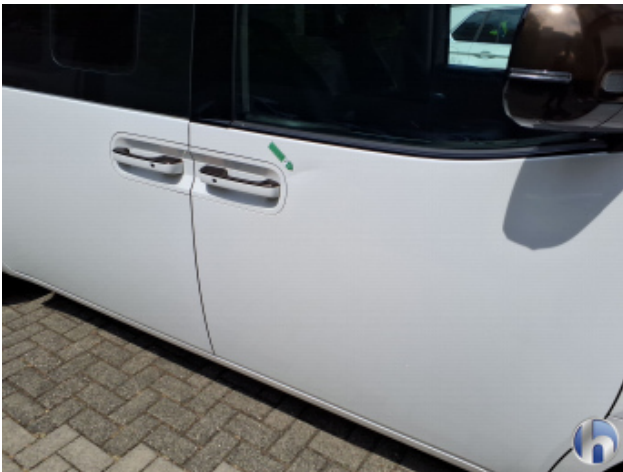
2. Tür Vorne - Rechts Beschädigt - Instandsetzen und Lackieren
