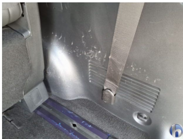
6. Heckklappenverkleidung Beschädigt - Erneuern
