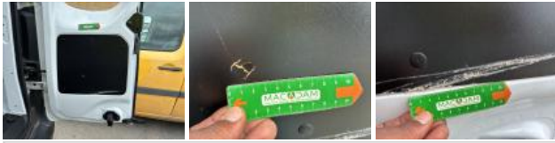
Boot door lining L, Scratch(es), Replace
