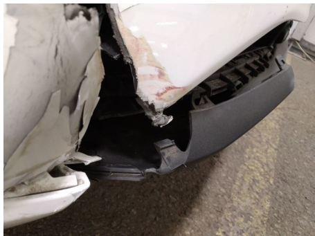
Stoßfängergrill / Vorne / Gebrochen
