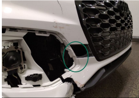
Pralldämpfer Stoßfänger / Vorne / Gebrochen
