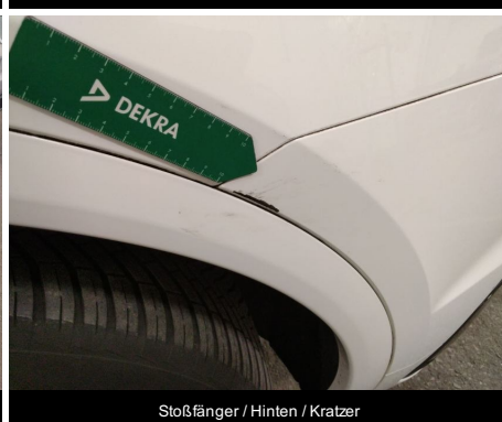
Stoßfänger / Hinten / Kratzer
