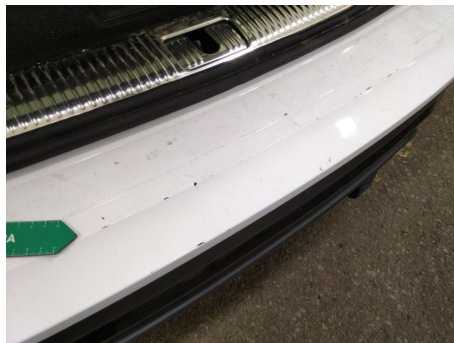
Stoßfänger / Hinten / Kratzer
