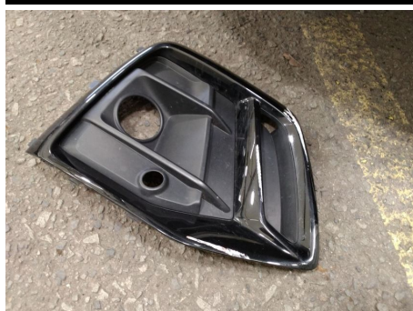
Stoßfängergrill / Vorne Rechts / Gebrochen
