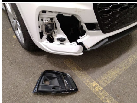
Stoßfängergrill / Vorne Rechts / Gebrochen
