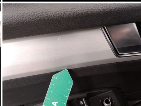
Zierleiste Türverkleidung / Vorne Links / Kratzer
