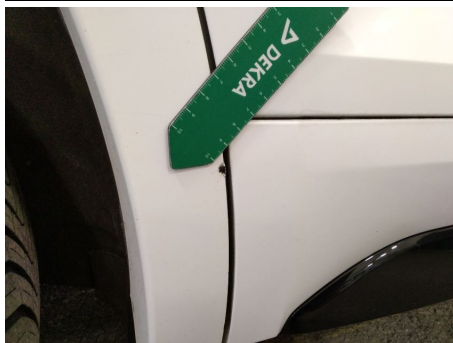
Kotflügelzerleiste / Hinten Rechts / Kratzer
