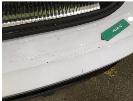
Stoßfänger / Hinten / Kratzer
