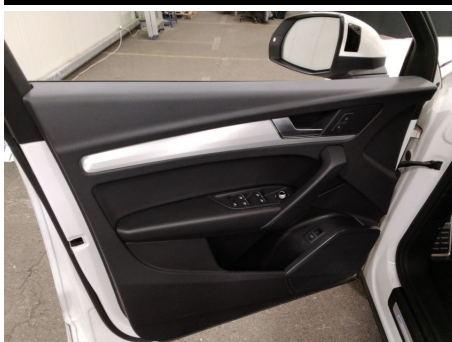
Zierleiste Türverkleidung / Vorne Links / Kratzer
