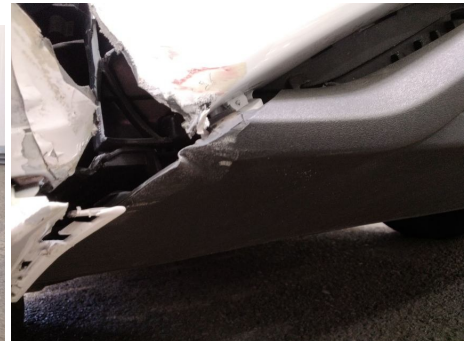
Stoßfängergrill / Vorne / Gebrochen
