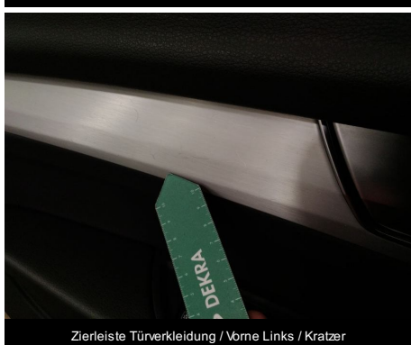
Zierleiste Türverkleidung / Vorne Links / Kratzer
