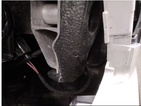
Pralldämpfer Stoßfänger / Vorne / Gebrochen
