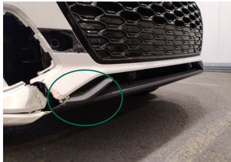
Stoßfängergrill / Vorne / Gebrochen
