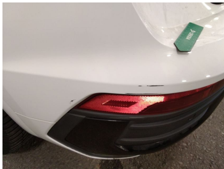
Stoßfänger / Hinten / Kratzer
