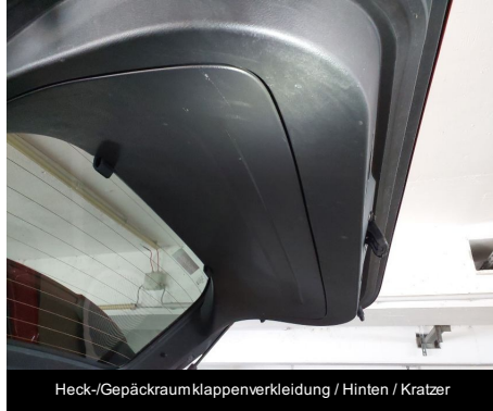
Heck-/Gepäckraumklappenverkleidung / Hinten / Kratzer
