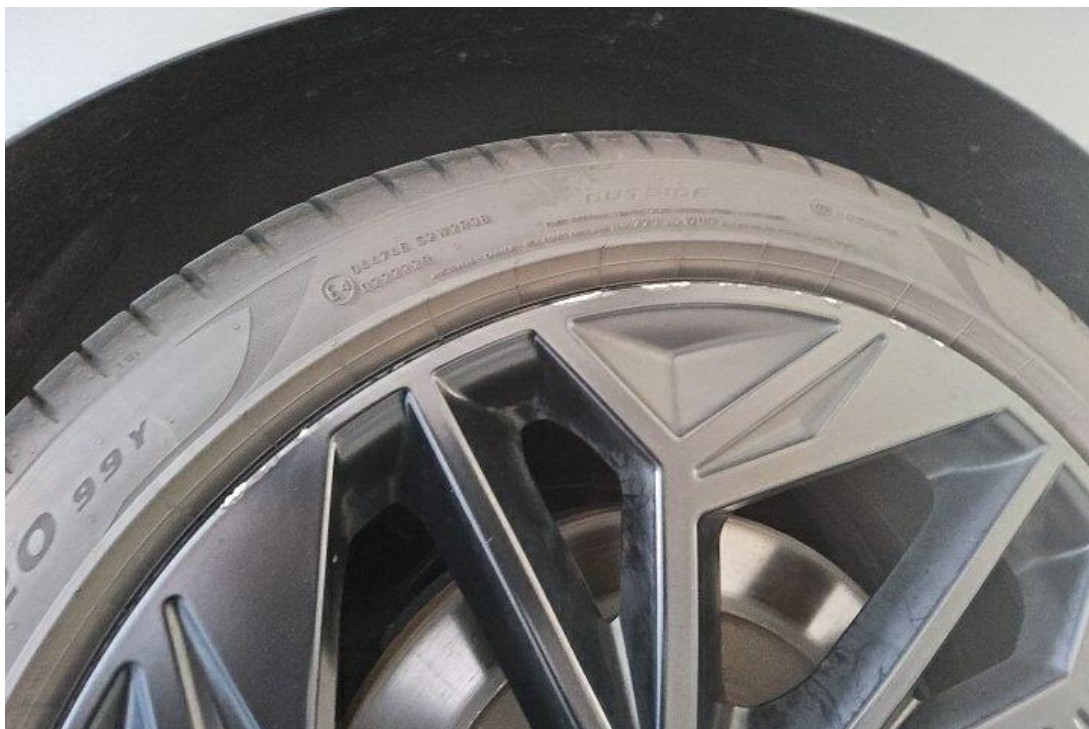
Bild 11 : Felge hinten links, verschrammt, lackieren mit Lackaufbau
