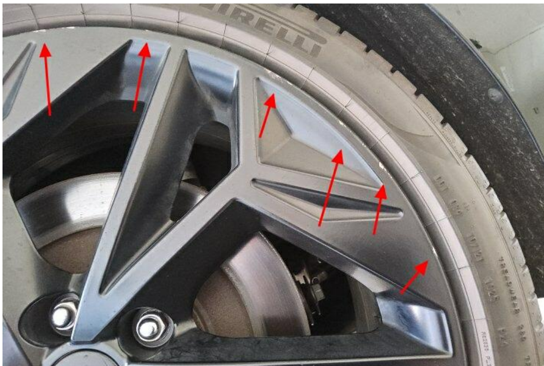
Bild 8 : Felge hinten links, verschrammt, lackieren mit Lackaufbau
