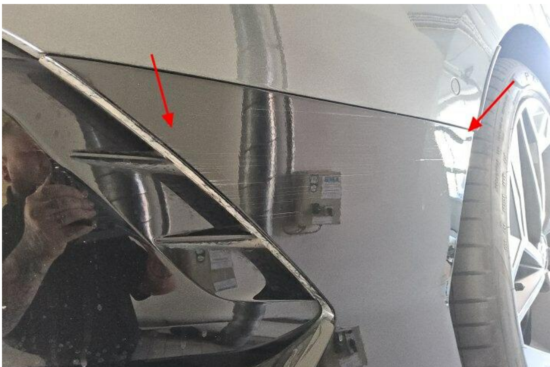
Bild 10 : Stoßfänger hinten, verschrammt, lackieren mit Lackaufbau
