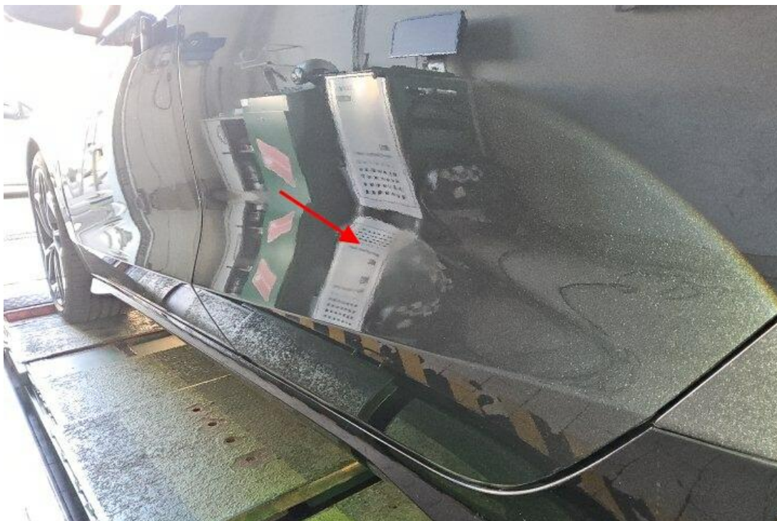
Bild 12 : Tür hinten links - Instandsetzungsspuren Polieren
