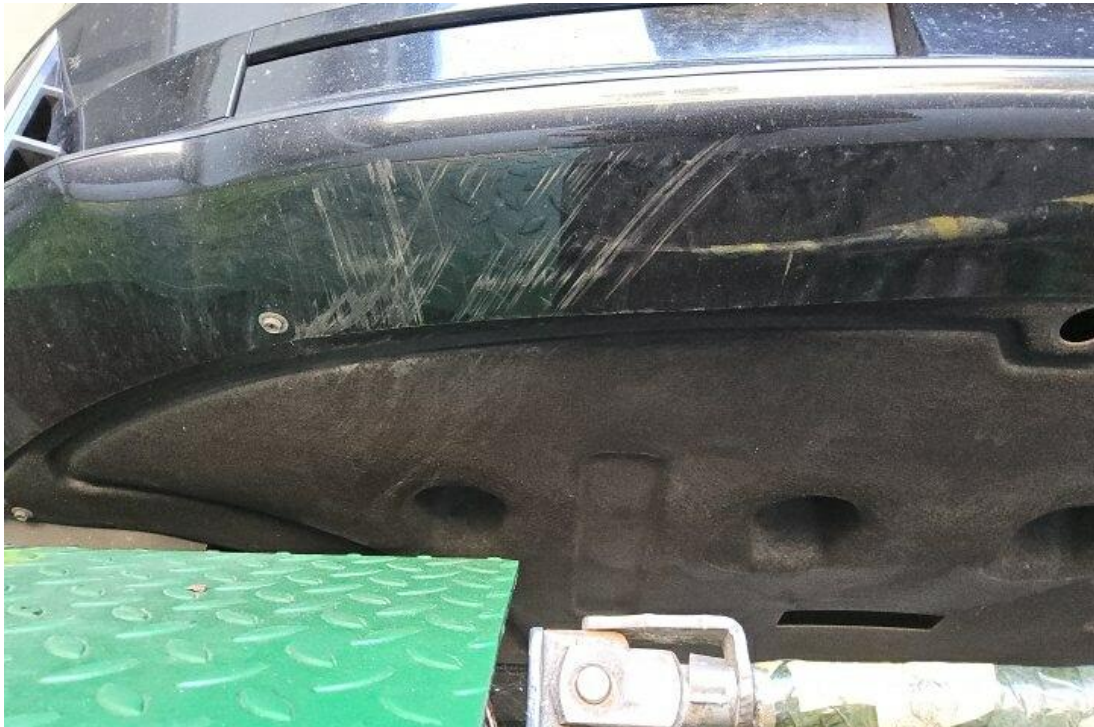
Bild 9 : Frontspoiler, verschrammt, Gebrauchsspur Unterhalb Sichtkante
