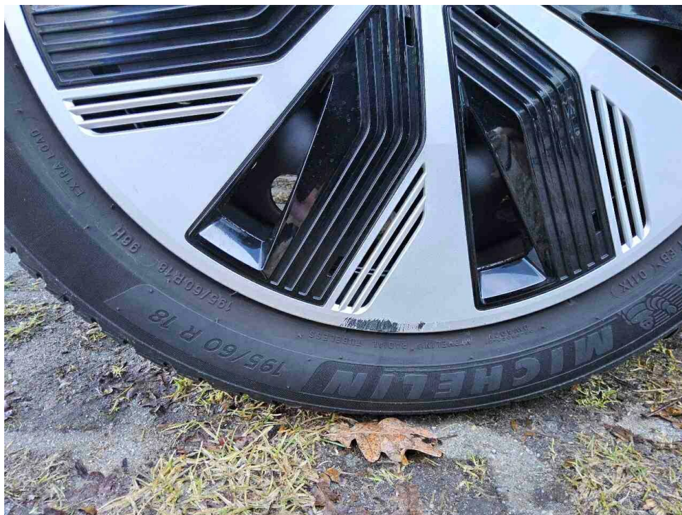
Bild 11 : Felge hinten rechts Radzierdeckel, verschrammt, erneuern
