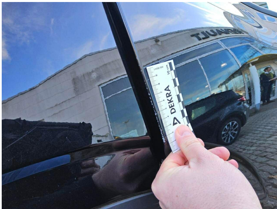
Bild 18 : Tür hinten rechts Türkante, verschrammt, smart repair
