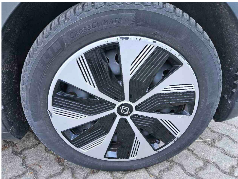
Bild 13 : Felge vorne rechts Radzierdeckel, zerbrochen, erneuern
