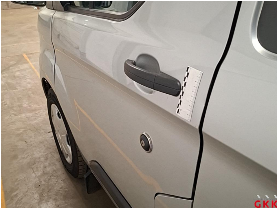
Bild 23 Tür vorne links, beschädigt, instand setzen - lackieren
