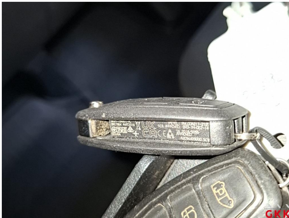
Bild 14 Hauptschlüssel, mit Fernbedienung, beschädigt, ersetzen
