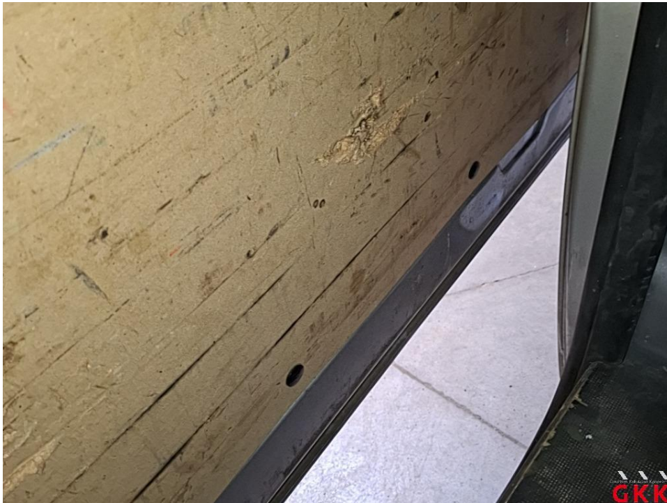
Bild 35 Schiebetür rechts, Innenverkleidung, beschädigt, ersetzen
