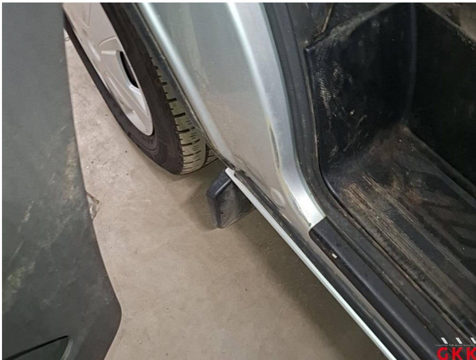
Bild 20 Tür hinten links, Einstieg, verkratzt, Smartrepair
