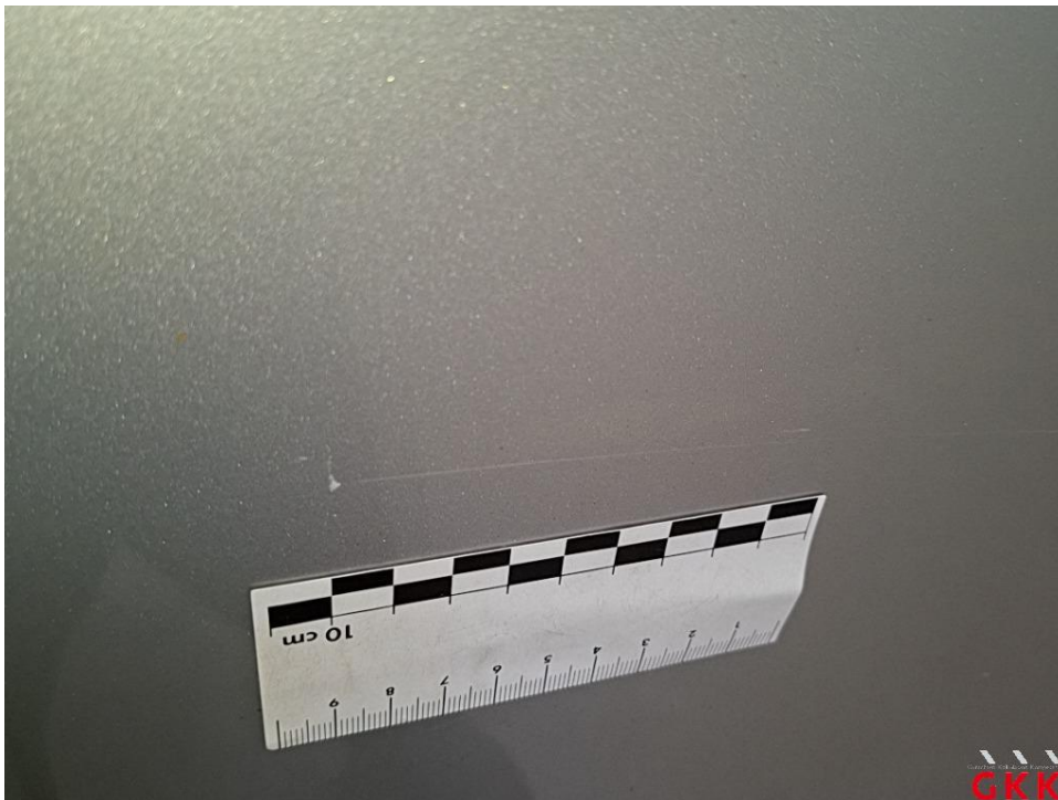
Bild 30 Seitenwand rechts, unterhalb, verkratzt, lackieren
