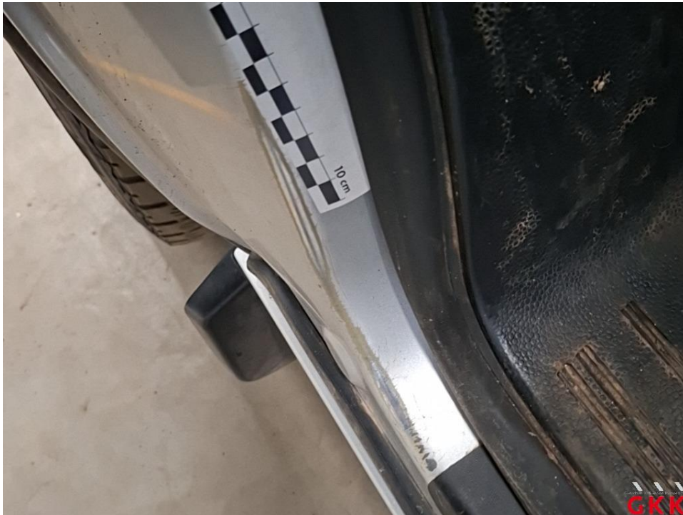
Bild 21 Tür hinten links, Einstieg, verkratzt, Smartrepair
