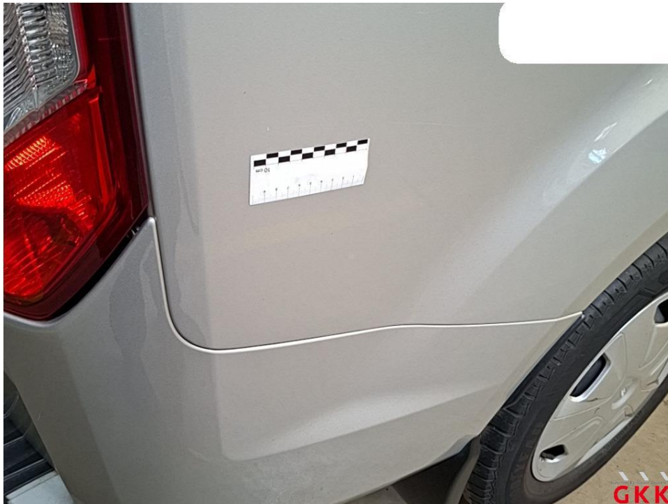
Bild 29 Seitenwand rechts, unterhalb, verkratzt, lackieren
