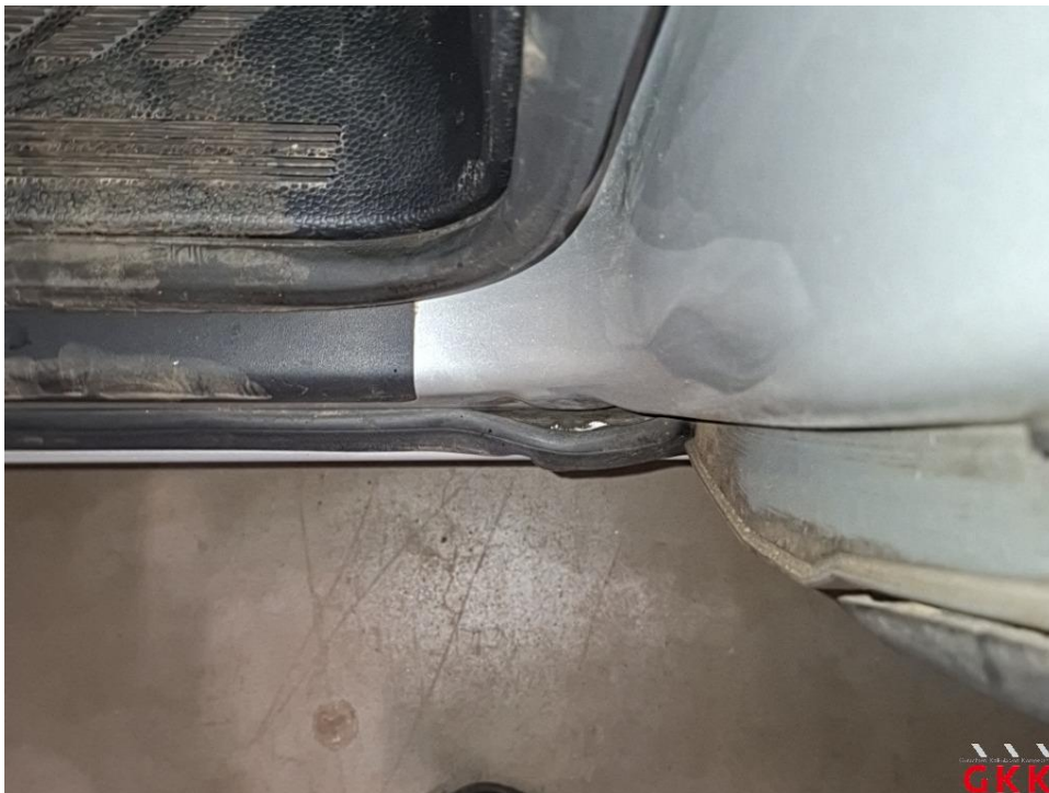
Bild 22 Tür vorne links, Dichtung -Einstieg-, beschädigt, ersetzen
