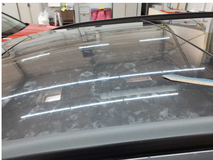
Damage 11: Roof: Roof (Verätzungen) - Paint defect - Paint
