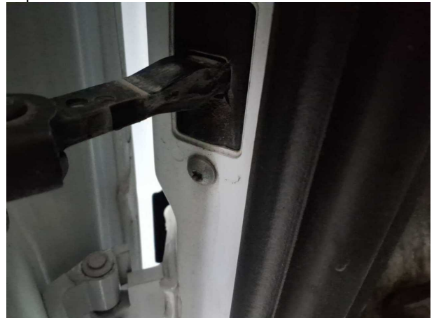
Beschädigung #11: Karosserie: A-Säule links - gebrochen / gerissen - instandsetzen/lackieren (S2)
