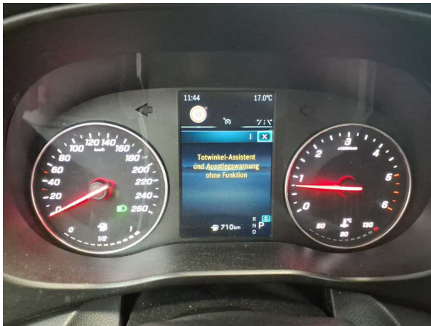
Beschädigung #7: Instrumententafel: Kontrollleuchte - leuchtet - Diagnose durchführen
