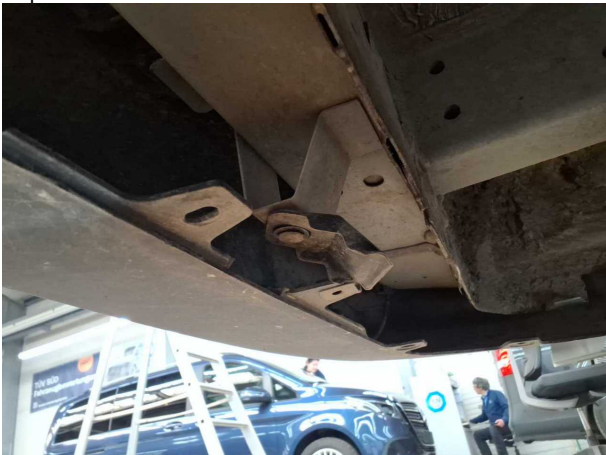
Beschädigung #10: Stossfänger hinten: Stossfänger mit Parktronic - gebrochen / gerissen - erneuern
