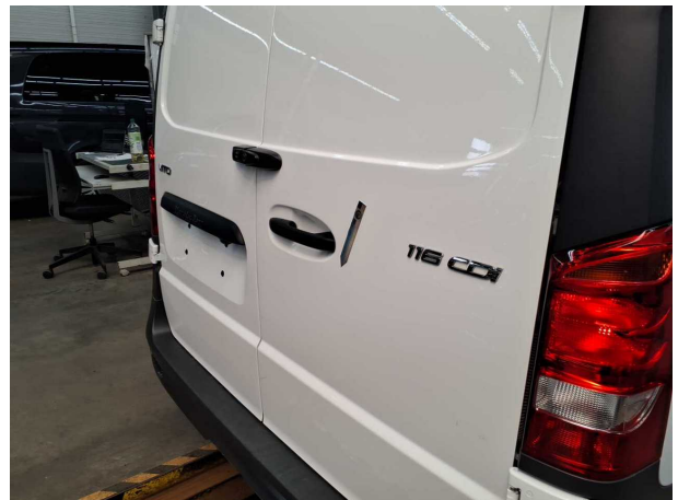
Beschädigung #4: Heckklappe/-tür: Hecktür rechts - Delle(n) - Smart Repair
