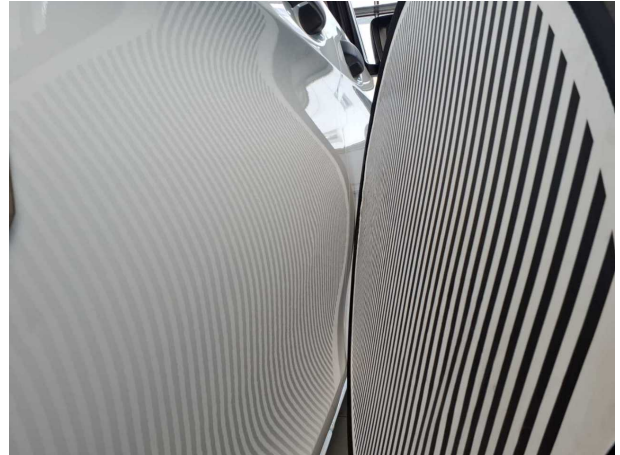
Beschädigung #9: Schiebetür rechts: Schiebetür - Delle(n) - Sm... Repair
