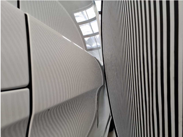
Beschädigung #9: Schiebetür rechts: Schiebetür - Delle(n) - Smart Repair
