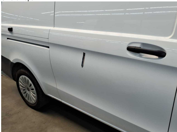
Beschädigung #9: Schiebetür rechts: Schiebetür - Delle(n) - Smart Repair
