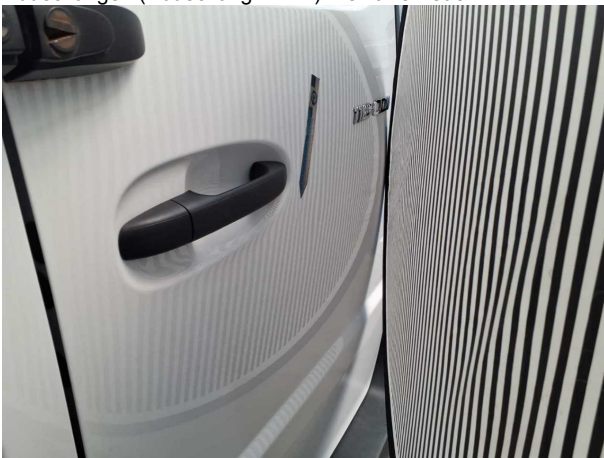
Beschädigung #4: Heckklappe/-tür: Hecktür rechts - Delle(n) - Smart Repair
