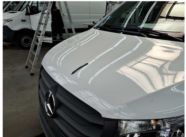
Beschädigung #8: Motorhaube: Motorhaube - Delle / Lackschad... - Smart Repair
