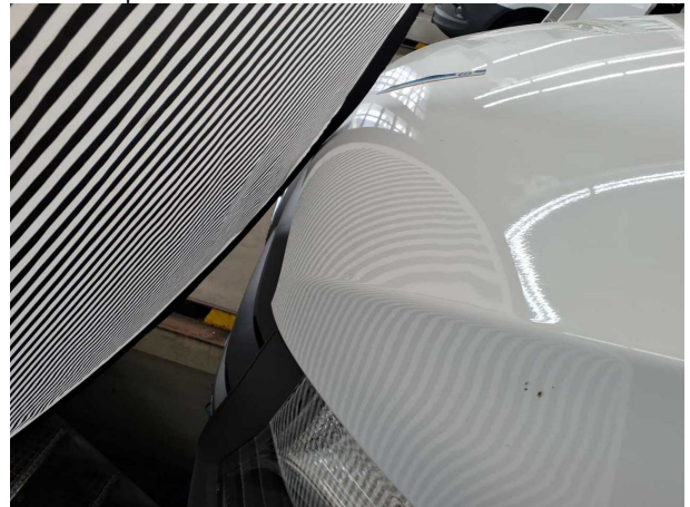
Beschädigung #8: Motorhaube: Motorhaube - Delle / Lackschad... - Smart Repair
