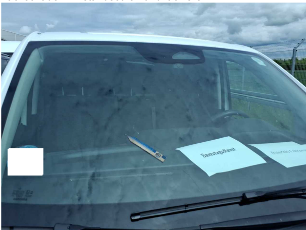
Beschädigung #13: Verglasung: Frontscheibe mit Spurhalteassistent - Steinschlag - erneuern
