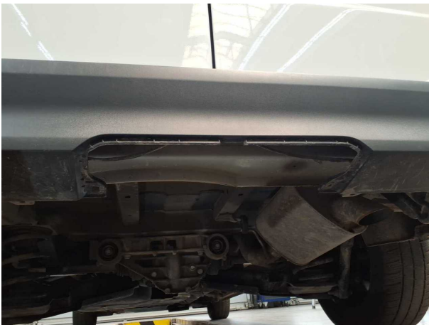
Beschädigung #3: Verkleidungen/Abdeckungen: Verkleidungen/Abdeckungen (Abdeckung AHZV) - fehlt - erneuern
