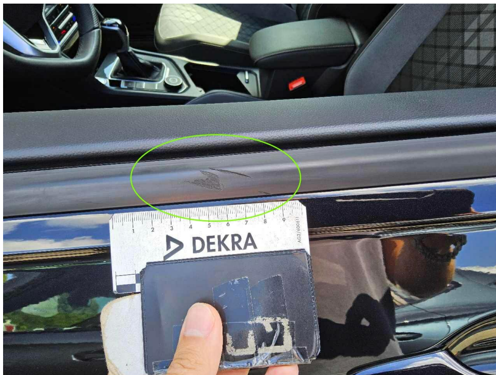
Bild 13 : Fenstetschachtleiste vorne links zerkratzt
