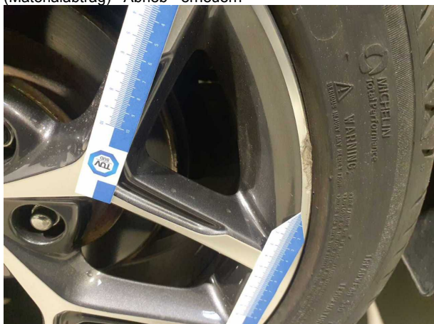
Beschädigung #1: Rad/Reifen: Leichtmetallfelge hinten rechts (Materialabtrag) - Abrieb - erneuern
