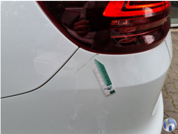
1. Seitenwand - Hinten - Links Kratzer - Smart Repair
