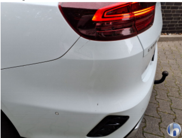
1. Seitenwand - Hinten - Links Kratzer - Smart Repair
