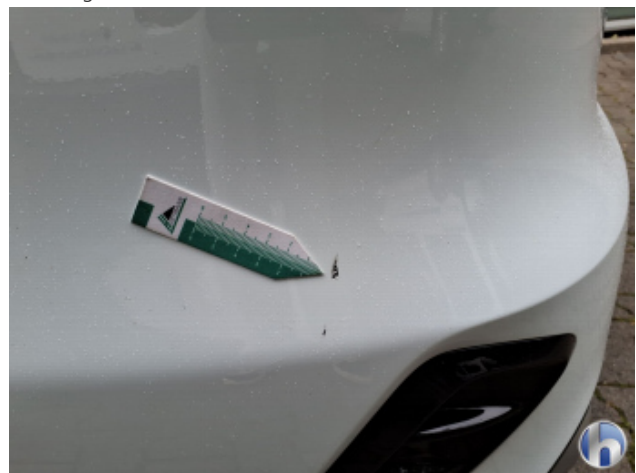
1. Seitenwand - Hinten - Links Kratzer - Smart Repair
