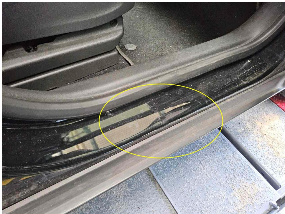
Bild 30 : Einstieg vorne rechts, verschrammt
