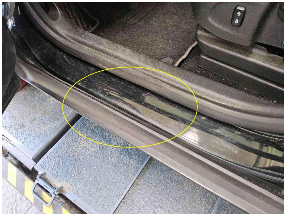
Bild 32 : Einstieg vorne links, verschrammt
