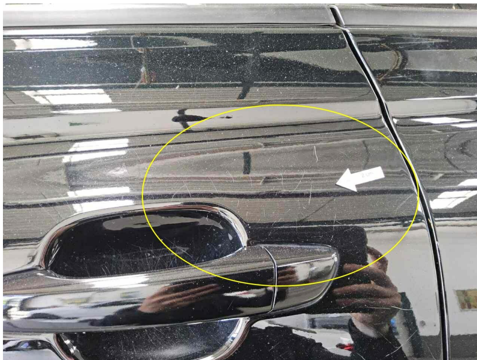
Bild 25 : Tür hinten links Lackierung, verschrammt, polieren
