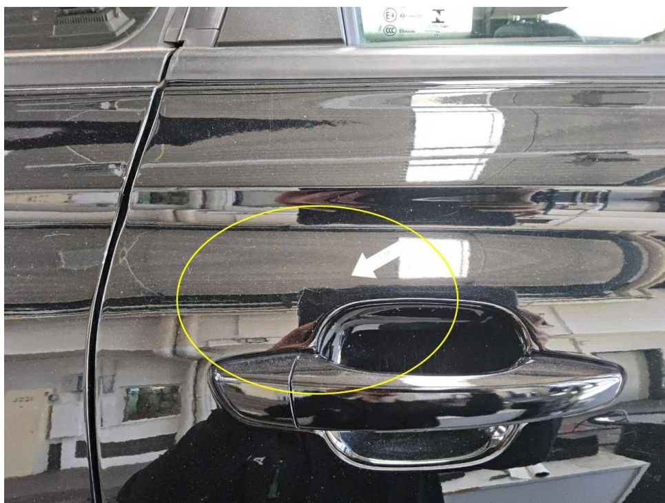
Bild 24 : Tür hinten rechts Lackierung, verschrammt, polieren
