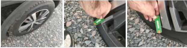
Door FL, Scratch(es), Paint
