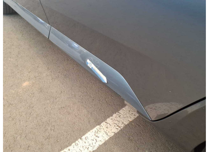
Damage 5: Door - rear left side: Door (Blende tür unten) - Scratched - Replace
