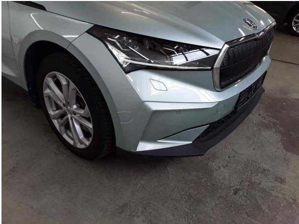
Beschädigung #1: Stossfänger vorn: Stossfänger vorn - verkratzt / verschürft - Smart Repair
