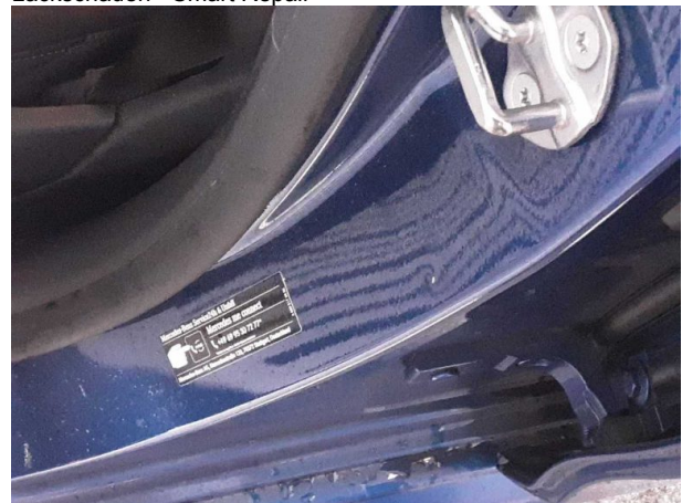
Beschädigung 4: Schweller links: Einstieg - Delle / Lackschaden - Smart Repair
