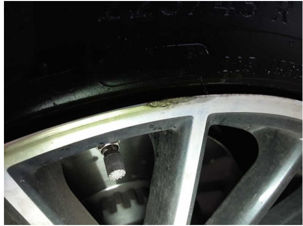
Gebrauchsspur 2: Rad/Reifen: Leichtmetallfelge vorn rechts (Materialabtrag) - verkratzt / verschürft - kein Abzug
