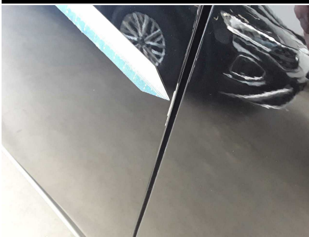
Beschädigung #3: Tür vorn rechts: Türkante - verkratzt / verschü... - Smart Repair
