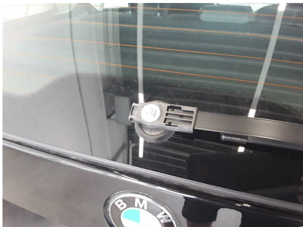
Beschädigung #1: Scheibenreinigung: Scheibenwischerarm hint... (Abdeckung) - fehlt - erneuern
