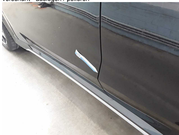
Beschädigung #2: Tür vorn links: Türkante - verkratzt / verschürft - auslegen / polieren
