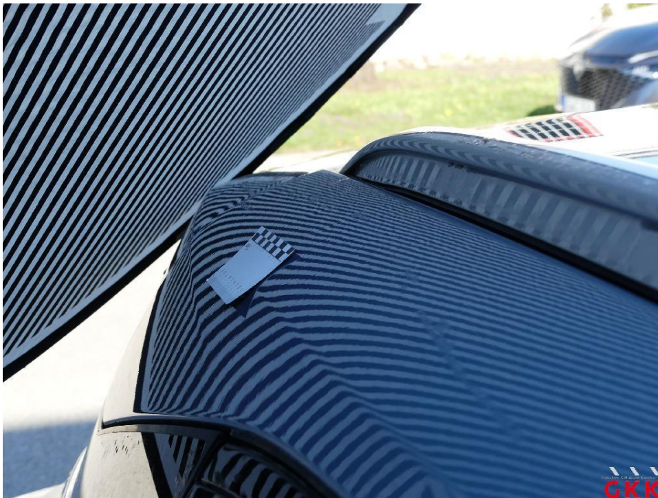
Bild 16 Holm rechts Fahrzeug, Hagelschaden, instand setzen
