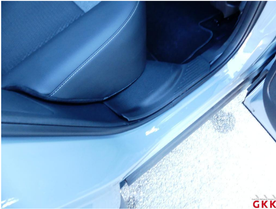
Bild 31 Tür hinten rechts, Einstiegsleiste, lose, instand setzen
