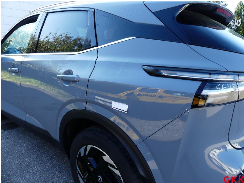
Bild 23 Seitenwand links, verkratzt, polieren
