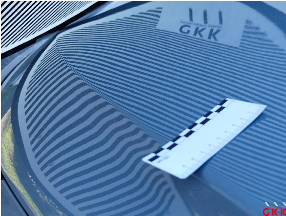
Bild 15 Frontdeckel Fahrzeug, Hagelschaden, instand setzen
