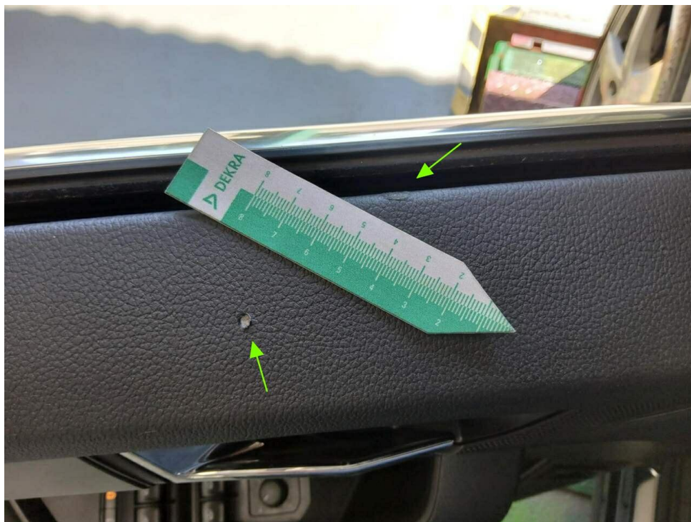
Bild 14 : Verkleidung Tür vorne links, Brandfleck, smart repair
