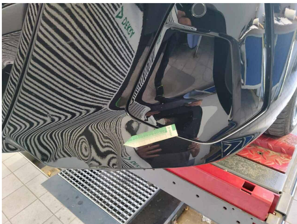
Bild 14 : Verkleidung Stoßfänger vorn links und rechts verschrammt und plastisch verformt
