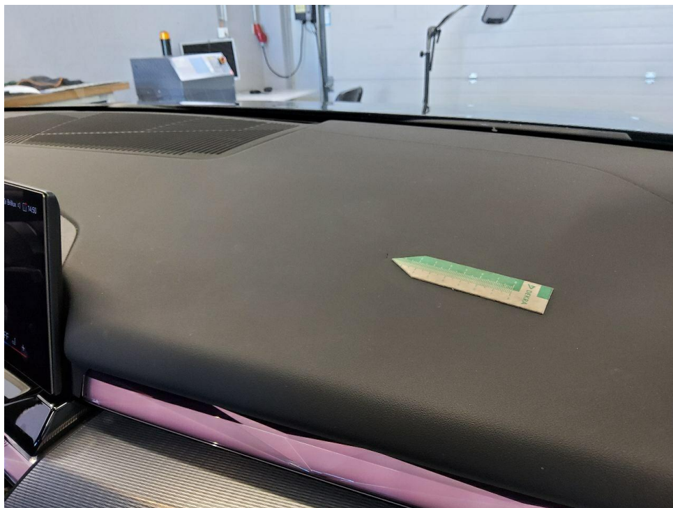
Bild 29 : Instrumentenverkleidung rechts beschädigt
