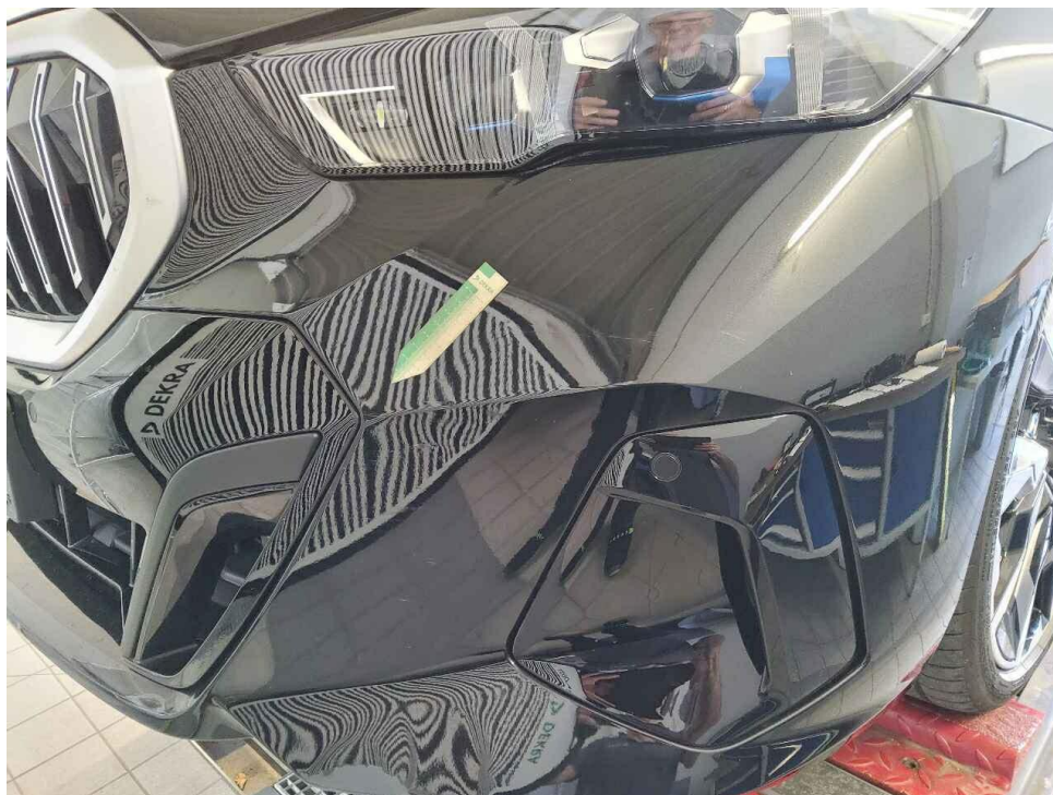
Bild 13 : Verkleidung Stoßfänger vorn links und rechts verschrammt und plastisch verformt
