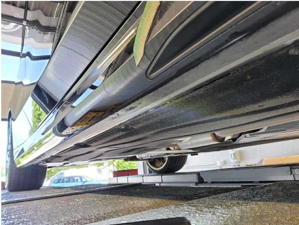
Bild 31 : Schwellerverkleidung rechts verkratzt
