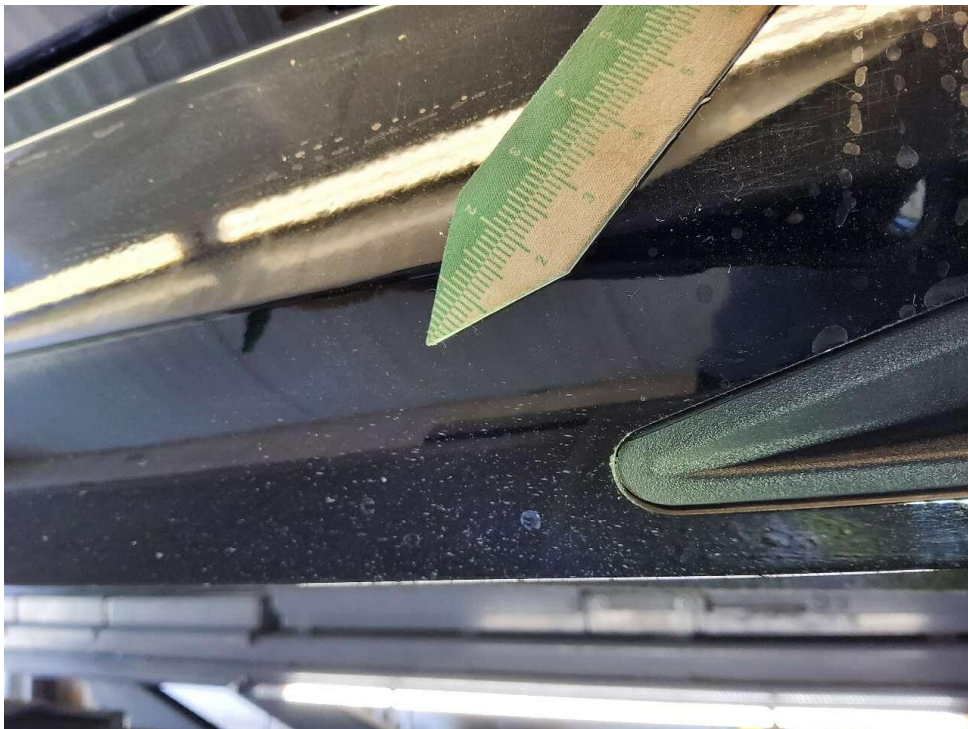
Bild 32 : Schwellerverkleidung rechts verkratzt
