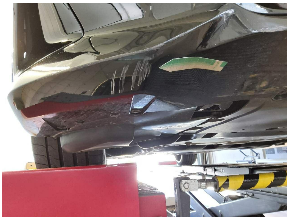
Bild 18 : Verkleidung Stoßfänger vorn links und rechts verschrammt und plastisch verformt
