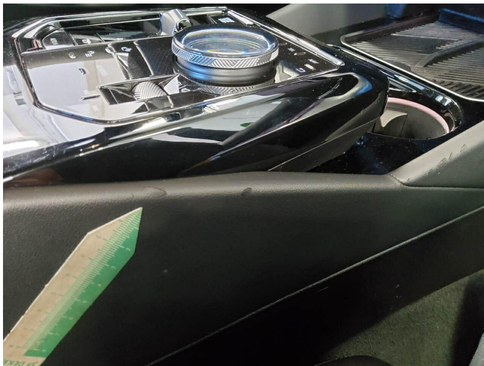
Bild 28 : Mittelkonsole mehrfach beschädigt
