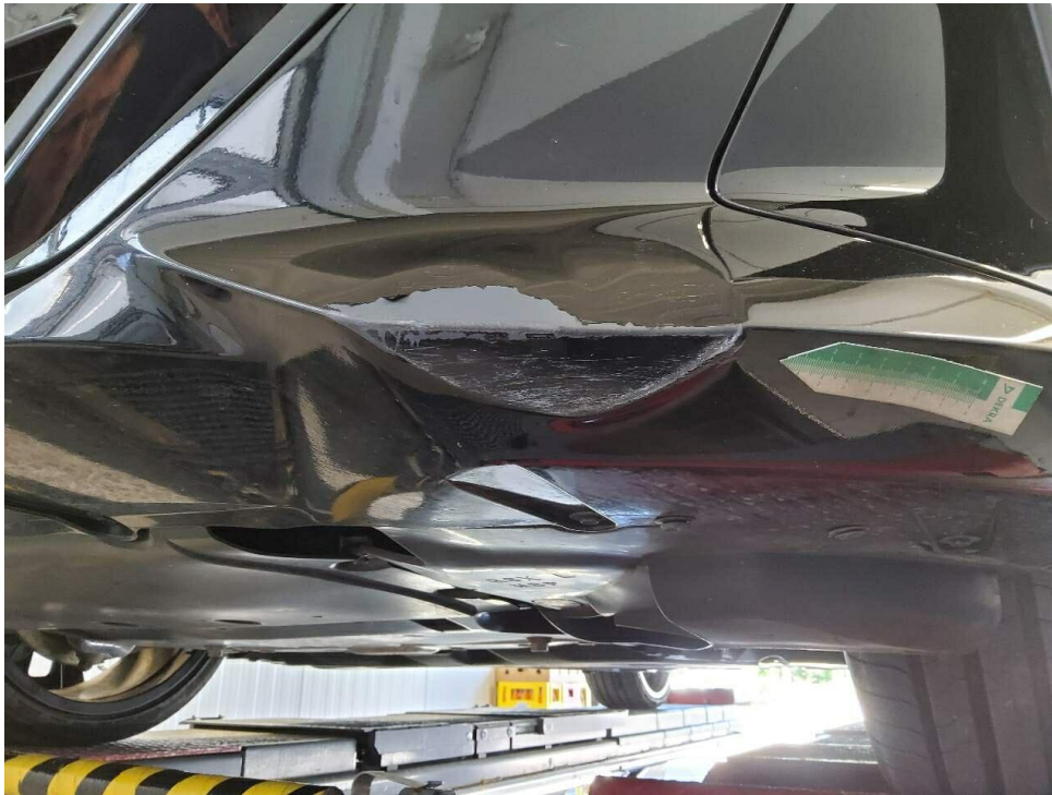
Bild 15 : Verkleidung Stoßfänger vorn links und rechts verschrammt und plastisch verformt
