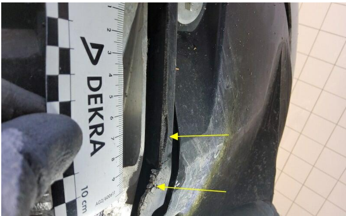
Bild 16 : Akt. Schaden Bereich Unterboden: Dämmung unten, Radhausverkleidung vorne links und Anschlussträger verschrammt und deformiert
