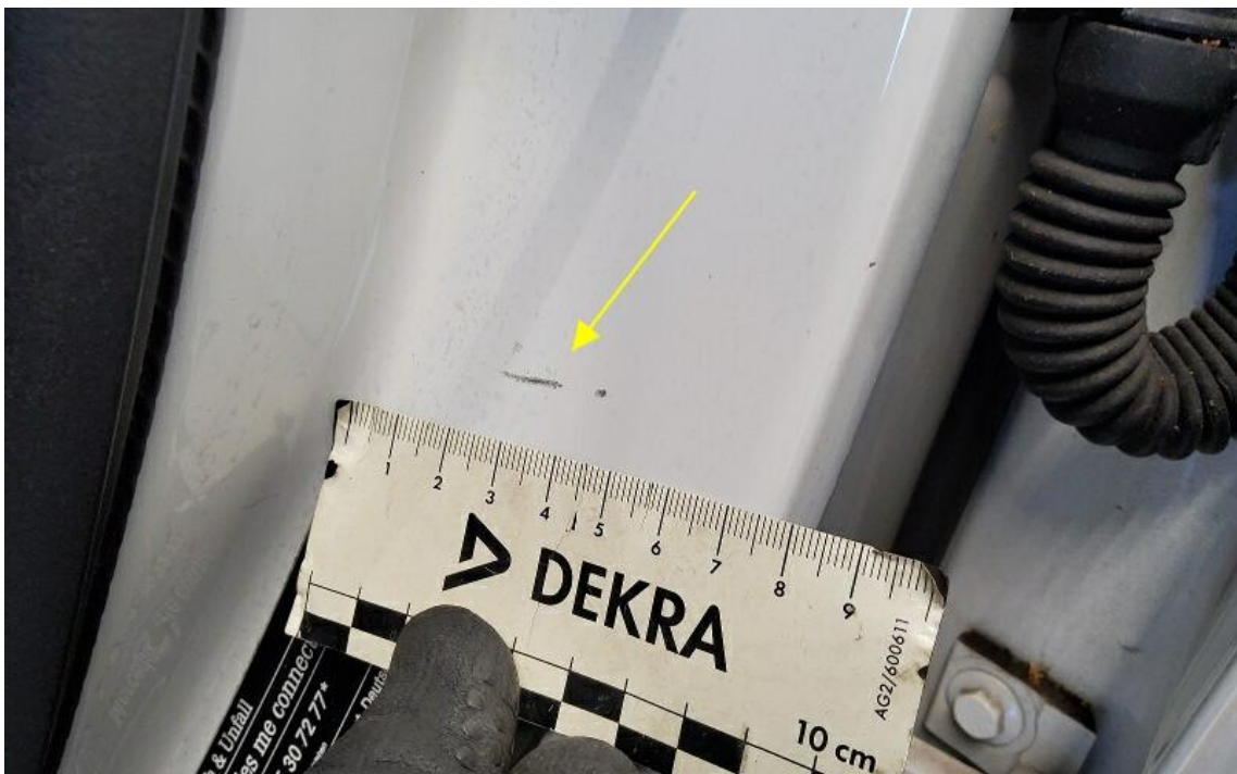
Bild 24 : Tür vorne links Einstieg, zerkratzt, lackieren mit Lackaufbau
