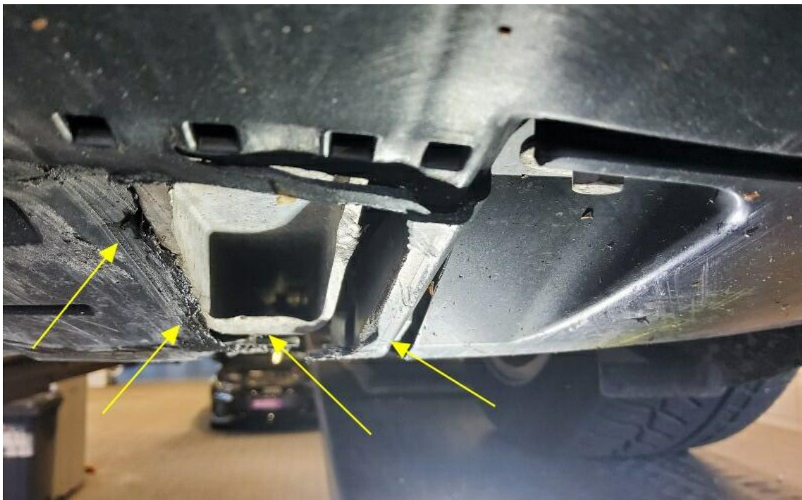
Bild 18 : Akt. Schaden Bereich Unterboden: Dämmung unten, Radhausverkleidung vorne links und Anschlussträger verschrammt und deformiert
