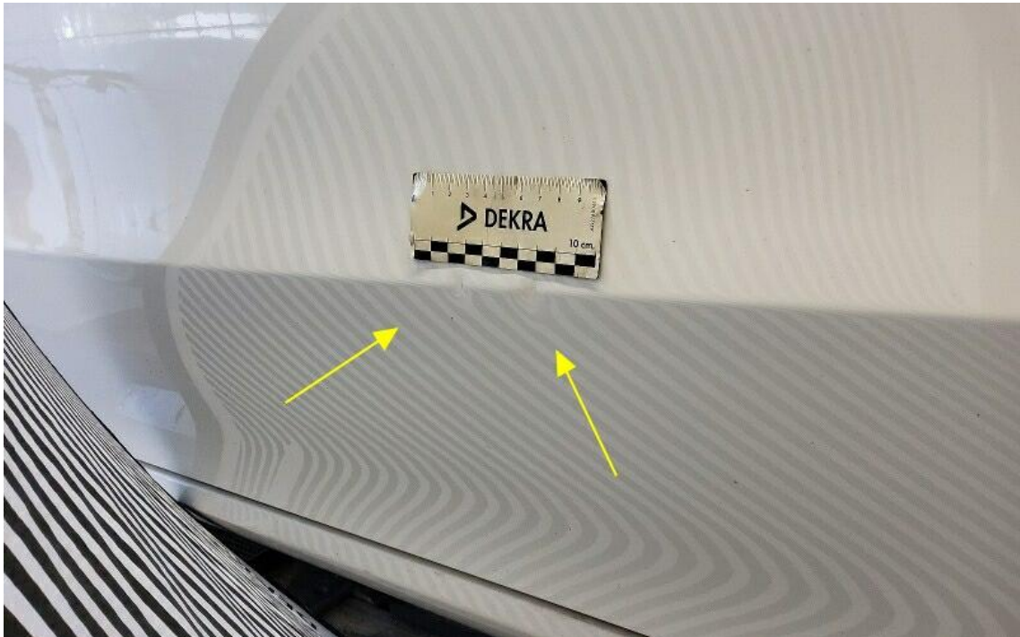
Bild 29 : Tür vorne links, eingedellt, instandsetzen und lackieren mit Lackaufbau
