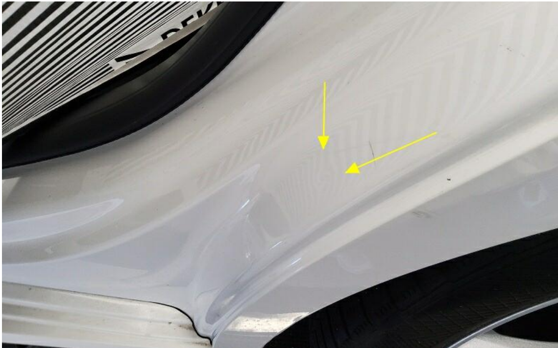
Bild 27 : Tür hinten links Einstieg, eingedellt, instandsetzen und lackieren mit Lackaufbau
