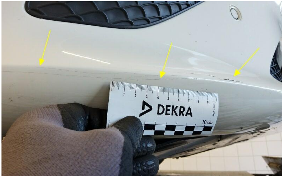
Bild 19 : Stoßfänger vorne, eingedellt, instandsetzen und lackieren mit Lackaufbau
