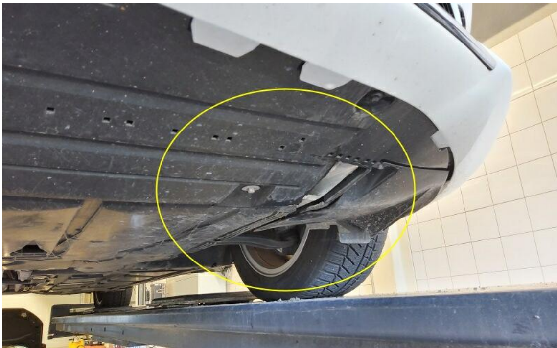
Bild 14 : Akt. Schaden Bereich Unterboden: Dämmung unten, Radhausverkleidung vorne links und Anschlussträger verschrammt und deformiert
