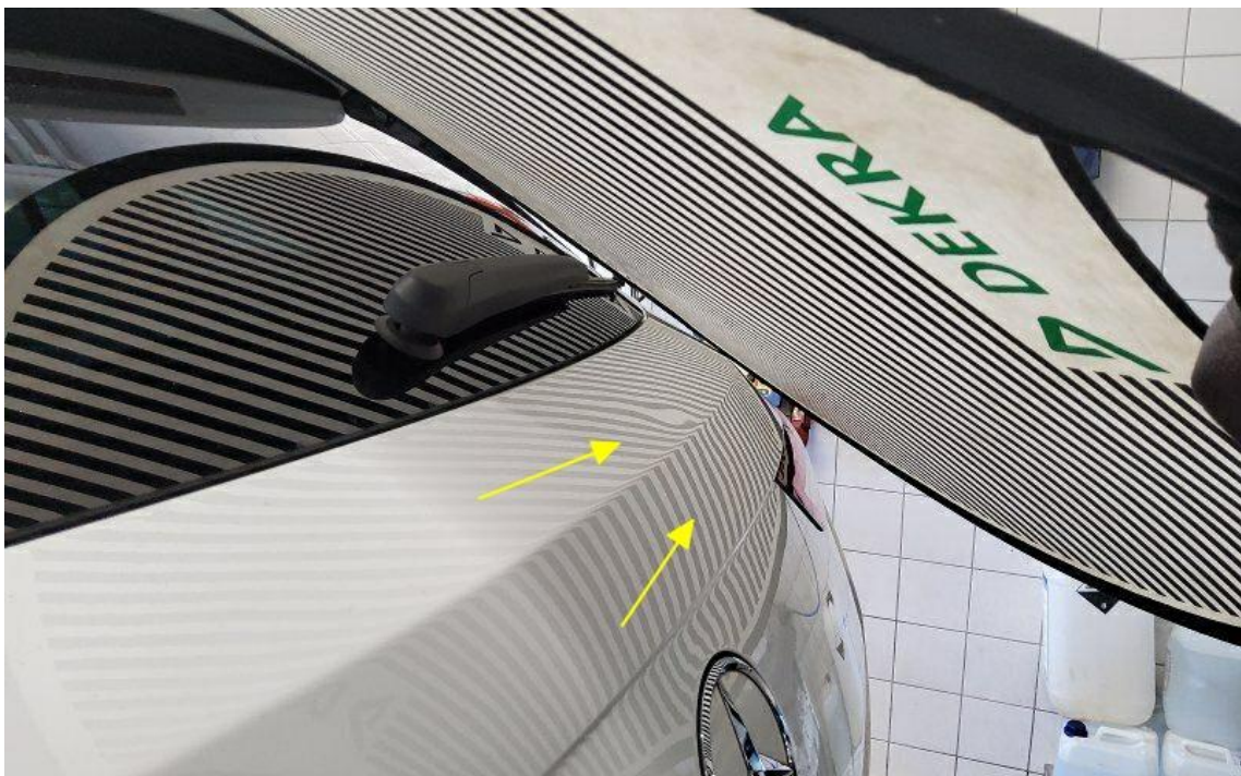
Bild 30 : Heckklappe, eingedellt, drücken
