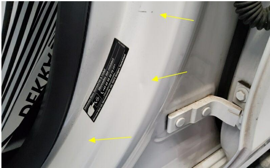
Bild 25 : Tür vorne links Einstieg, zerkratzt, lackieren mit Lackaufbau
