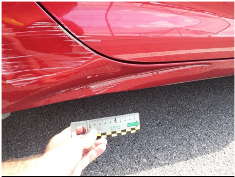
Sottoporta / Destro / Ammaccato vernice incisa
