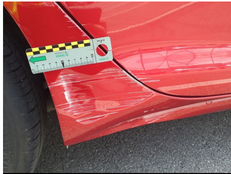
Sottoporta / Destro / Ammaccato vernice incisa
