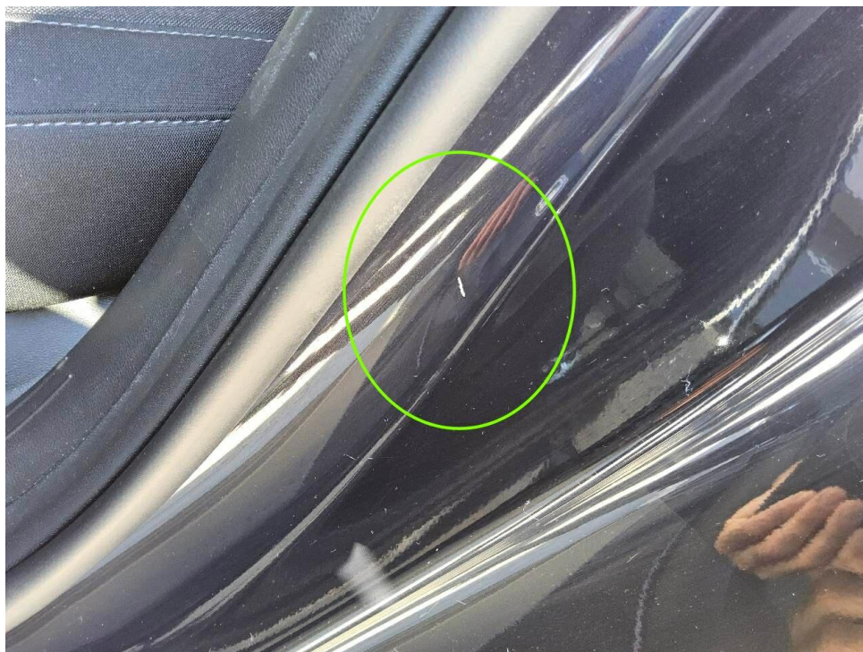
Bild 9 : Tür hinten links, Einstieg verschrammt
