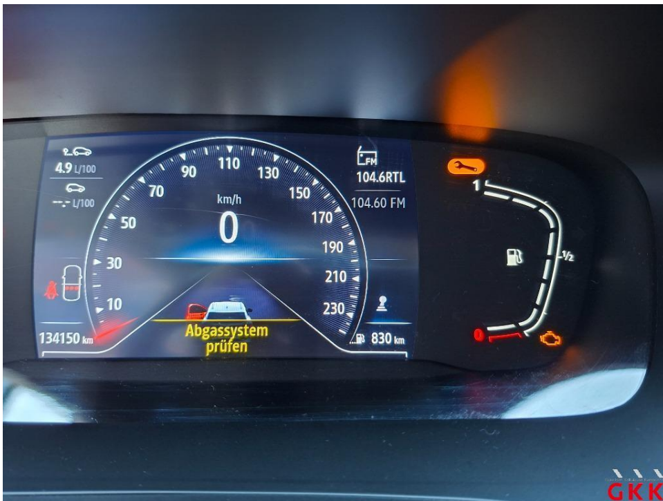
Bild 32. Abgassystem -, Fehlerspeicher, aktiv, auslesen / prüfen
