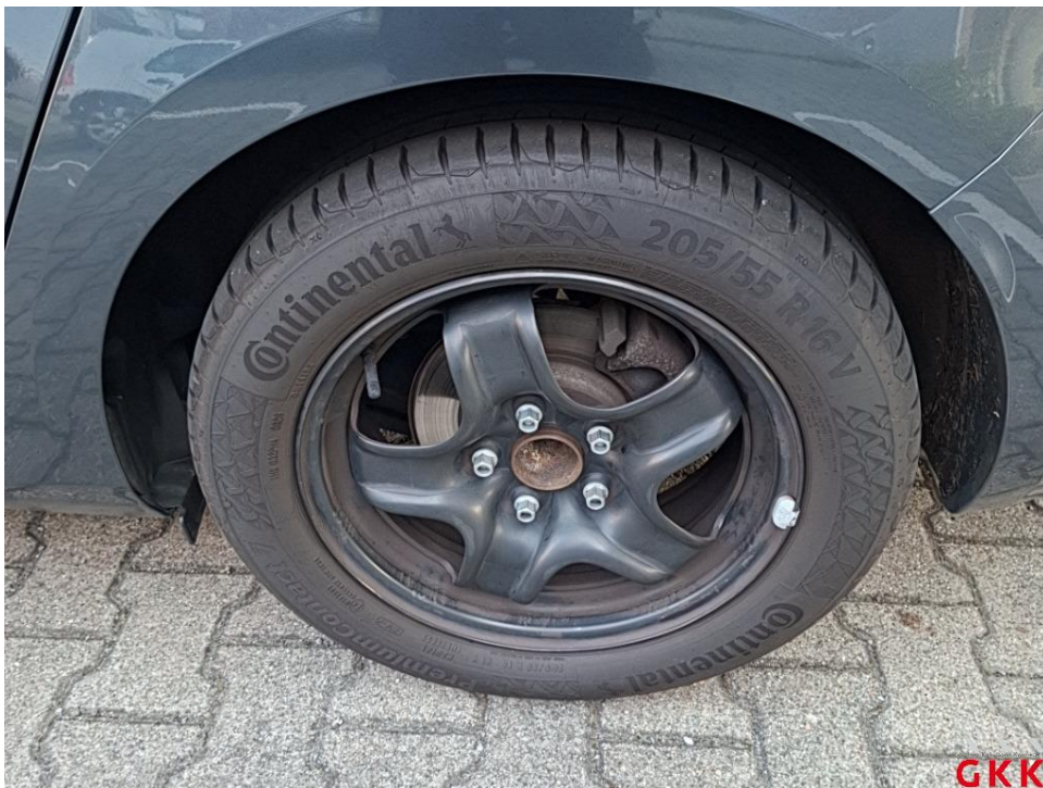
Bild 14. Radkappe(n), hinten links, fehlt, ersetzen
