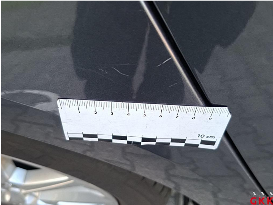
Bild 23. Seitenwand rechts, verkratzt, auslegen, schleifen, polieren
