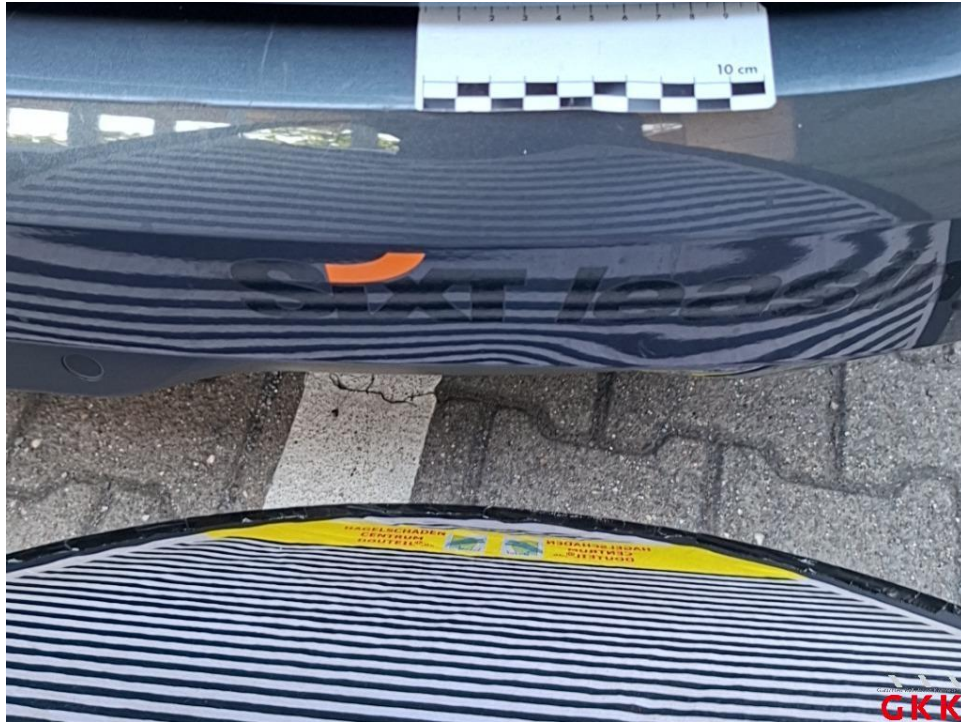
Bild 21. Stoßfänger hinten, Verkleidung -lackiert-, beschädigt, instand setzen - lackieren
