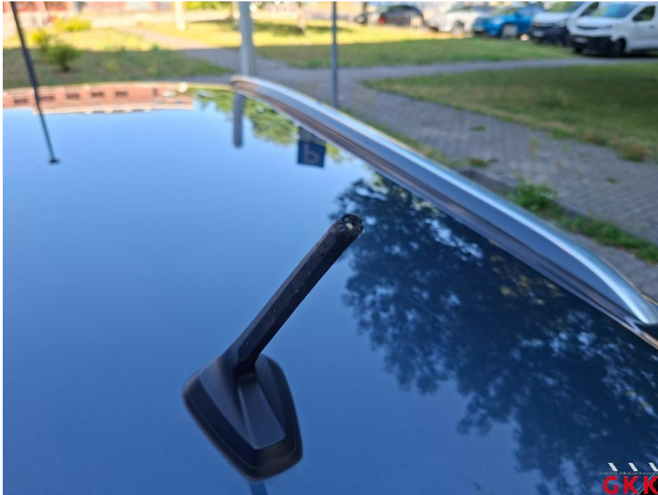
Bild 17. Antenne, Stab, beschädigt, ersetzen
