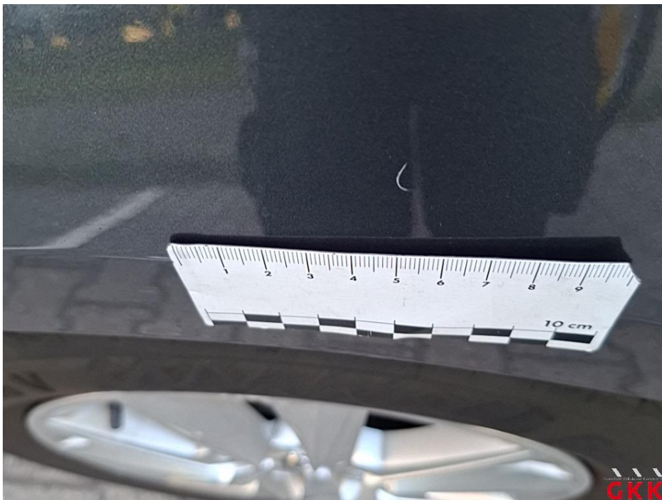
Bild 24. Seitenwand rechts, verkratzt, auslegen, schleifen, polieren
