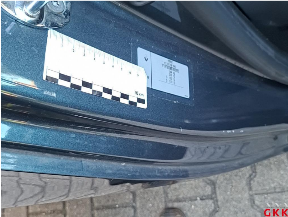
Bild 25. Tür hinten rechts, Einstieg, verkratzt, auslegen, schleifen, polieren
