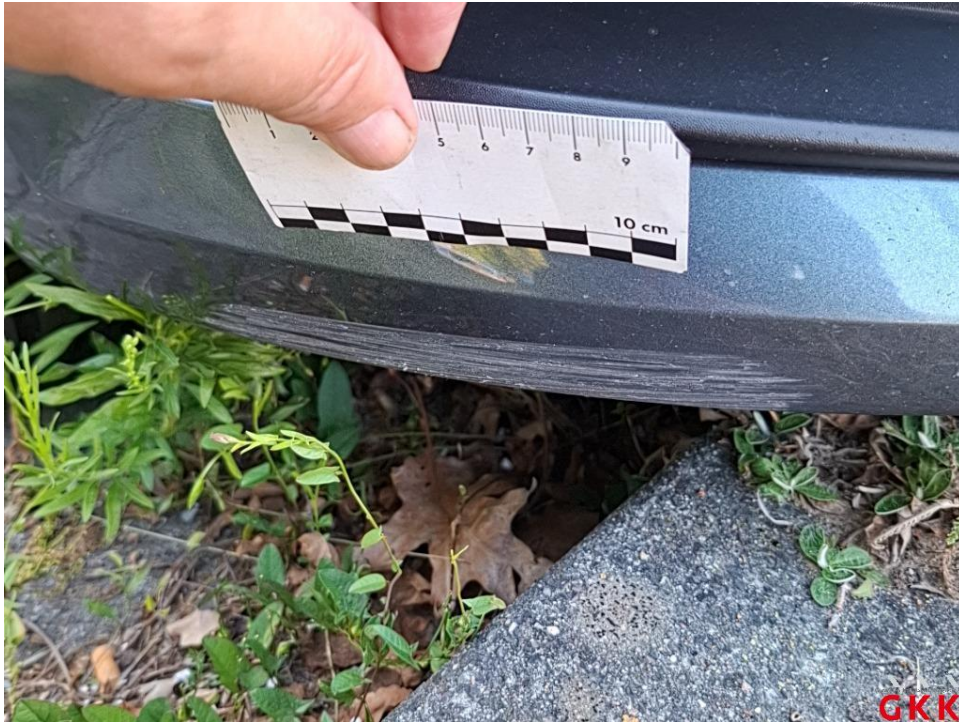
Bild 31. Stoßfänger vorne, Verkleidung -lackiert-, verkratzt, Smartrepair
