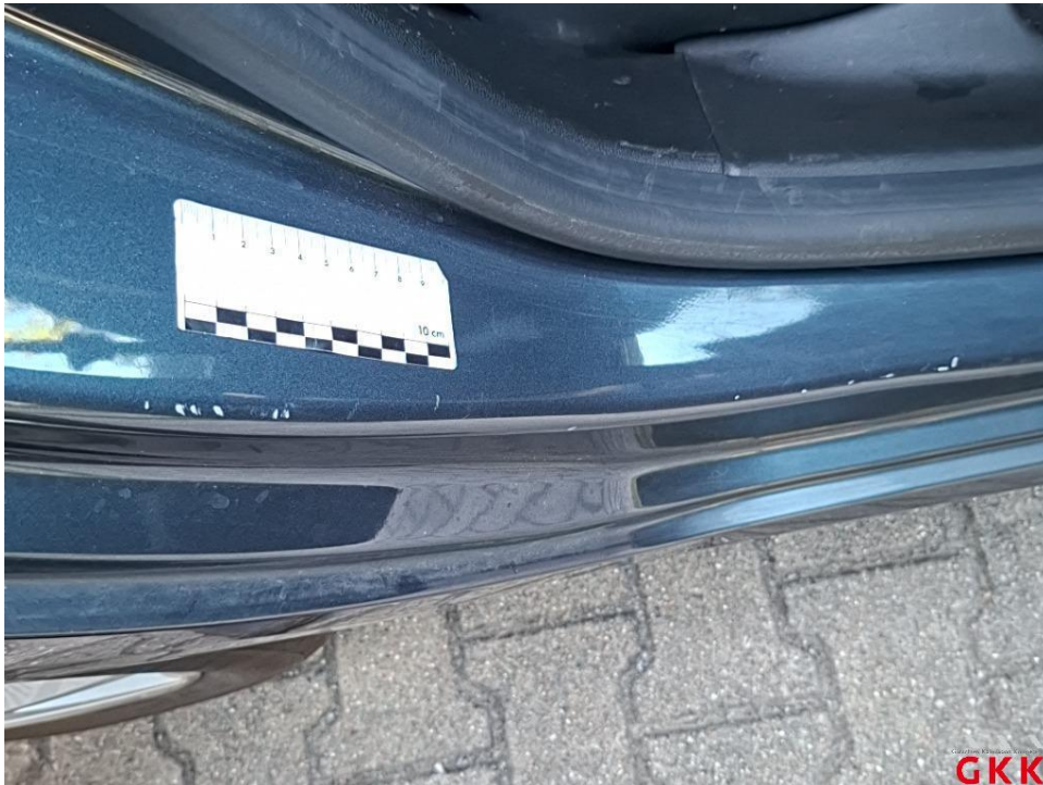
Bild 26. Tür hinten rechts, Einstieg, verkratzt, auslegen, schleifen, polieren
