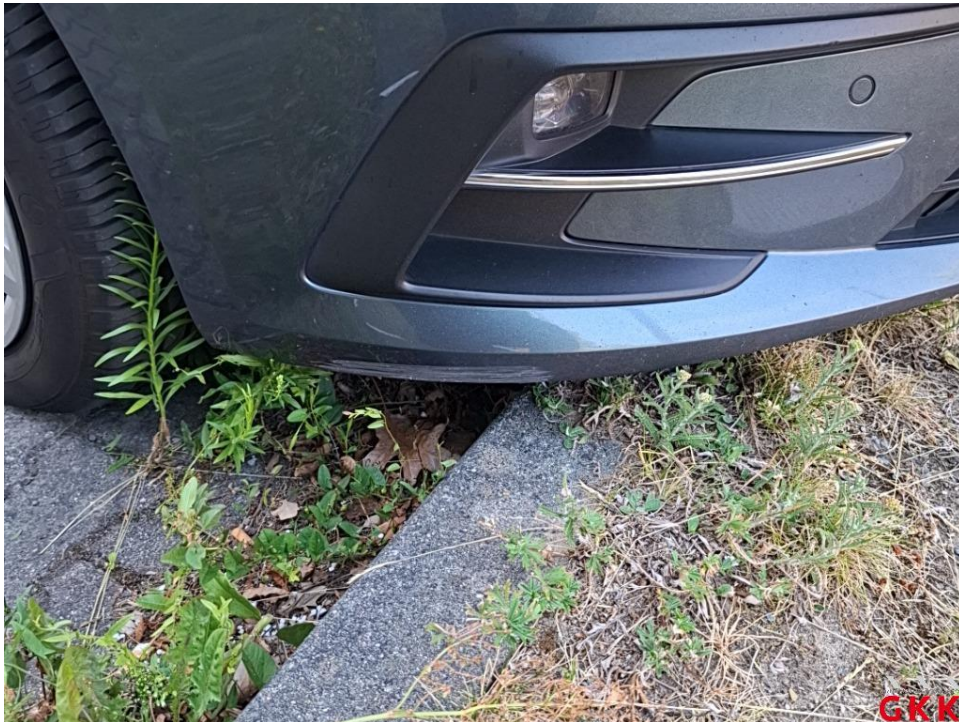
Bild 30. Stoßfänger vorne, Verkleidung -lackiert-, verkratzt, Smartrepair
