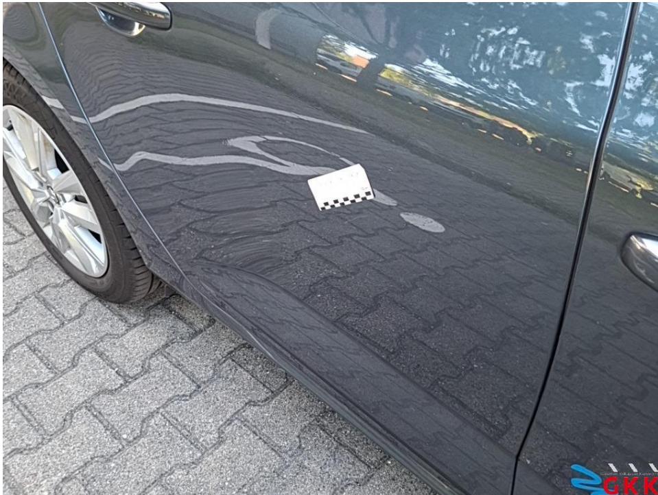
Bild 28. Tür hinten rechts, verkratzt, auslegen, schleifen, polieren
