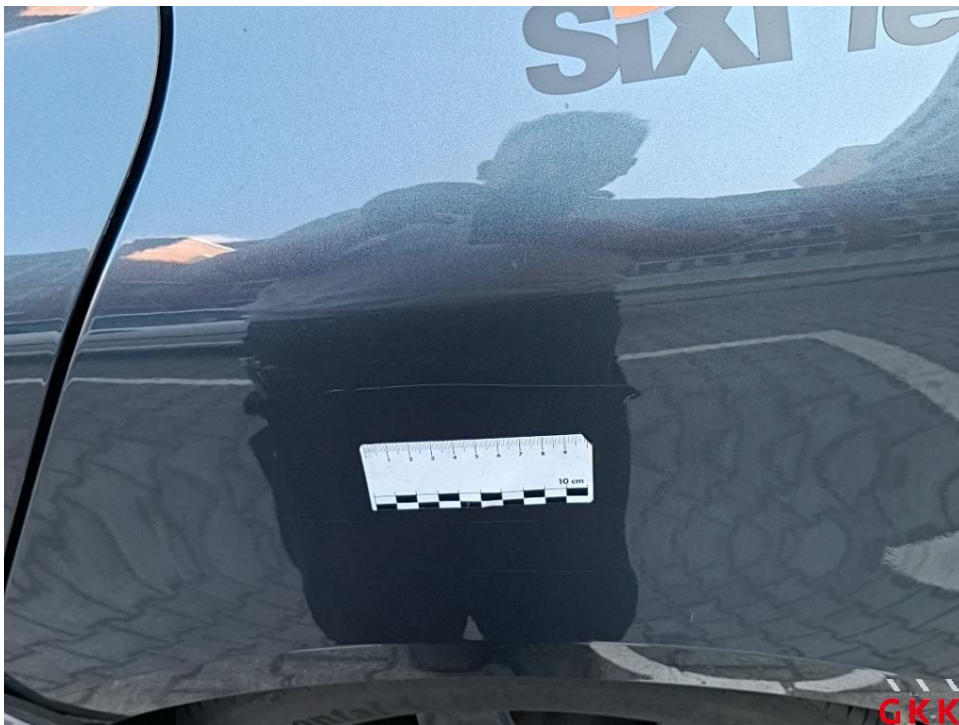
Bild 18. Seitenwand links, verkratzt, auslegen, schleifen, polieren
