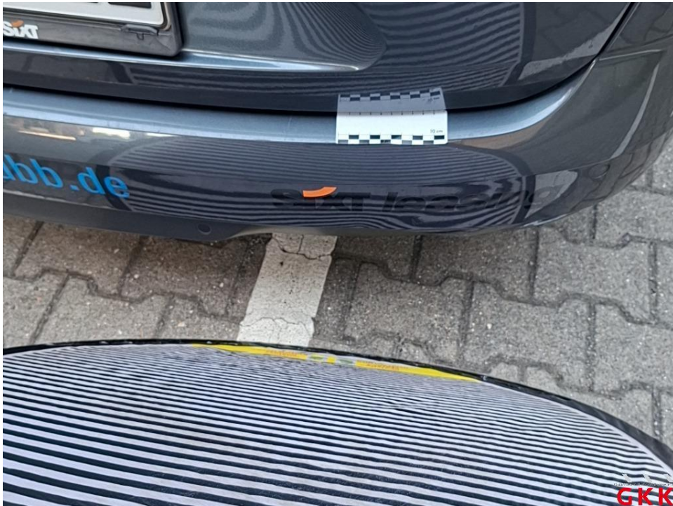
Bild 20. Stoßfänger hinten, Verkleidung -lackiert-, beschädigt, instand setzen - lackieren
