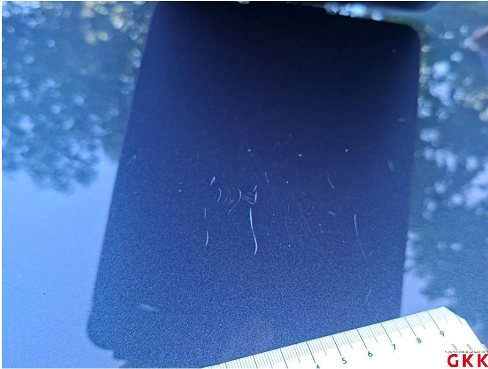
Bild 15. Dach, verkratzt, auslegen, schleifen, polieren
