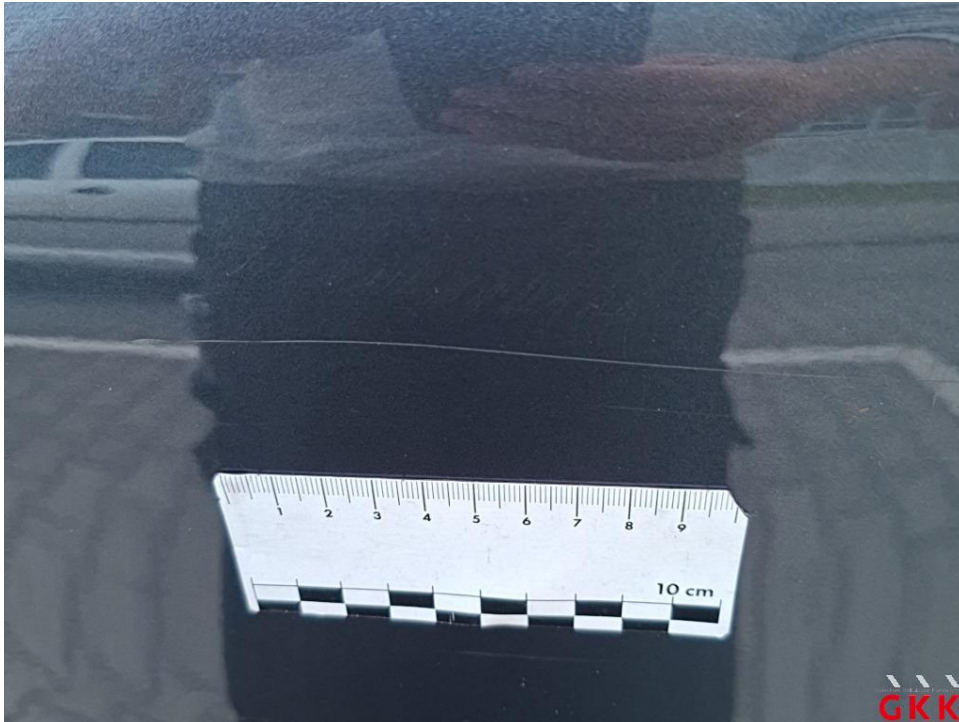
Bild 19. Seitenwand links, verkratzt, auslegen, schleifen, polieren
