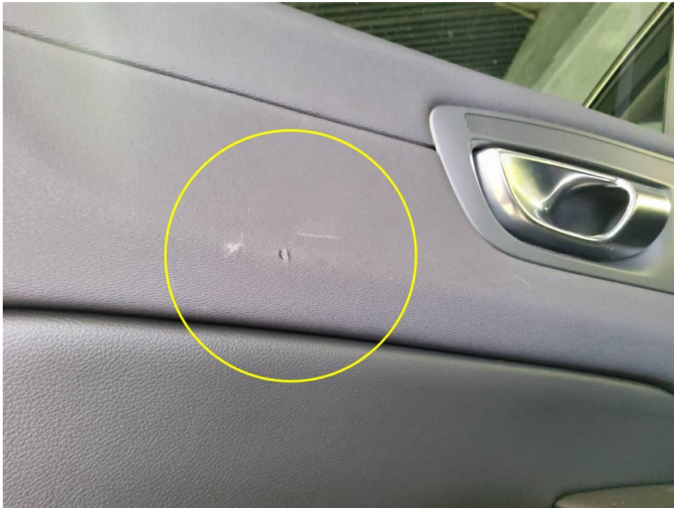
Bild 15 : Türverkleidung hinten links beschädigt
