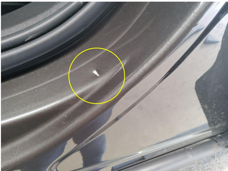
Bild 16 : Einstieg vorne links verschrammt und eingedellt
