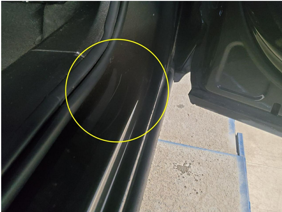
Bild 13 : Einstieg hinten rechts verschrammt
