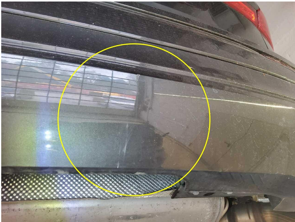
Bild 18 : Heckschürze lackierung verschrammt
