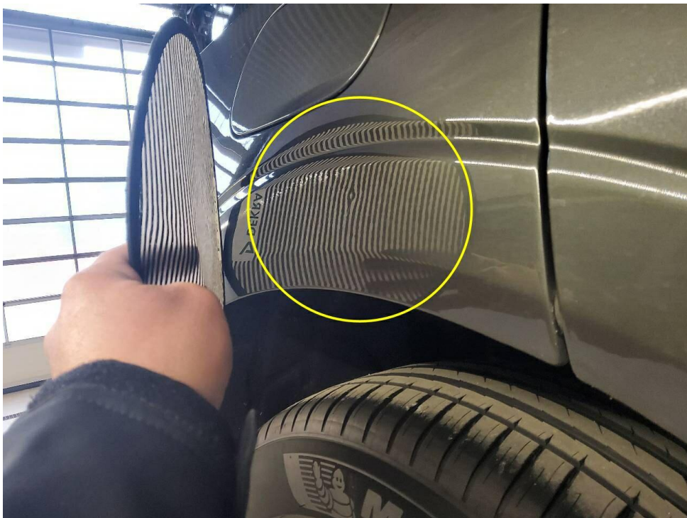
Bild 14 : Seitenwand rechts eingedellt
