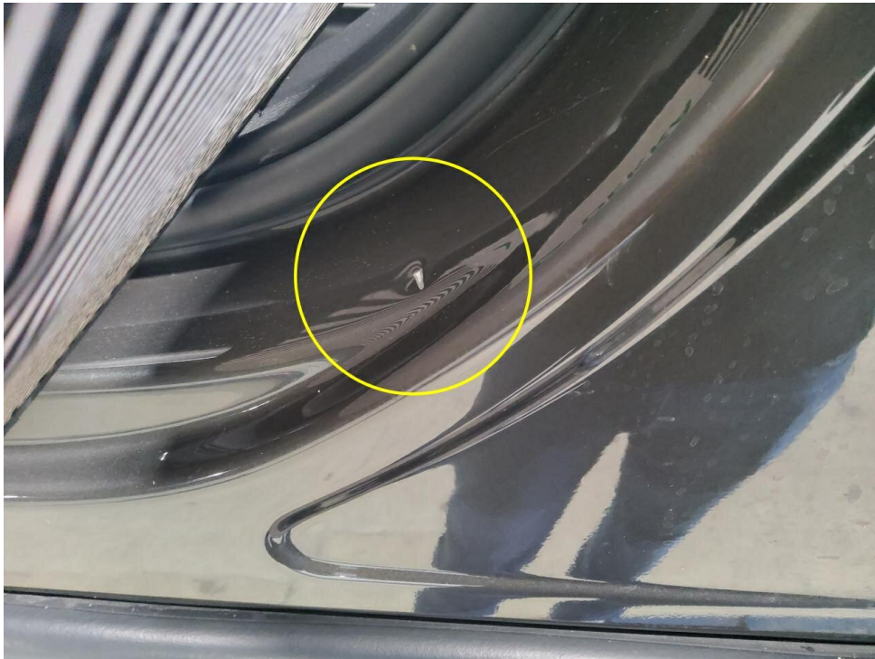
Bild 17 : Einstieg vorne links verschrammt und eingedellt
