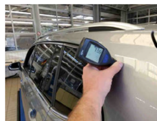
Lackstärke Seitenwand hinten links
