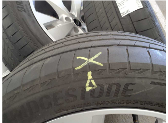
Damage 9: 2nd wheel set: 2 tyres (Flanken abgefahren) - Worn - Replace
