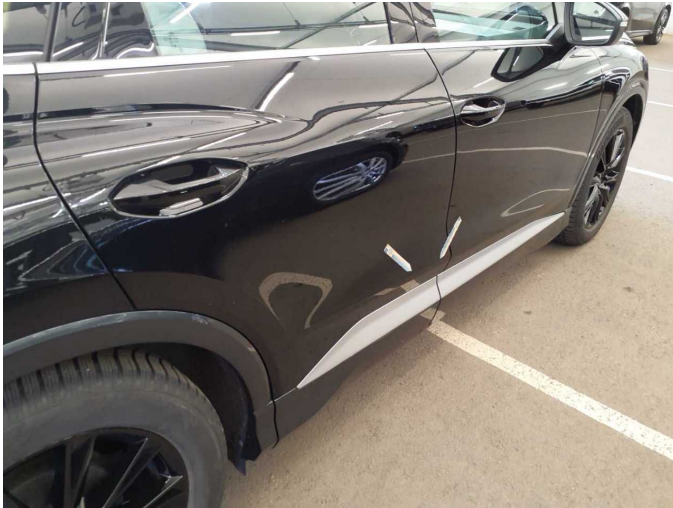
Damage 6: Door - rear right side: Door (drücken und auslegen/ polieren) - Dent / paintcoat damage - Smart repair
