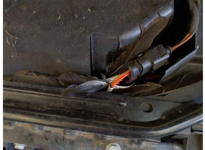
Damage 1: Engine: Engine (Folgekosten möglich) - Soiled - Clean
