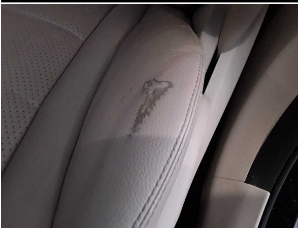
Beschädigung #5: Sitz vorn: Sitzbezug links - porös / rissig - erneuern
