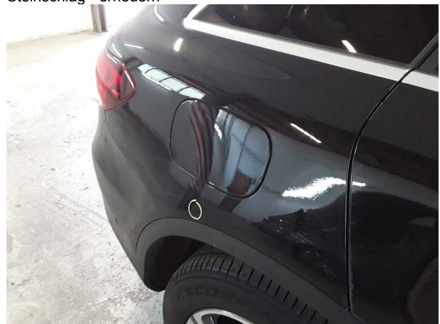
Beschädigung #8: Seitenwand rechts: Seitenwand - Delle(n) - instandsetzen und lackieren
