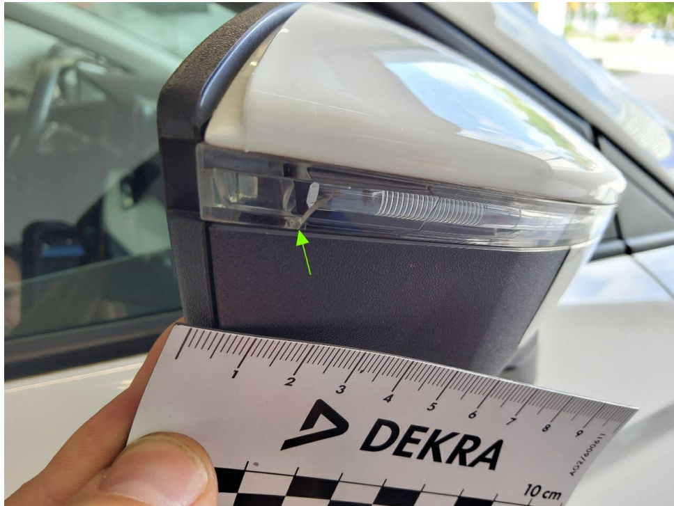
Bild 23 : Außenspiegel rechts, Blinkleuchte gebrochen
