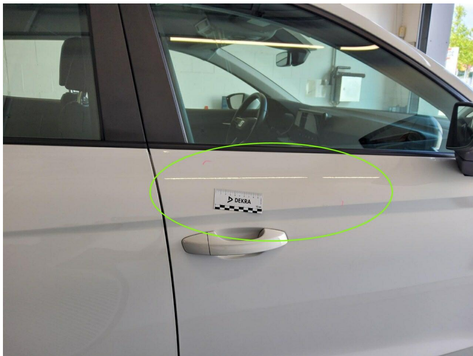
Bild 24 : Tür vorne rechts Lackierung oberhalb, zerkratzt, lackieren mit Lackaufbau
