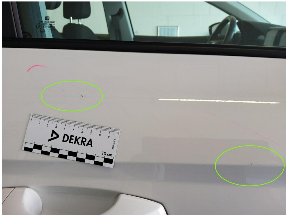
Bild 25 : Tür vorne rechts Lackierung oberhalb, zerkratzt, lackieren mit Lackaufbau
