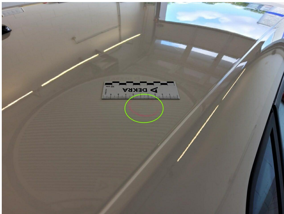
Bild 21 : Dach, mehrfach eingedellt, Gebrauchsspur
