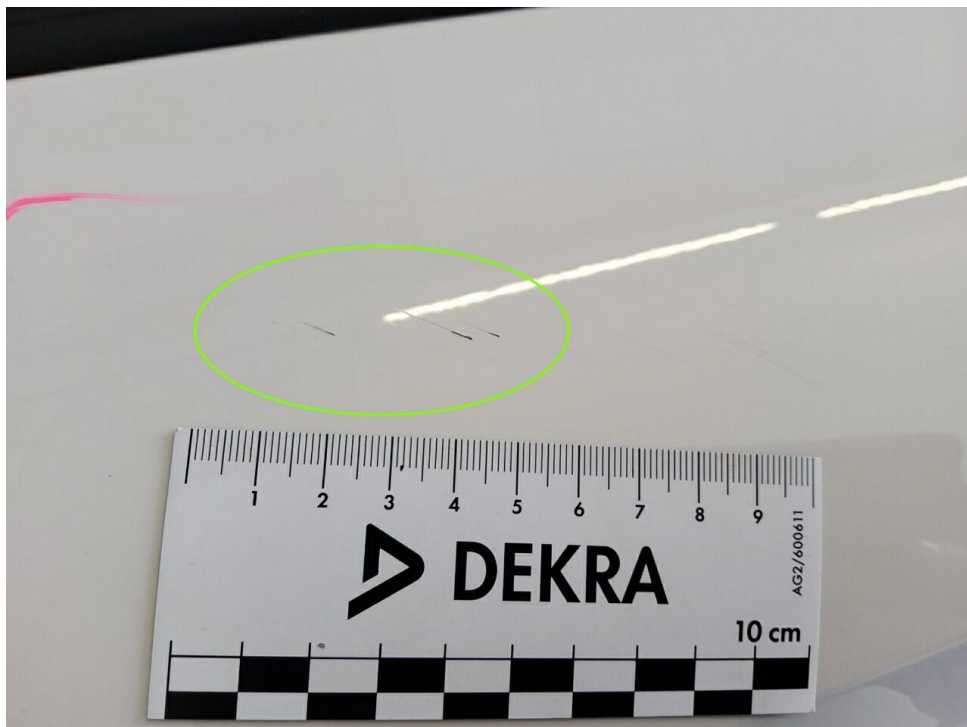
Bild 26 : Tür vorne rechts Lackierung oberhalb, zerkratzt, lackieren mit Lackaufbau
