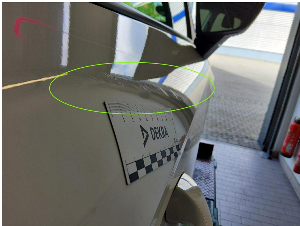
Bild 27 : Tür vorne rechts Lackierung oberhalb, zerkratzt, lackieren mit Lackaufbau
