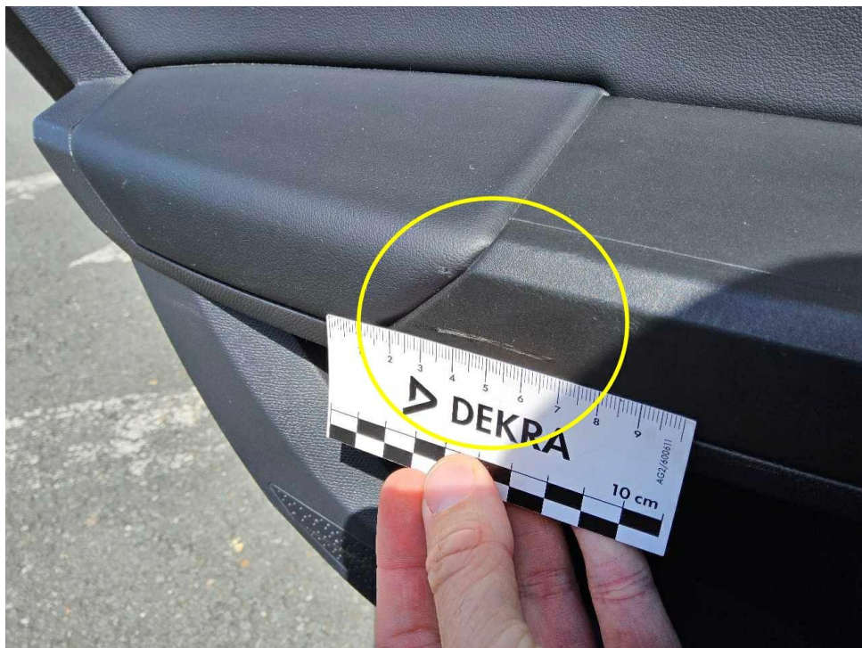
Bild 49 : Türverkleidung hinten links mehrfach verkratzt
