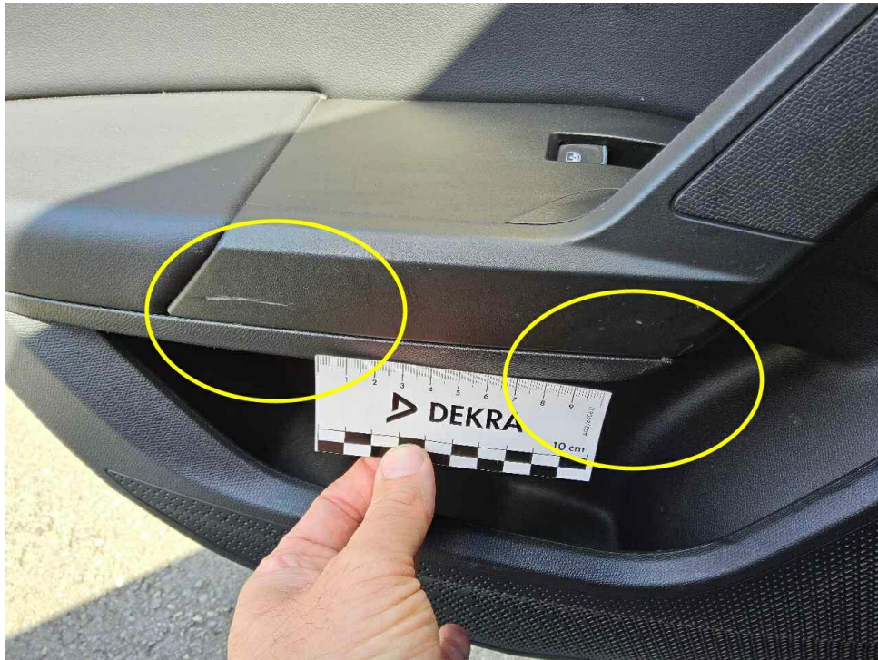
Bild 48 : Türverkleidung hinten links mehrfach verkratzt
