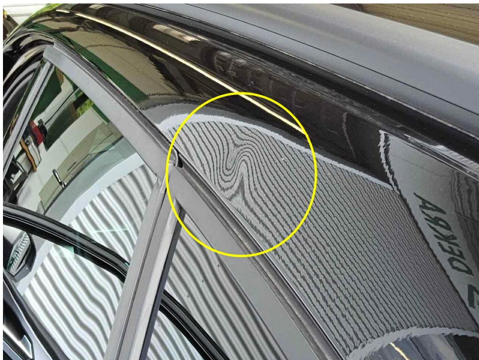
Bild 14 : Dachrahmen links, eingedellt, instandsetzen und lackieren mit Lackaufbau
