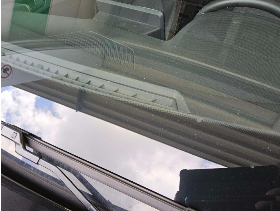
Bild 66 : Windschutzscheibe, Steinschlag, Gebrauchsspur
