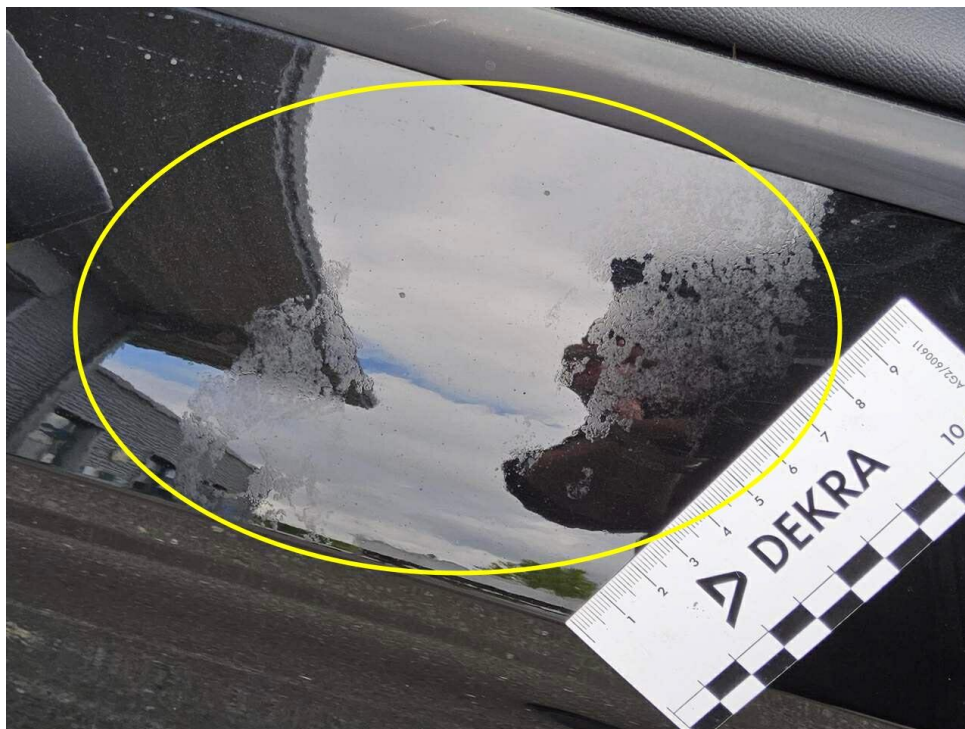
Bild 29 : Tür vorne links, eingedellt, instandsetzen und lackieren mit Lackaufbau
