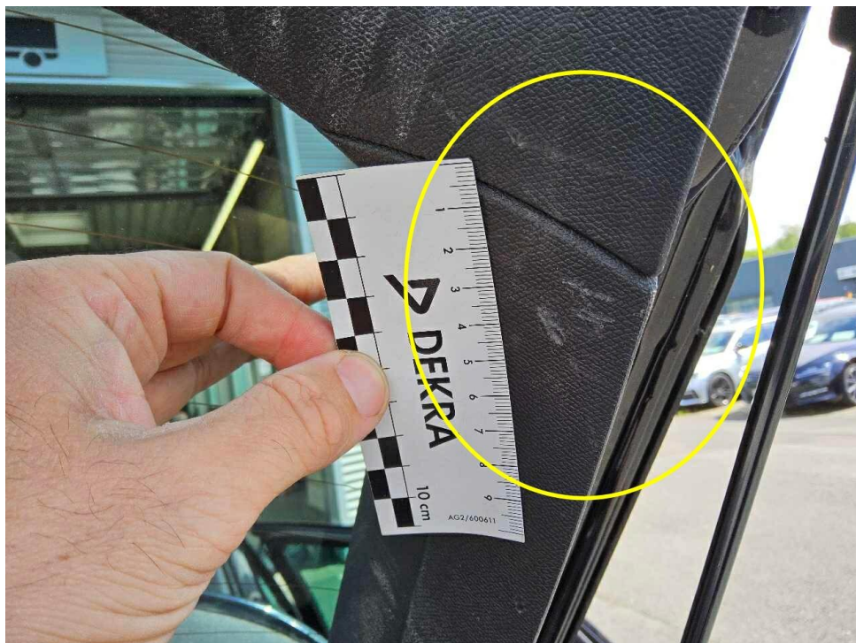
Bild 53 : Heckdeckelverkleidung mehrfach verkratzt und eingedellt
