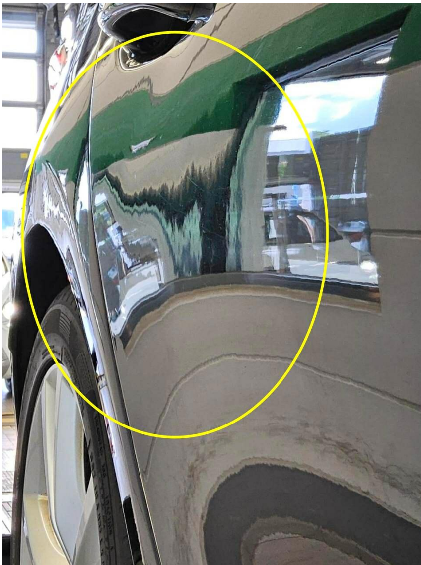
Bild 39 : Tür hinten rechts Lackierung, fleckig, lackieren mit Lackaufbau
