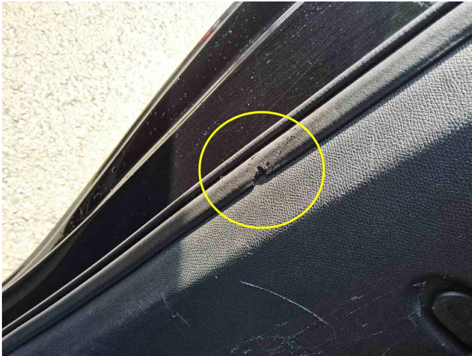
Bild 46 : Kantenschutz hinten rechts gerissen
