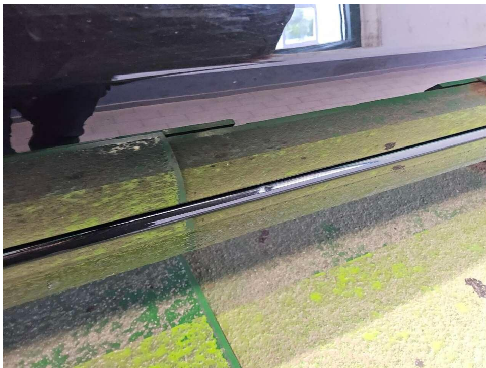
Bild 65 : Seitenschweller rechts, eingedellt, Gebrauchsspur
