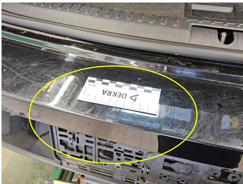
Bild 43 : Stoßfänger hinten Lackierung, zerkratzt, lackieren
