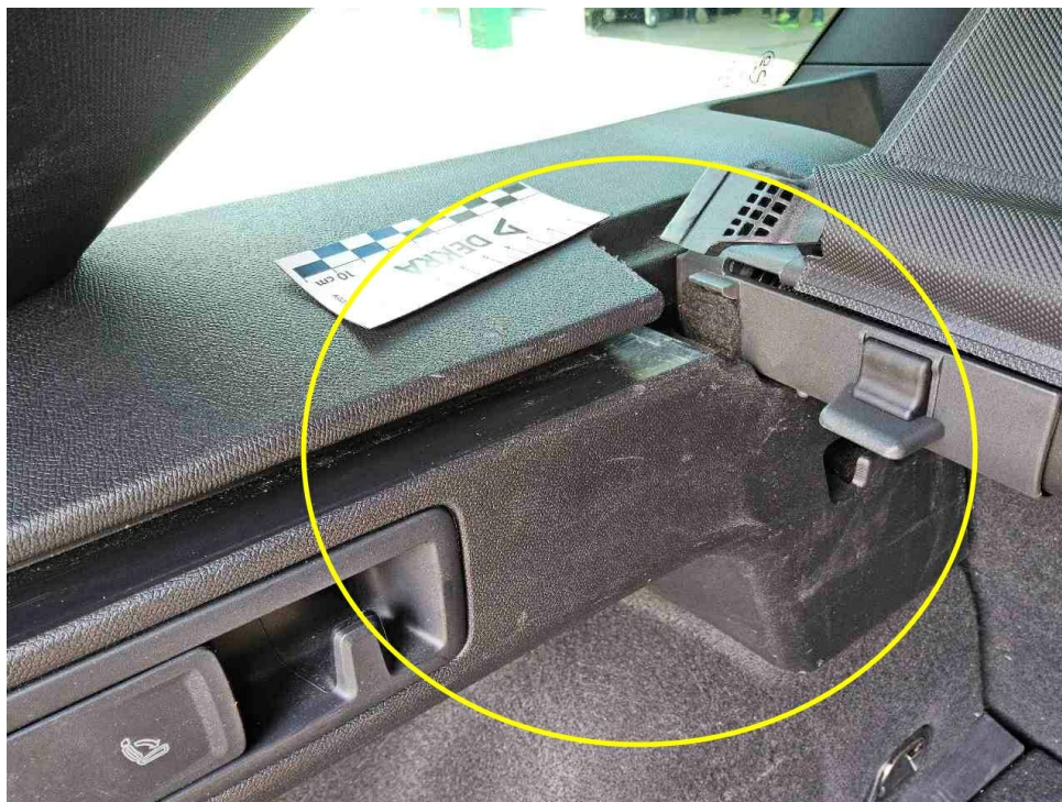
Bild 54 : D Säulenverkleidung links mehrfach verkratzt
