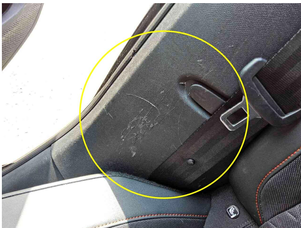
Bild 45 : C Säulenverkleidung rechts mehrfach verkratzt
