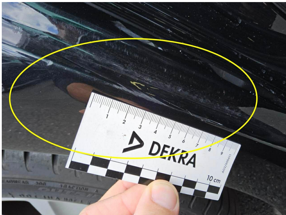
Bild 18 : Seitenteil hinten rechts, eingedellt, instandsetzen und lackieren mit Lackaufbau
