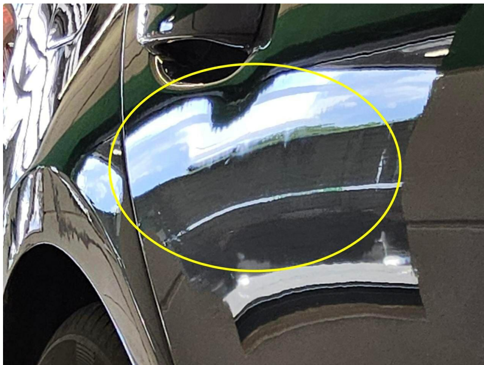
Bild 37 : Tür hinten rechts Lackierung, fleckig, lackieren mit Lackaufbau
