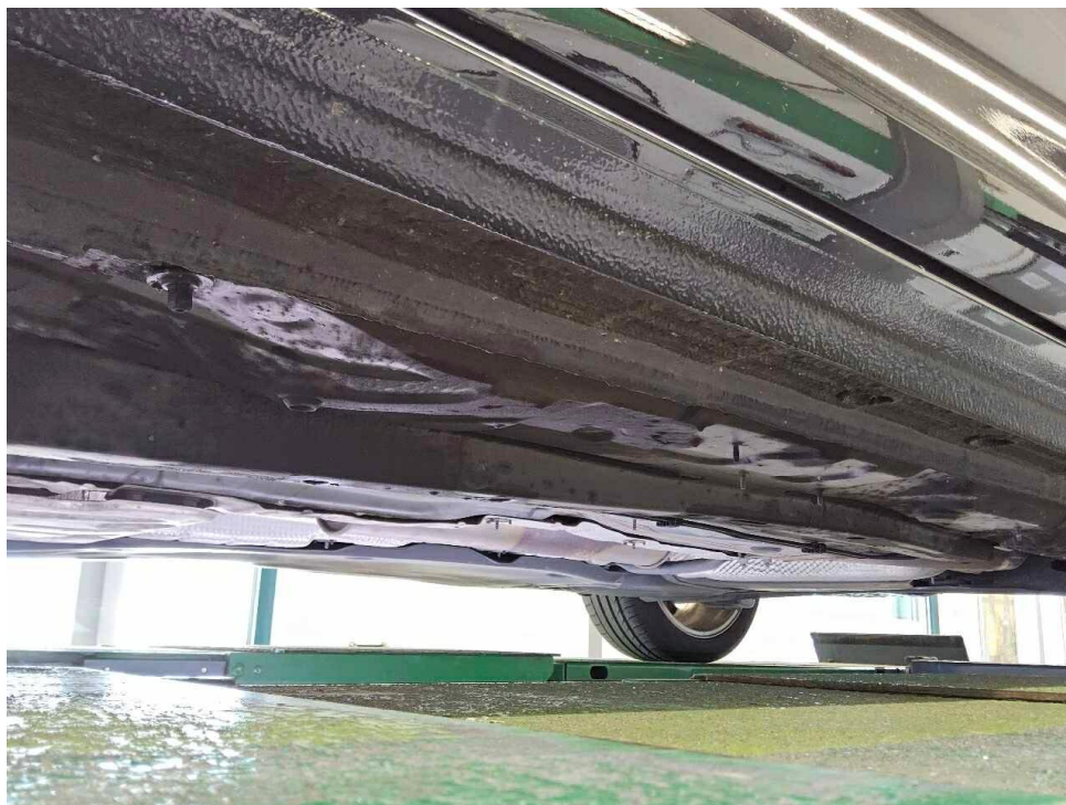
Bild 60 : Unterbodenverkleidung links fehlt
