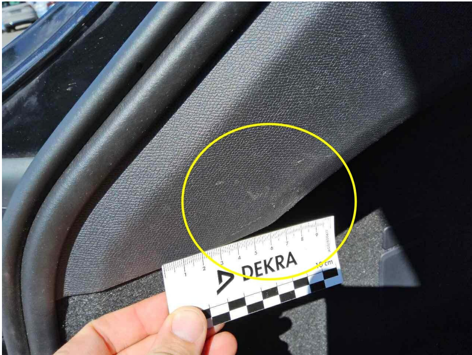
Bild 56 : D Säulenverkleidung links mehrfach verkratzt
