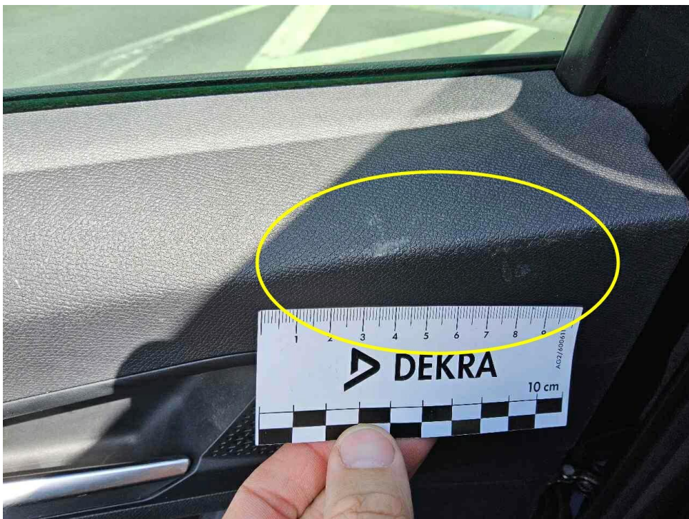
Bild 47 : Türverkleidung hinten links mehrfach verkratzt
