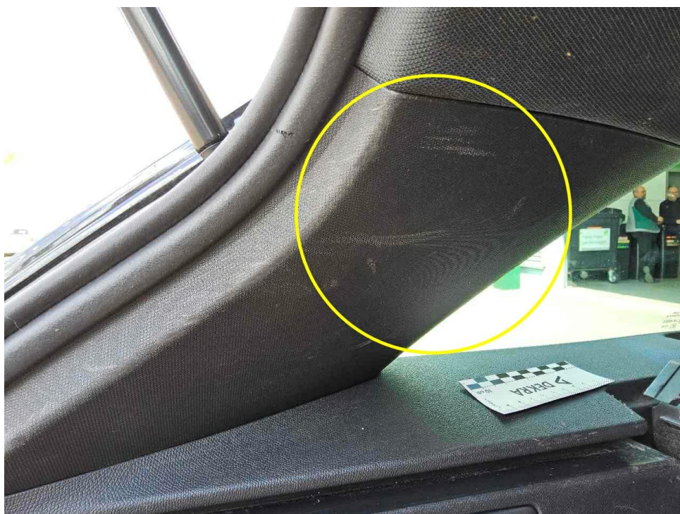
Bild 55 : D Säulenverkleidung links mehrfach verkratzt
