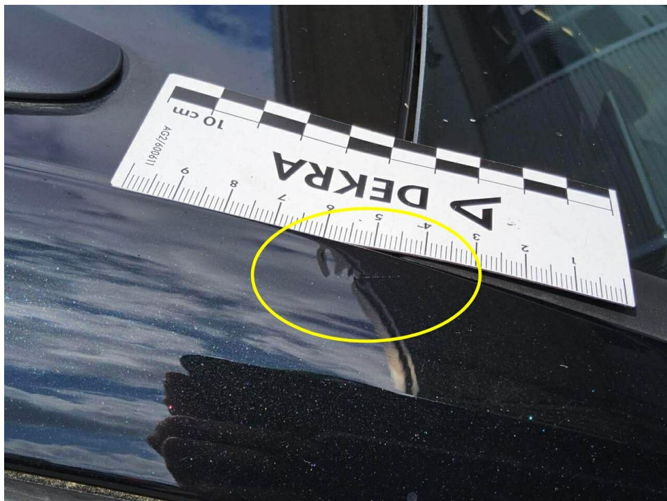
Bild 26 : Dachrahmen rechts, eingedellt, instandsetzen und lackieren mit Lackaufbau
