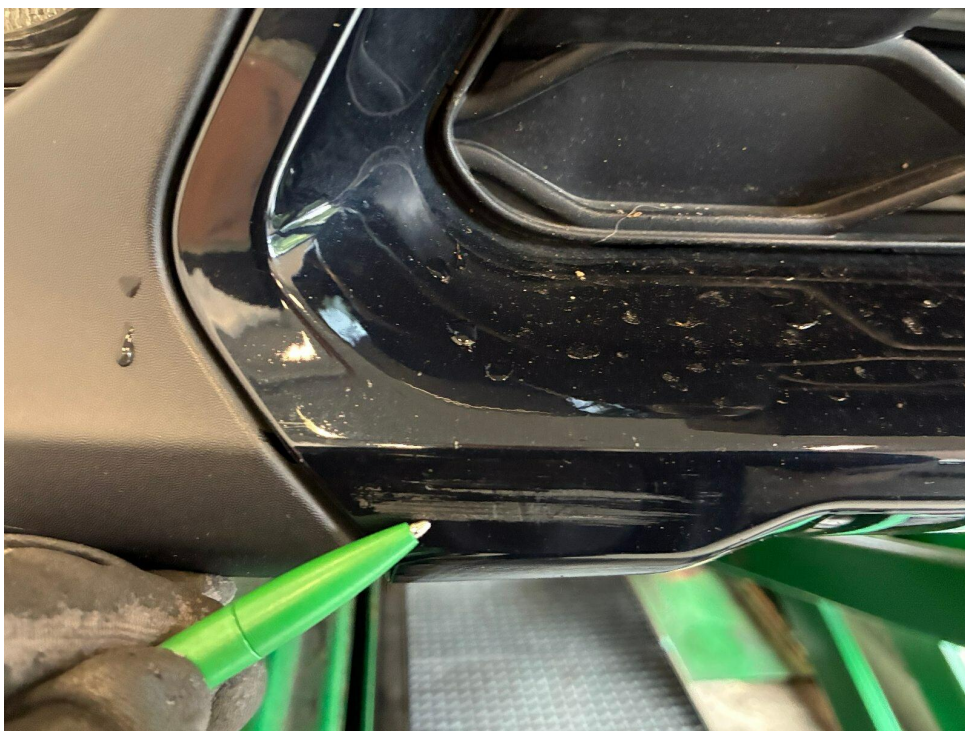
Bild 15 : Stoßfänger vorne Dekoeinsatz Kratzer
