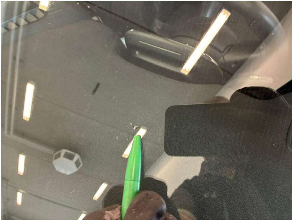
Bild 14 : Frontscheibe Steinschlag mit Rissbildung
