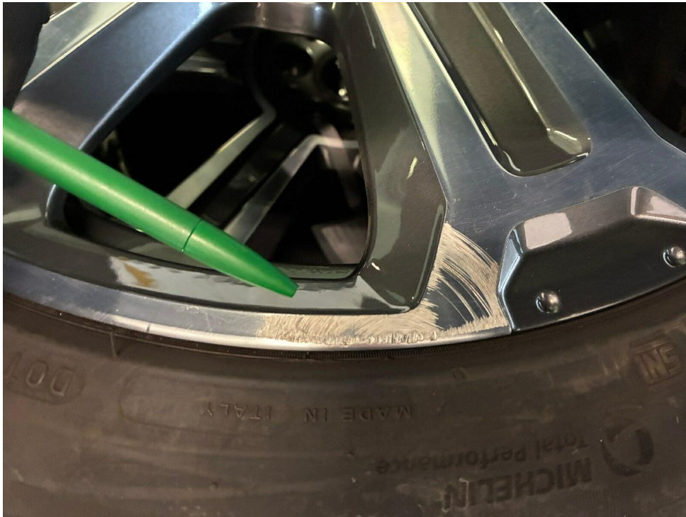
Bild 10 : 4x LM-Felgen Sommer Kratzer + Abschürfungen
