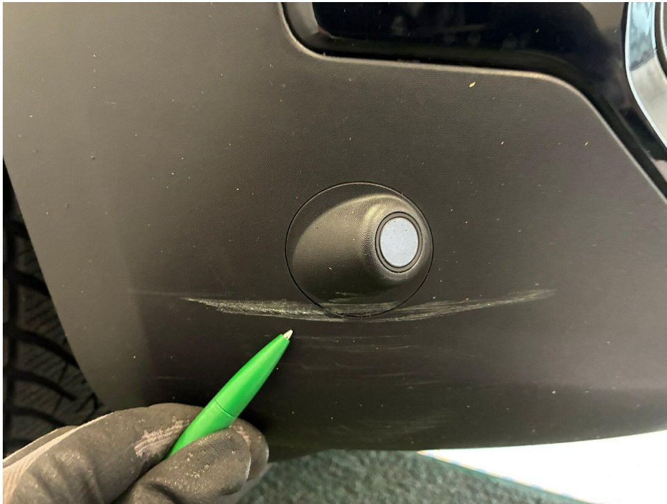
Bild 16 : Spoiler vorne rechts + PDC Sensor Kratzer
