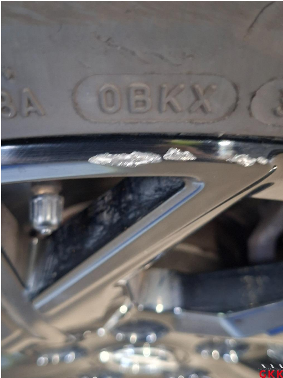
Bild 20 LM-Rad, vorne rechts, Materialabtrag, ersetzen
