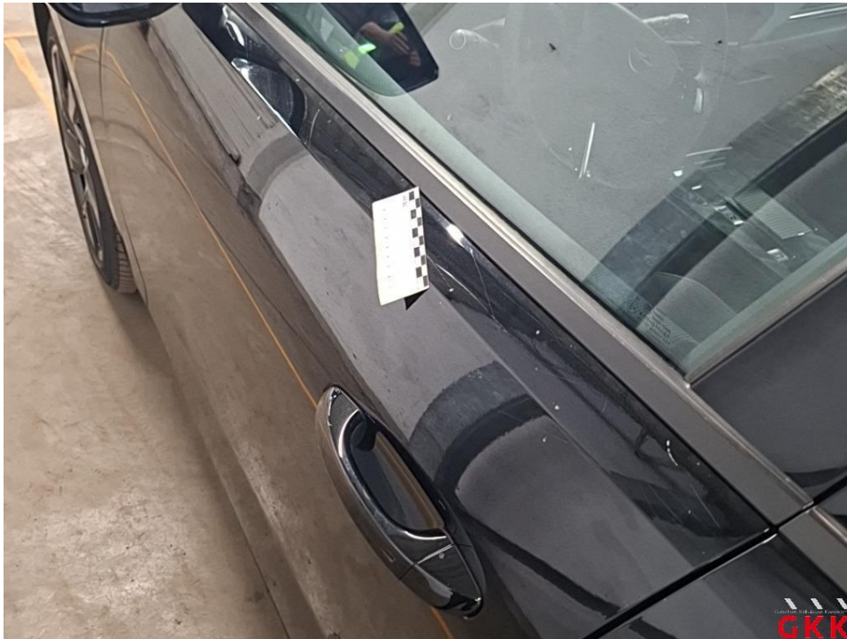
Bild 38 Tür vorne links, verkratzt, lackieren
