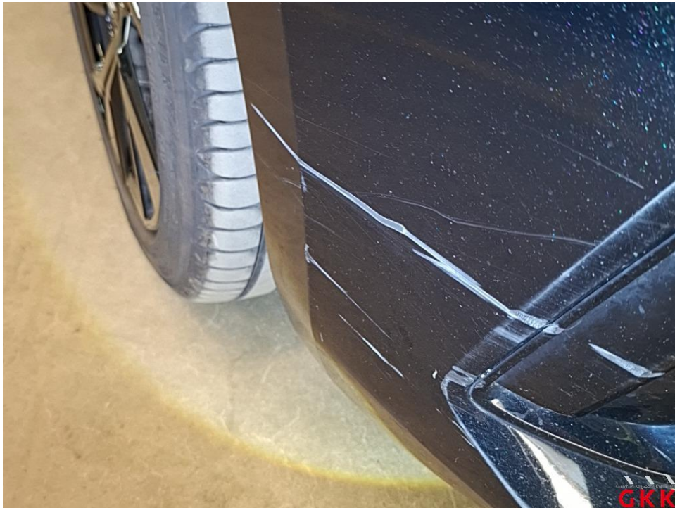
Bild 25 Stoßfänger vorne, Verkleidung -lackiert-, verkratzt, lackieren
