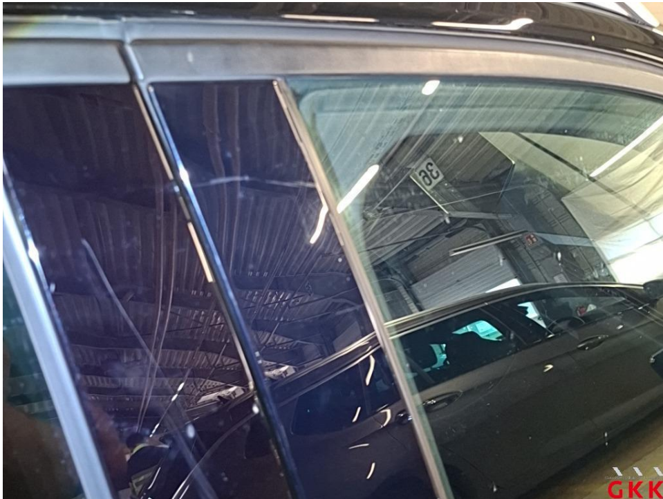
Bild 70 Tür vorne rechts, Blende -Fensterrahmen-, verkratzt, ersetzen
