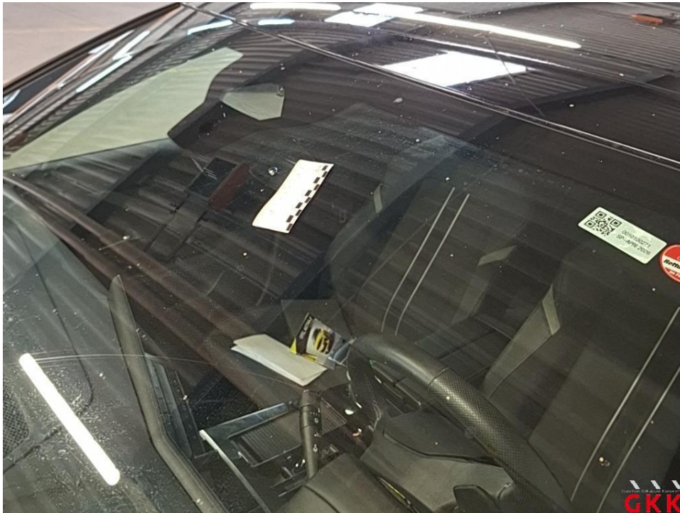
Bild 35 Frontscheibe, beheizt mit Regensensor und Frontkamera, Steinschlag im Sichtfeld, ersetzen
