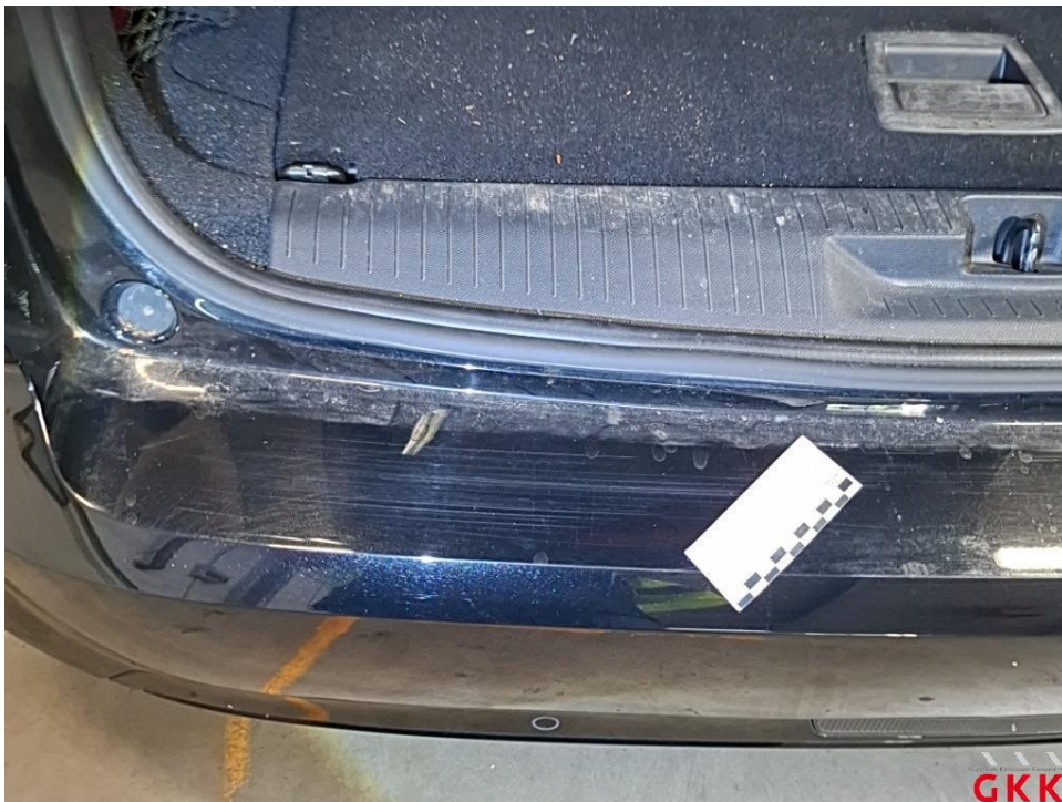
Bild 45 Stoßfänger hinten, Verkleidung -lackiert-, verkratzt, lackieren
