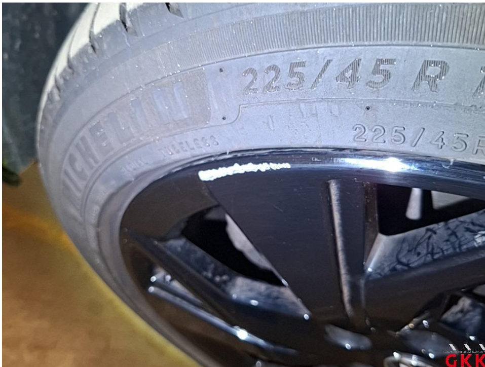
Bild 32 LM-Rad, vorne links, Materialabtrag, ersetzen
