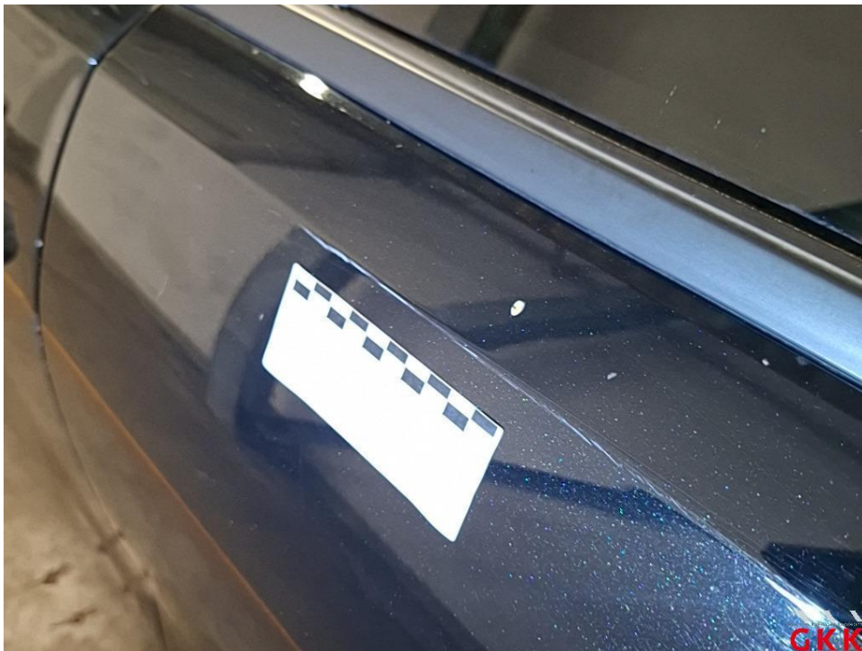
Bild 41 Tür hinten links, verkratzt, lackieren
