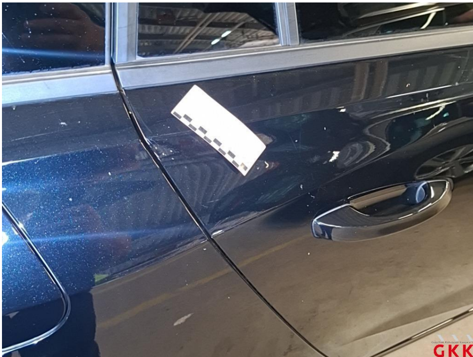
Bild 57 Tür hinten rechts, verkratzt, lackieren
