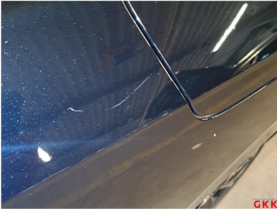
Bild 54 Seitenwand rechts, verkratzt, lackieren
