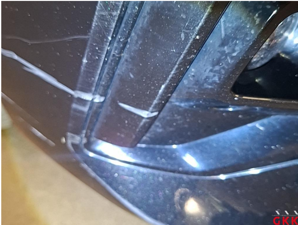
Bild 27 Stoßfänger vorne, Blende -lackiert-, verkratzt, ersetzen
