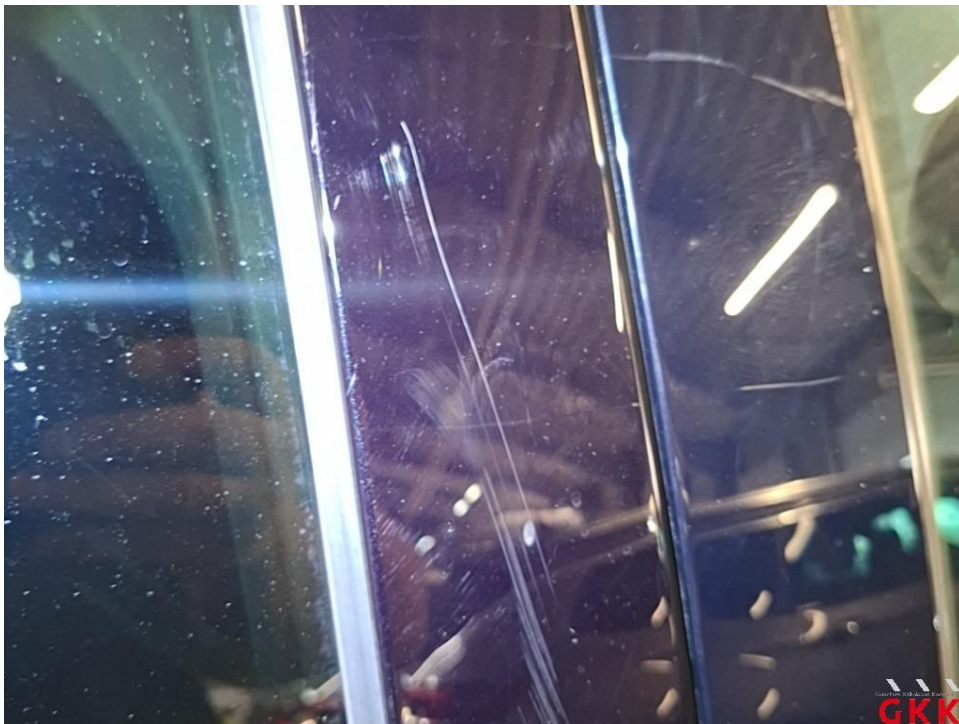
Bild 69 Tür hinten rechts, Blende -Fensterrahmen-, verkratzt, ersetzen
