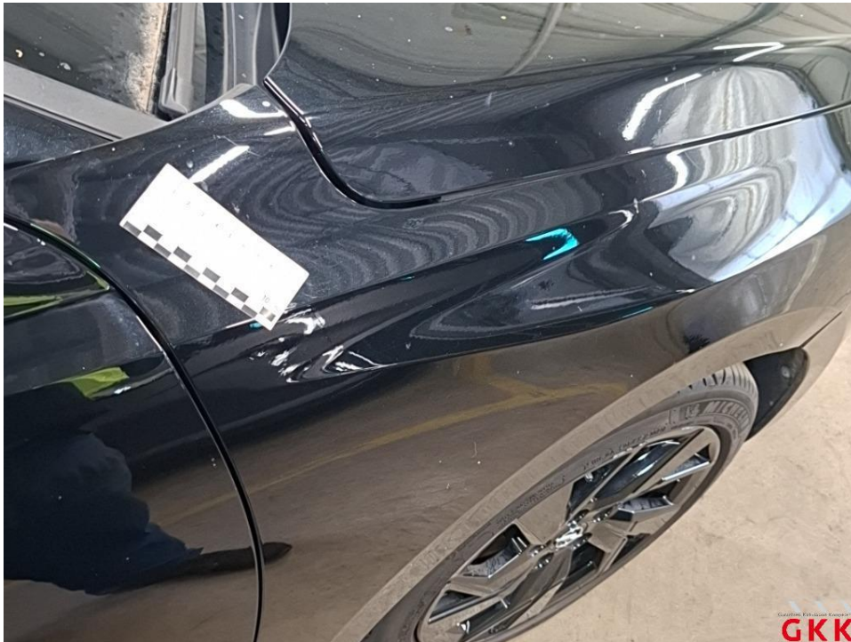
Bild 21 Kotflügel vorne rechts, verkratzt, lackieren
