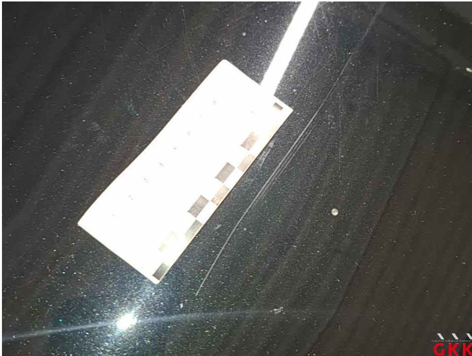
Bild 29 Motorhaube, verkratzt, lackieren
