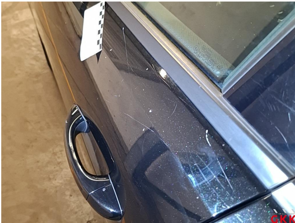
Bild 39 Tür vorne links, verkratzt, lackieren
