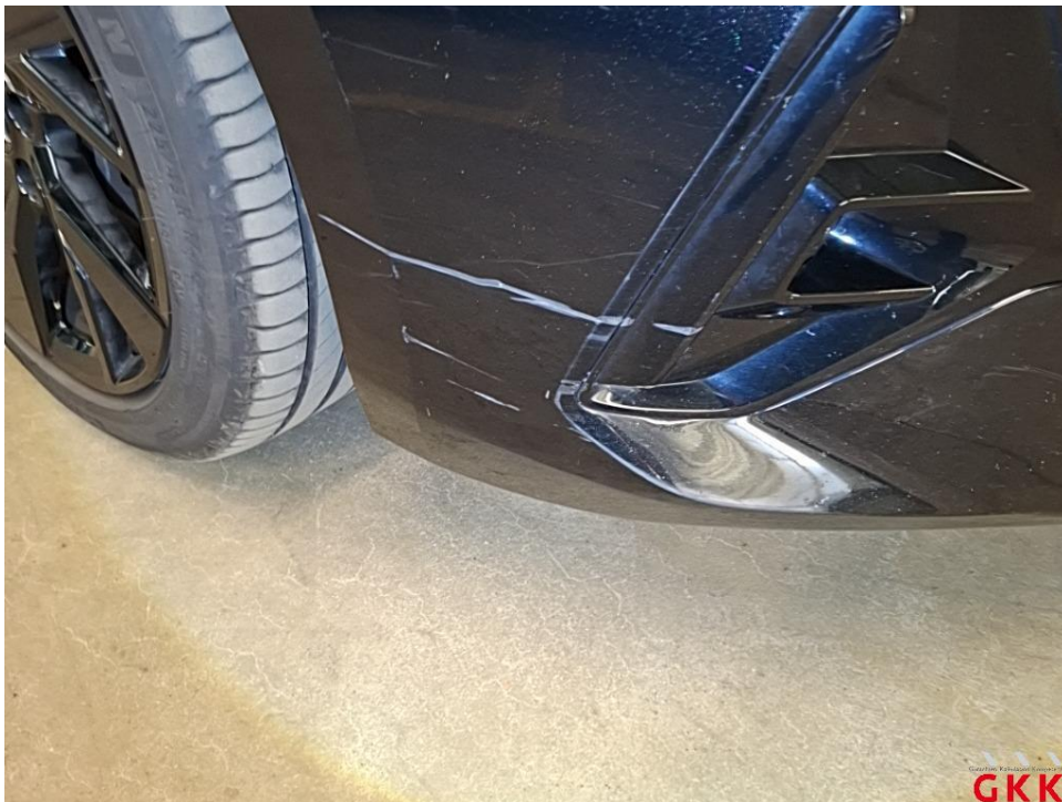
Bild 24 Stoßfänger vorne, Verkleidung -lackiert-, verkratzt, lackieren
