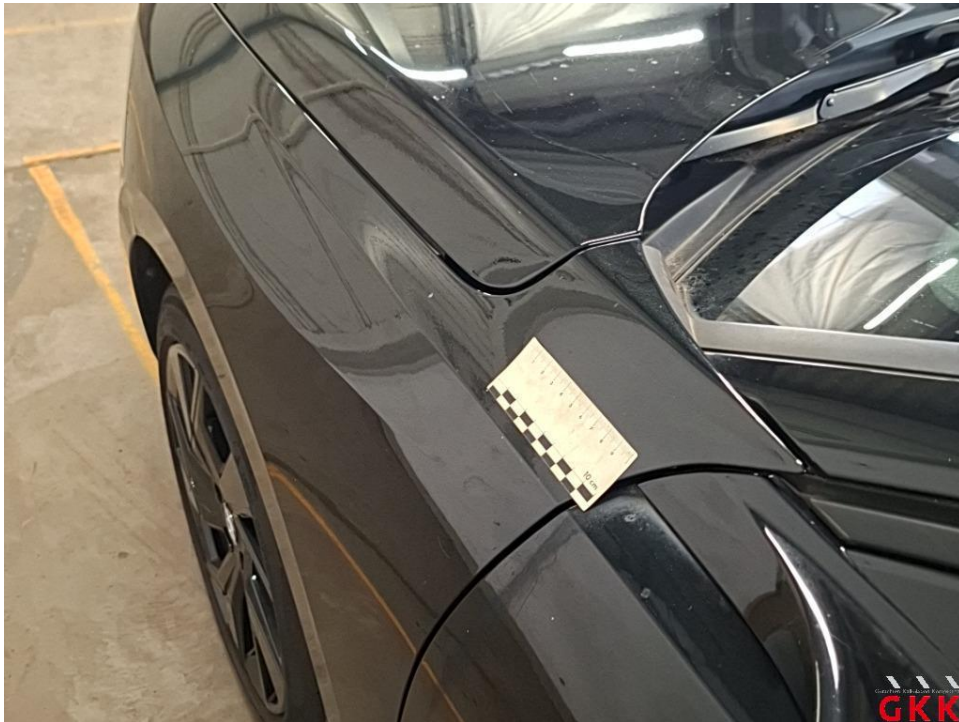
Bild 33 Kotflügel vorne links, verkratzt, lackieren
