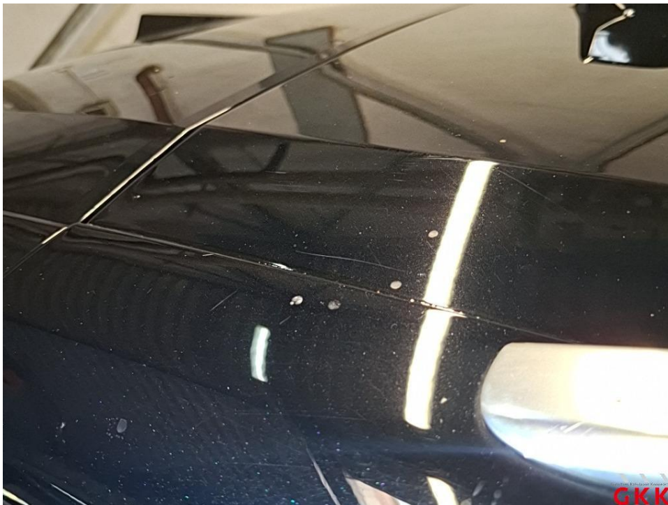
Bild 65 Fahrzeug, außen, verkratzt und verschmutzt, aufbereiten
