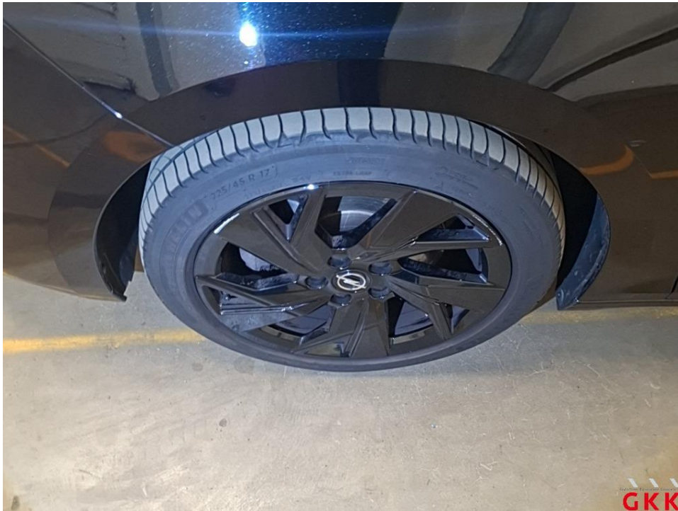
Bild 31 LM-Rad, vorne links, Materialabtrag, ersetzen
