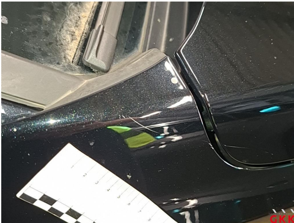
Bild 22 Kotflügel vorne rechts, verkratzt, lackieren
