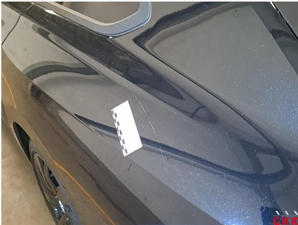
Bild 43 Seitenwand links, verkratzt, lackieren
