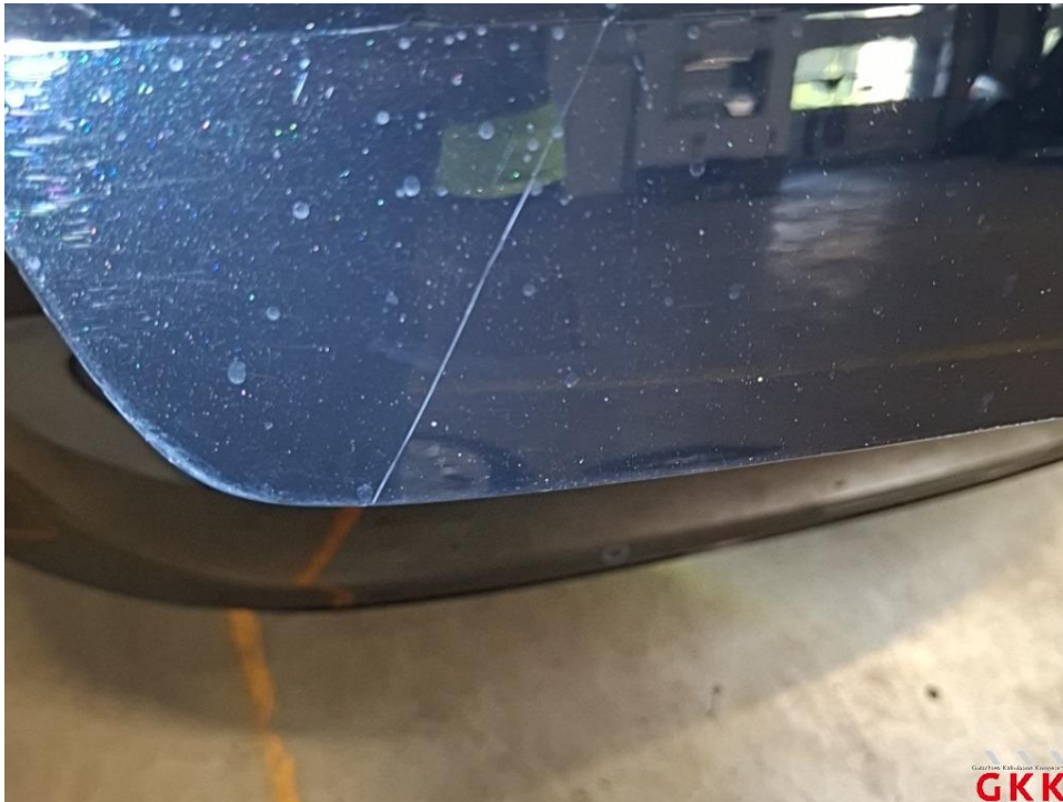
Bild 48 Heckklappe, verkratzt, lackieren
