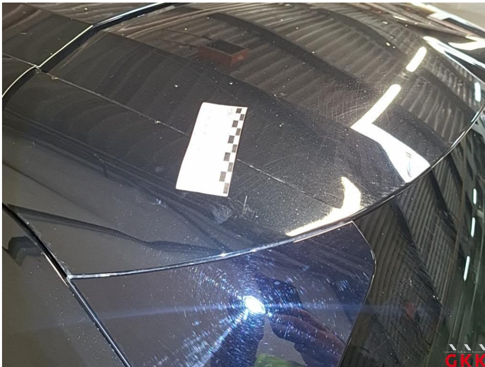
Bild 49 Heckklappe, Spoiler -lackiert-, verkratzt, lackieren
