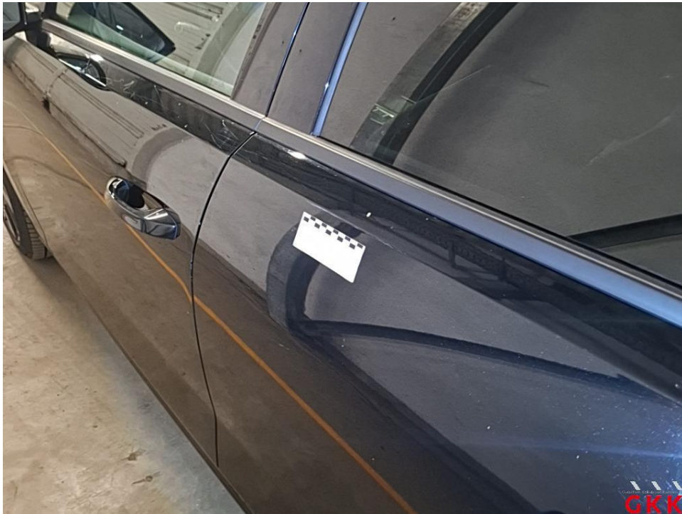
Bild 40 Tür hinten links, verkratzt, lackieren
