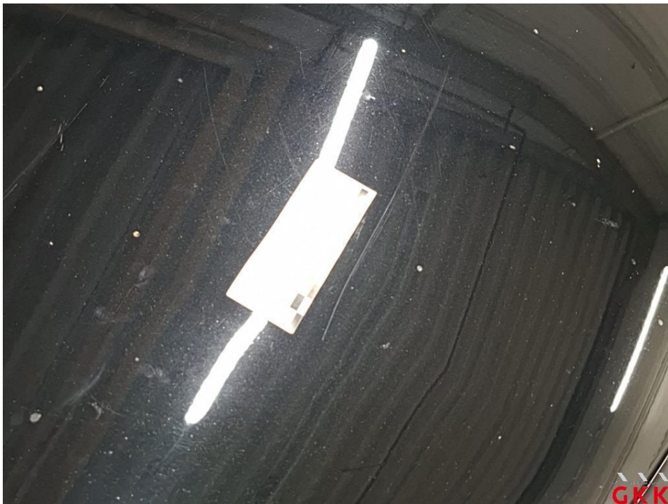
Bild 28 Motorhaube, verkratzt, lackieren
