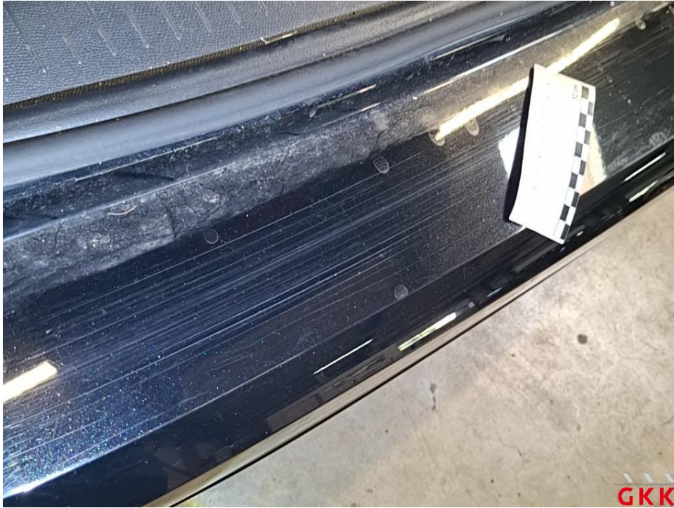
Bild 46 Stoßfänger hinten, Verkleidung -lackiert-, verkratzt, lackieren
