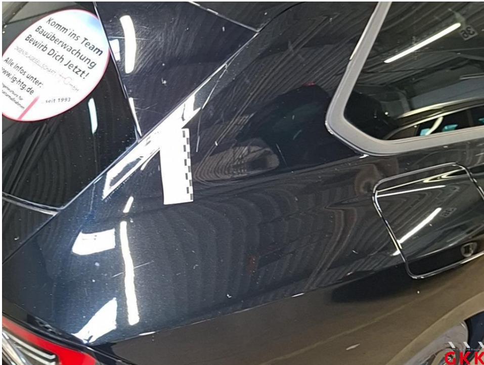
Bild 52 Seitenwand rechts, verkratzt, lackieren
