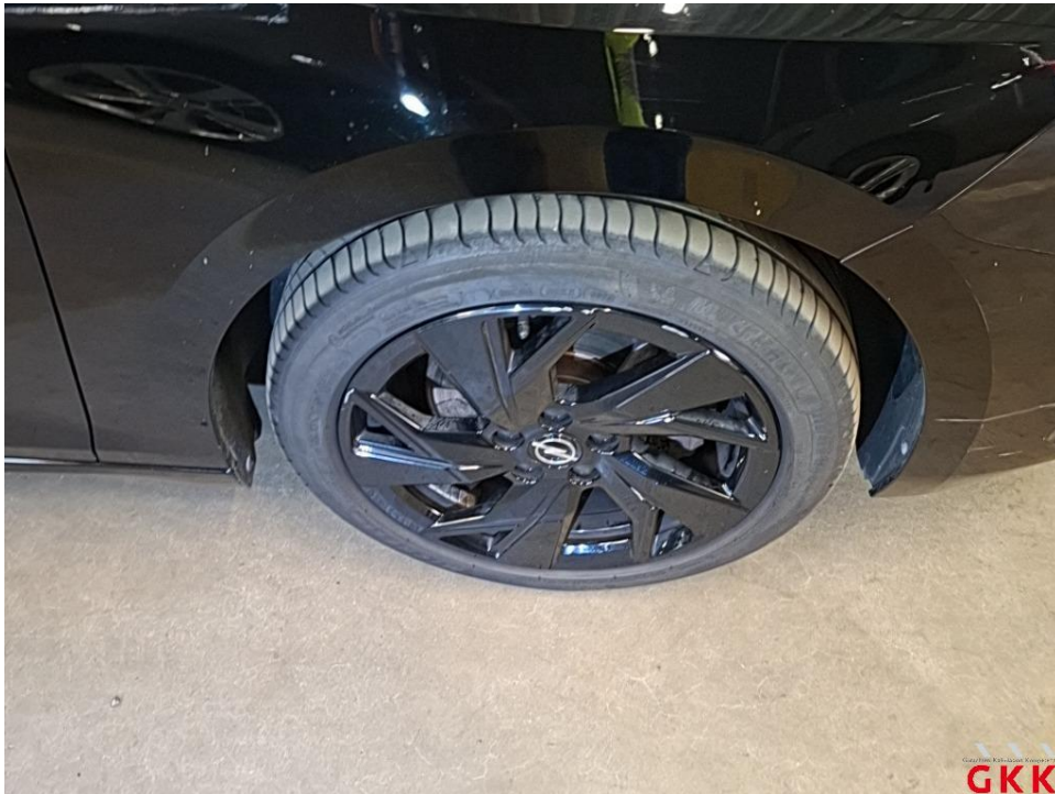
Bild 19 LM-Rad, vorne rechts, Materialabtrag, ersetzen
