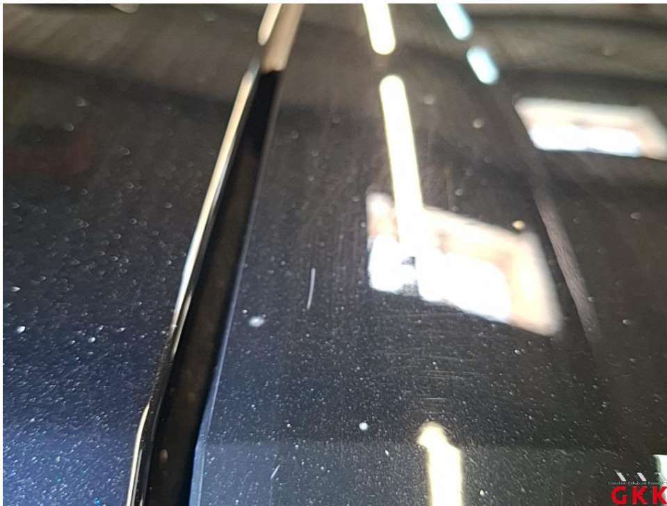
Bild 51 Heckklappe, Spoiler -lackiert-, verkratzt, lackieren
