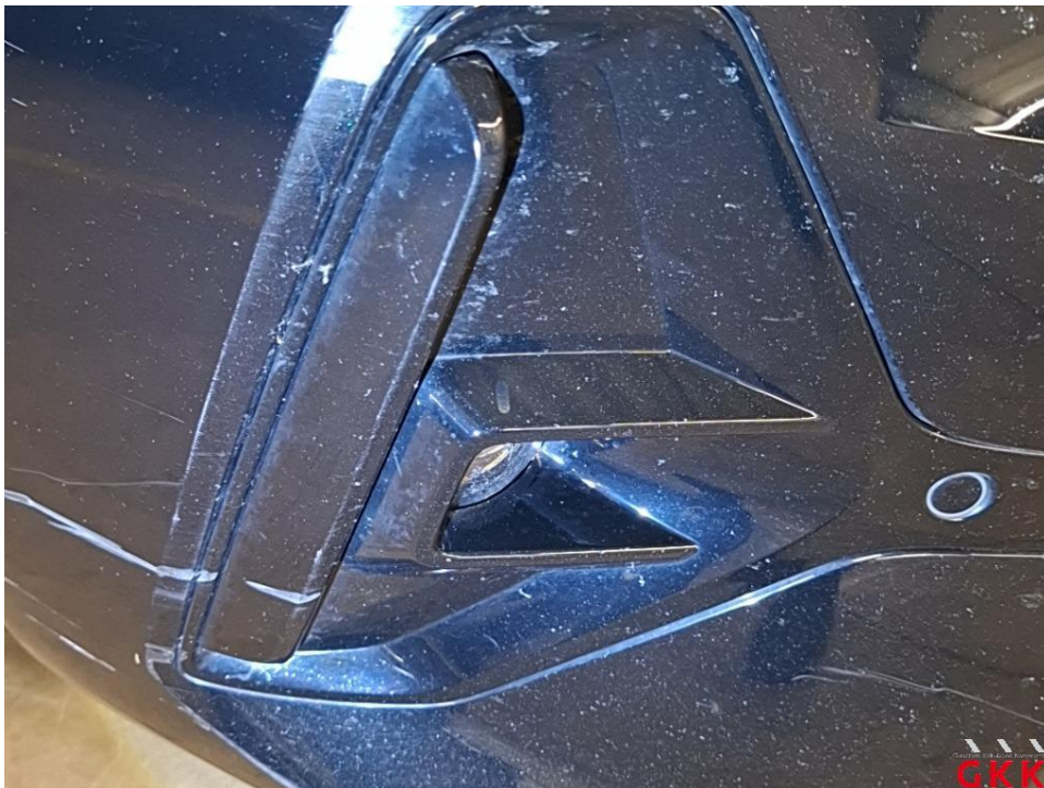
Bild 26 Stoßfänger vorne, Blende -lackiert-, verkratzt, ersetzen
