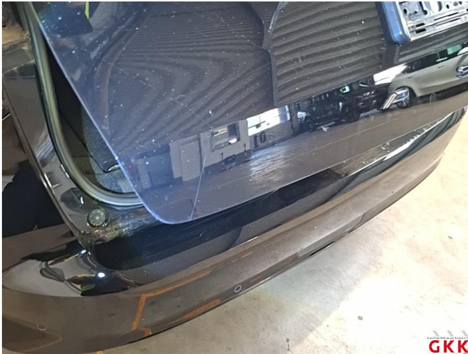
Bild 47 Heckklappe, verkratzt, lackieren
