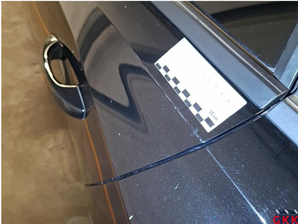
Bild 42 Tür hinten links, verkratzt, lackieren
