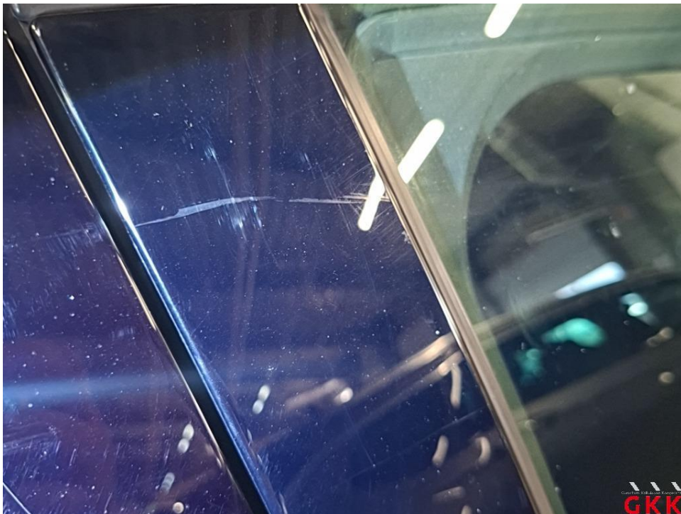
Bild 71 Tür vorne rechts, Blende -Fensterrahmen-, verkratzt, ersetzen
