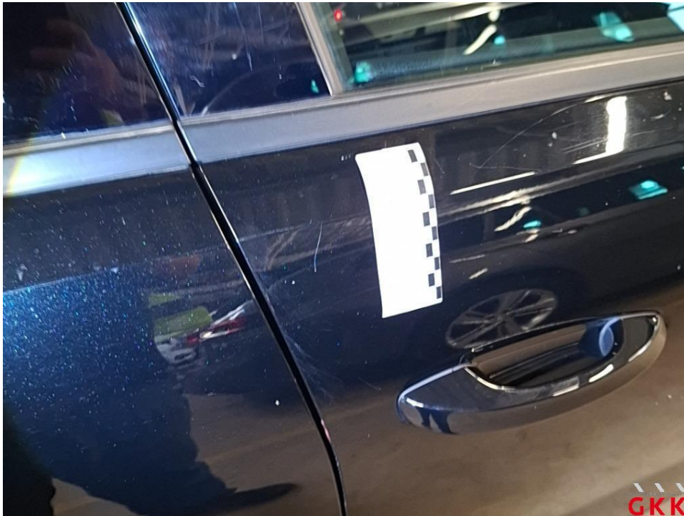
Bild 62 Tür vorne rechts, verkratzt, lackieren
