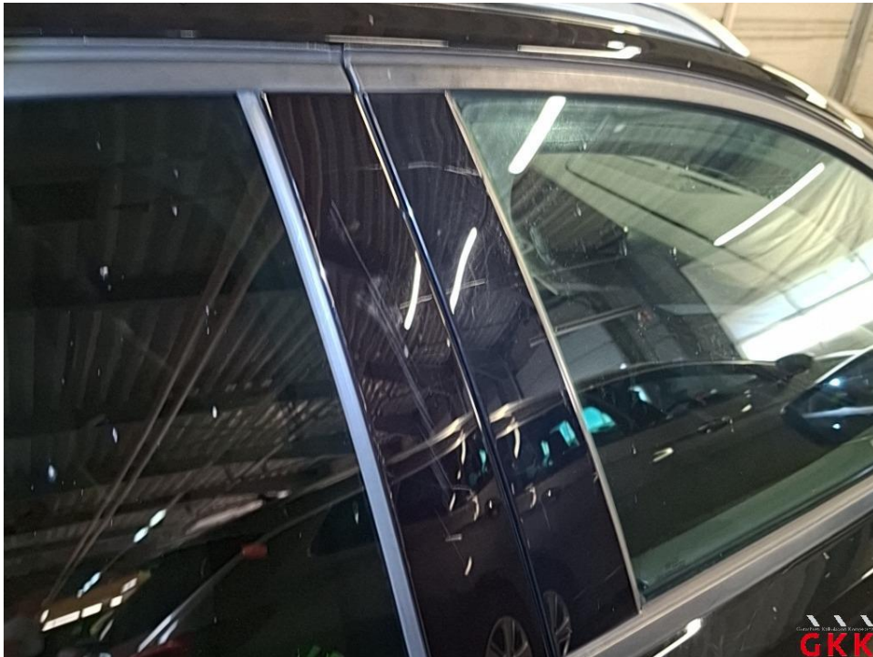
Bild 68 Tür hinten rechts, Blende -Fensterrahmen-, verkratzt, ersetzen
