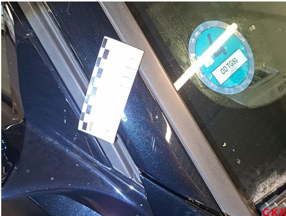
Bild 63 A- Säule rechts, verkratzt, lackieren
