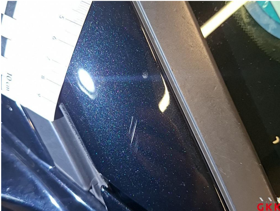
Bild 64 A- Säule rechts, verkratzt, lackieren
