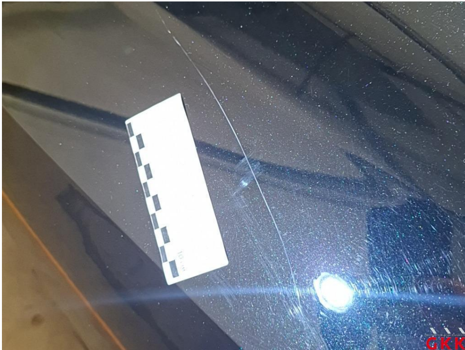
Bild 44 Seitenwand links, verkratzt, lackieren
