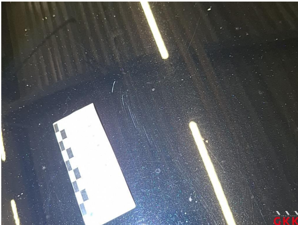
Bild 30 Motorhaube, verkratzt, lackieren
