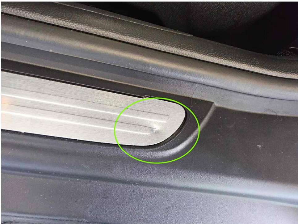
Bild 14 : Einstieg vorne links, Zierleiste eingedellt
