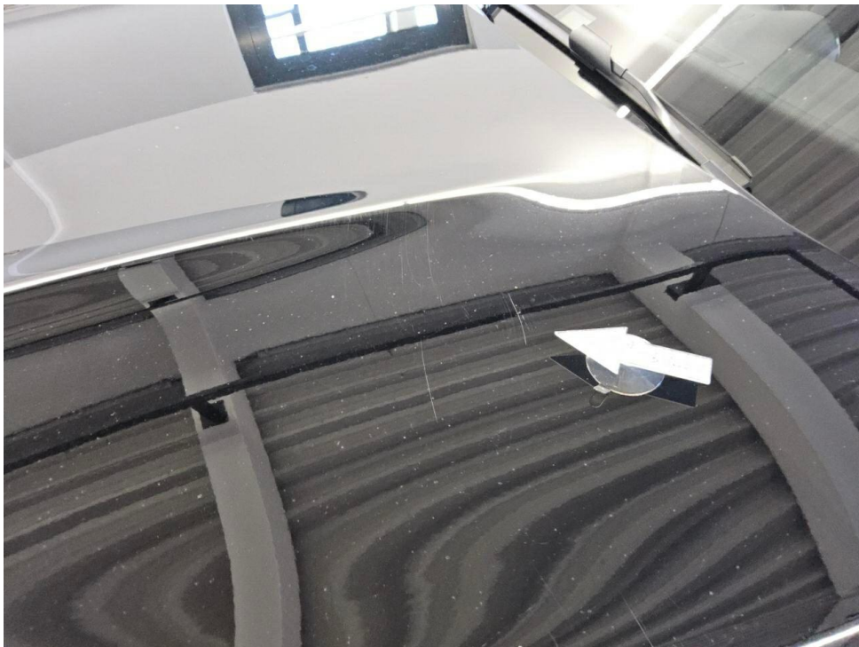
Bild 22 : Motorhaube Lackierung, zerkratzt, polieren
