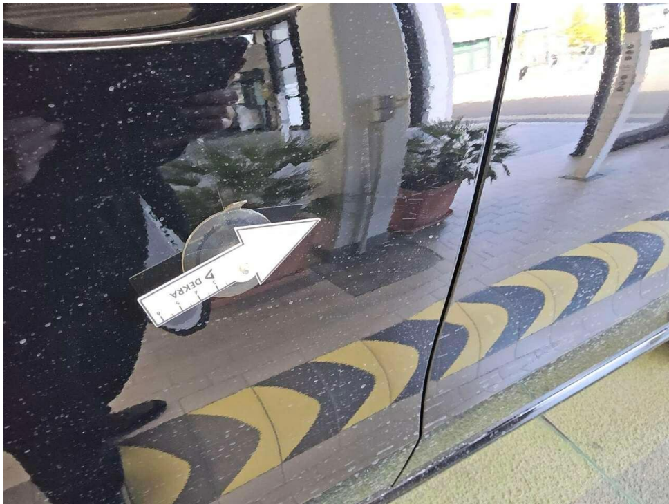
Bild 20 : Tür vorne links Lackierung, zerkratzt, polieren
