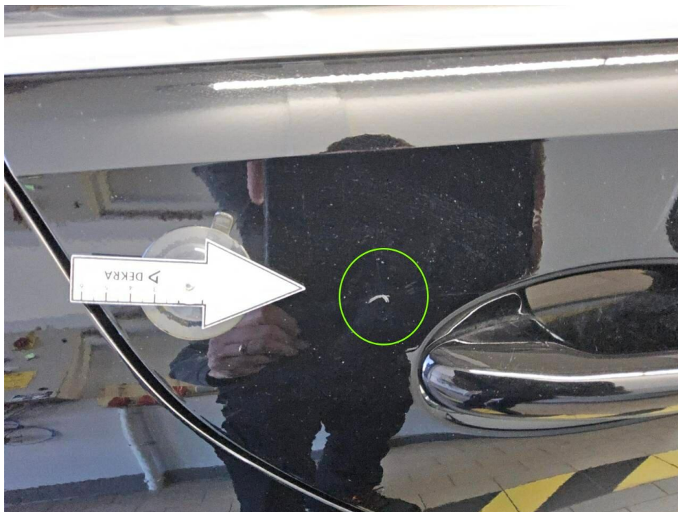
Bild 23 : Tür hinten rechts Lackierung, zerkratzt, smart repair
