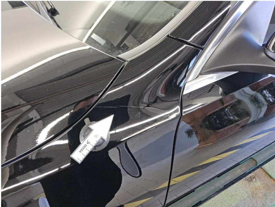
Bild 21 : Kotflügel vorne links Lackierung, zerkratzt, polieren
