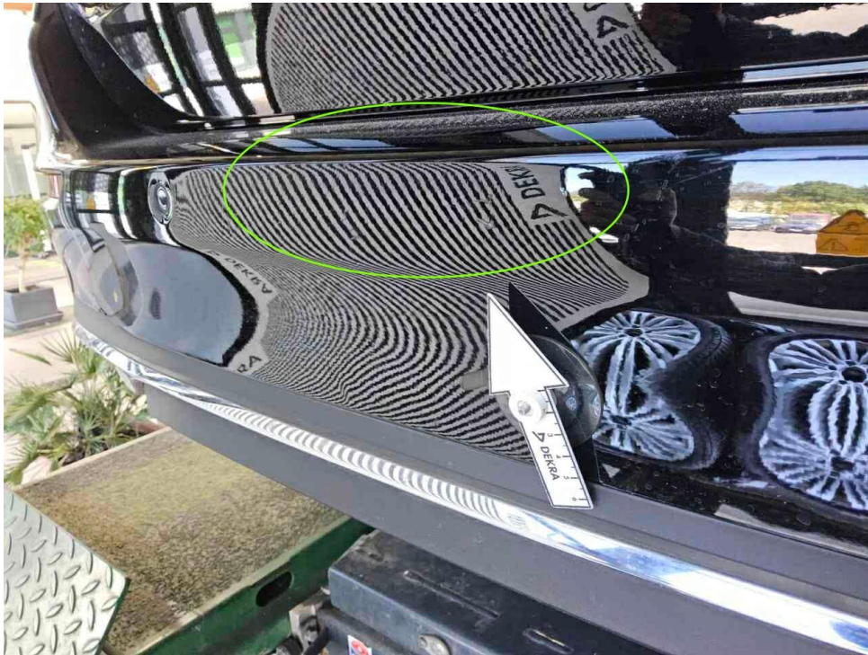
Bild 17 : Stoßfänger hinten, zerkratzt, smart repair
