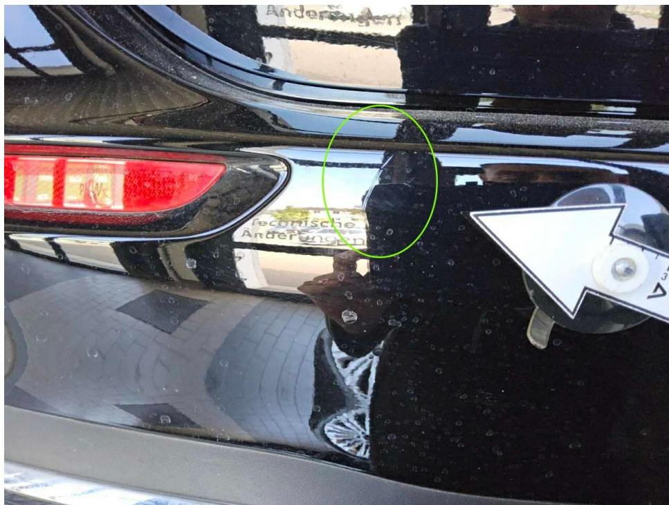
Bild 14 : Stoßfänger hinten, zerkratzt, smart repair
