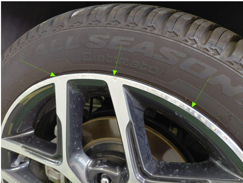
Bild 9 : Felge hinten rechts verschrammt (glanzgedreht)
