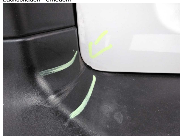
Beschädigung #19: Heckklappe/-tür: Hecktür links - Delle / Lackschaden - erneuern
