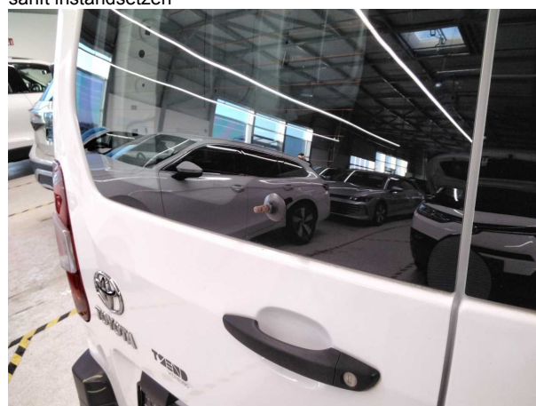
Beschädigung #6: Scheibenreinigung: Scheibenwischerarm hinten - fehlt - erneuern
