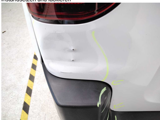
Beschädigung #19: Heckklappe/-tür: Hecktür links - Delle / Lackschaden - erneuern
