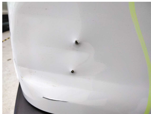
Beschädigung #19: Heckklappe/-tür: Hecktür links - Delle / Lackschaden - erneuern
