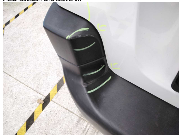
Beschädigung #16: Stoßfänger hinten: Stoßfänger hinten - beschädigt - erneuern
