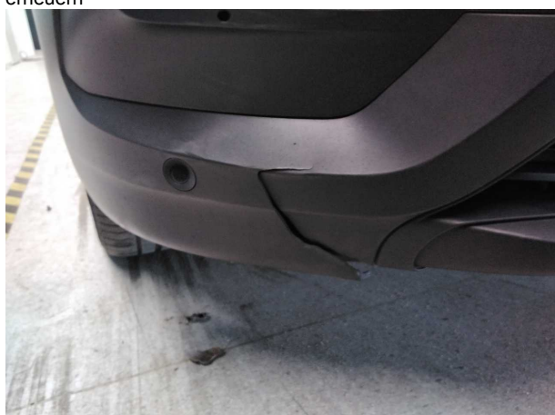
Beschädigung #13: Stossfänger vorn: Spoiler - beschädigt - erneuern
