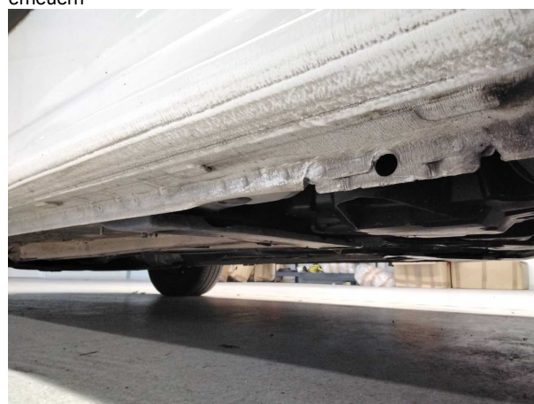
Beschädigung #14: Schweller links: Schweller - verformt - instandsetzen und lackieren
