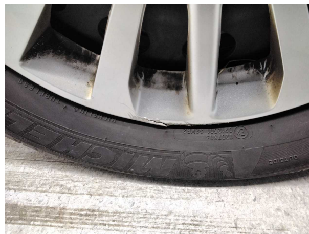
Beschädigung #1: Rad/Reifen: Radblende vorn rechts - beschädigt - erneuern
