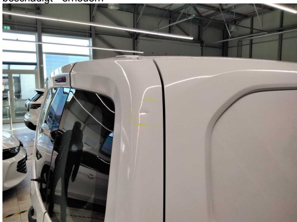
Beschädigung #17: Heckklappe/-tür: Hecktür rechts - Delle / Lackschaden - instandsetzen und lackieren
