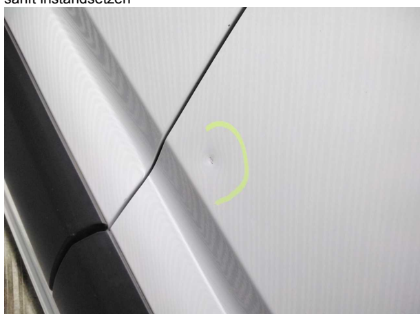
Beschädigung #5: Tür vorn rechts: Tür - Delle / Lackschaden - sanft instandsetzen
