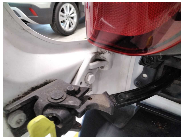
Beschädigung #11: Tür hinten links: Scharnier Satz - beschädigt - erneuern
