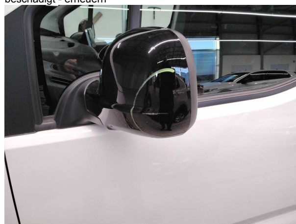
Beschädigung #3: Außenspiegel links: Abdeckkappe - Kratzer - Smart Repair
