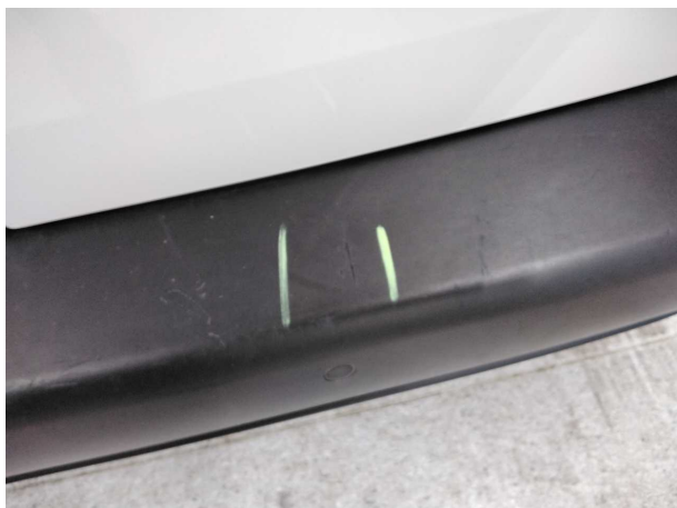
Beschädigung #16: Stossfänger hinten: Stossfänger hinten - beschädigt - erneuern
