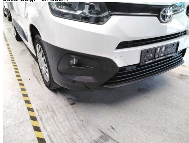
Beschädigung #13: Stossfänger vorn: Spoiler - beschädigt - erneuern
