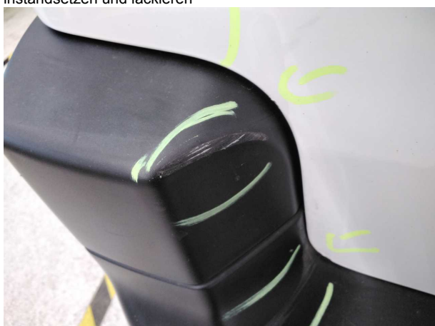
Beschädigung #16: Stoßfänger hinten: Stoßfänger hinten - beschädigt - erneuern
