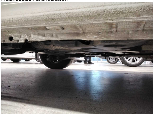
Beschädigung #15: Schweller rechts: Schweller - verformt - instandsetzen und lackieren
