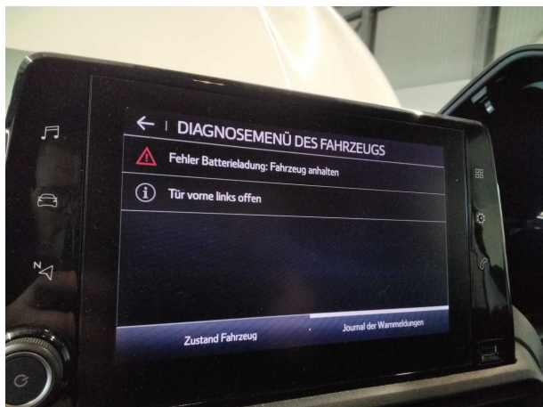
Beschädigung #10: elektrisches System: Batterie - Funktion / Zulässigkeit - erneuern
