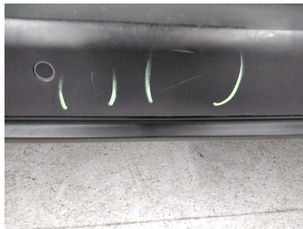
Beschädigung #16: Stossfänger hinten: Stossfänger hinten - beschädigt - erneuern
