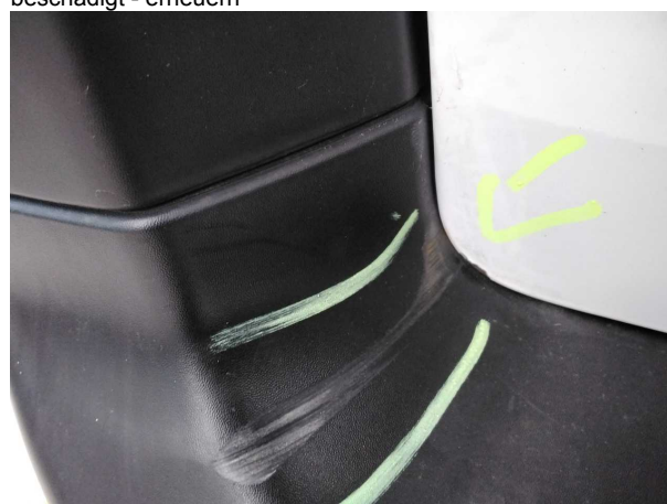
Beschädigung #16: Stoßfänger hinten: Stoßfänger hinten - beschädigt - erneuern
