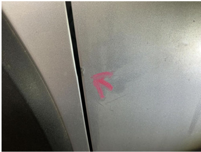
Tür VL Lackabplatzer - Auslegen polieren
