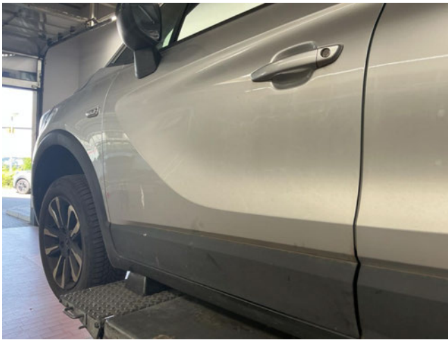
Tür VL Lackabplatzer - Auslegen polieren
