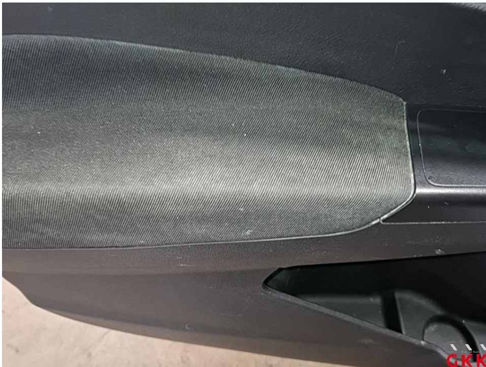
Bild 26 Fahrzeug, innen, verkratzt und verschmutzt, aufbereiten
