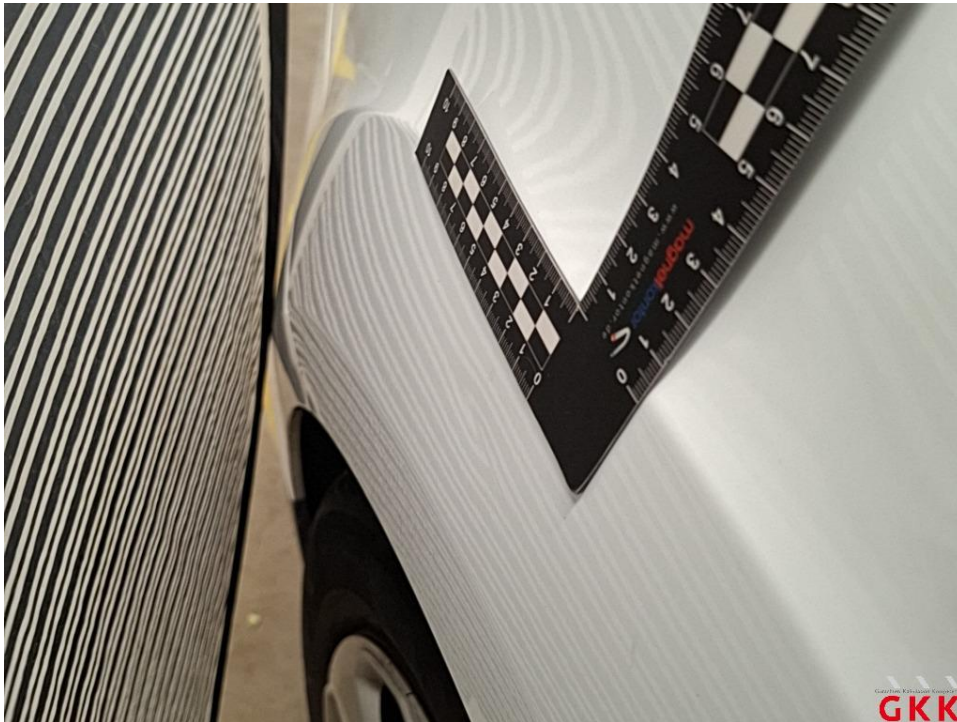
Bild 21 Kotflügel vorne links, beschädigt, instand setzen - lackieren
