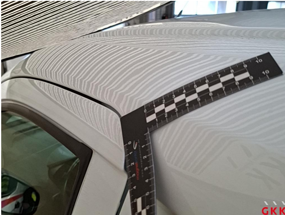
Bild 29 Seitenwand links, beschädigt, kalt drücken
