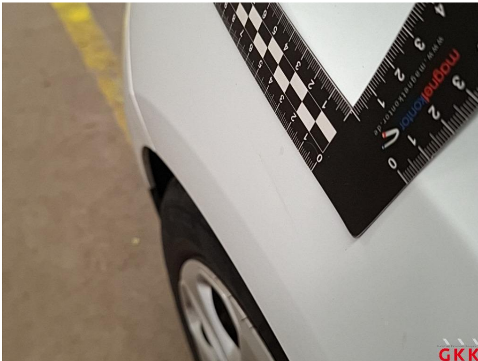
Bild 22 Kotflügel vorne links, beschädigt, instand setzen - lackieren
