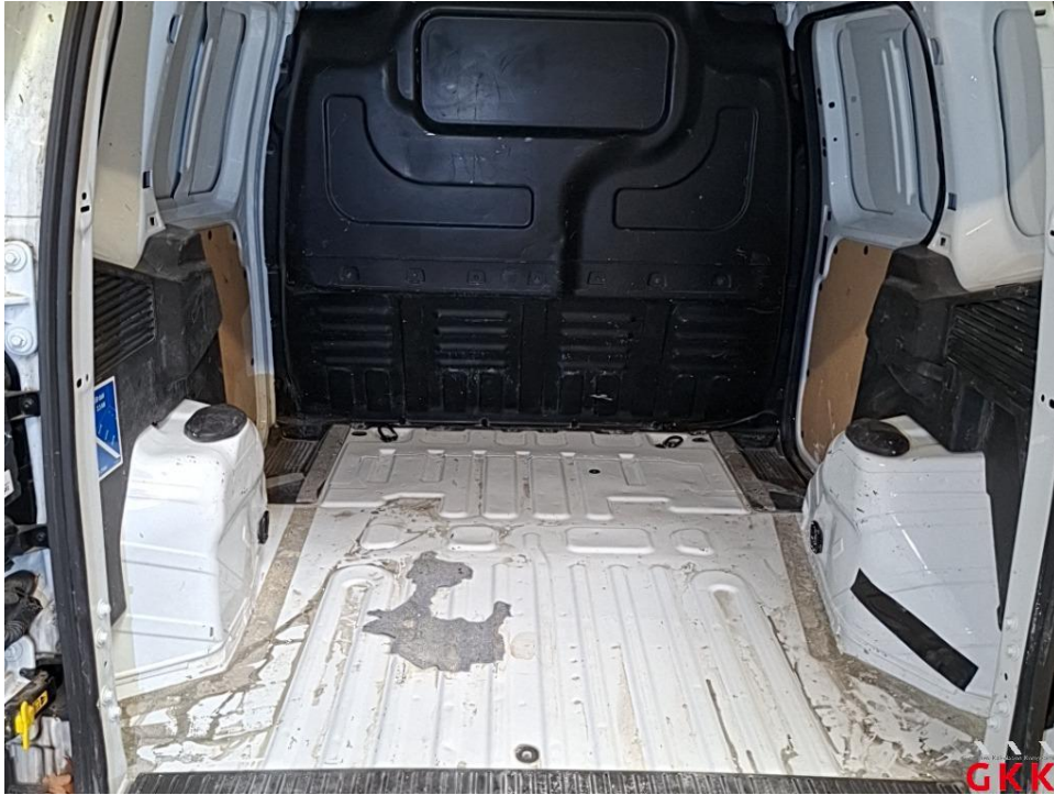
Bild 19 Laderaum Laderaumboden Kunststoff (Formteil), fehlt, ersetzen
