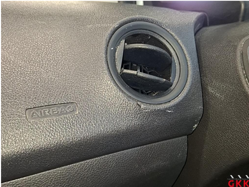
Bild 17 Armaturenbrett, beschädigt, Smartrepair
