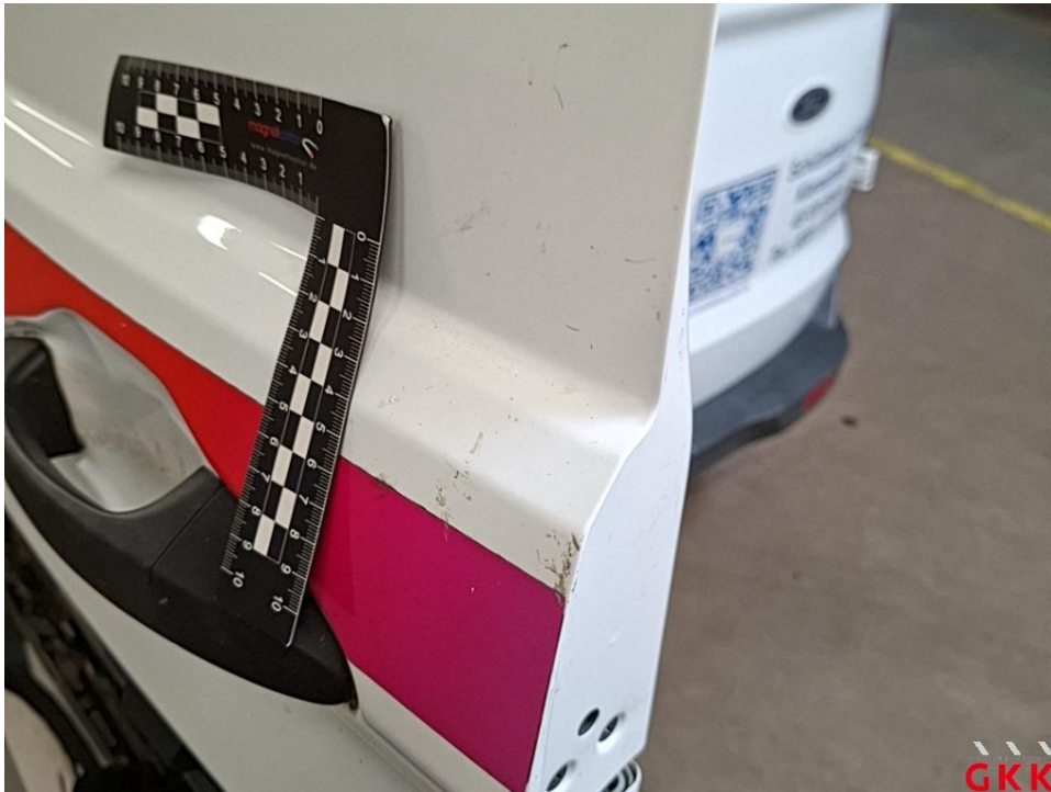
Bild 31 Hecktür links, verkratzt, lackieren
