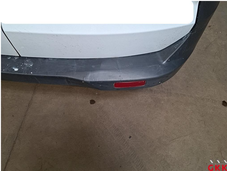
Bild 37 Stoßfänger hinten, Verkleidung -unlackiert-, beschädigt, ersetzen
