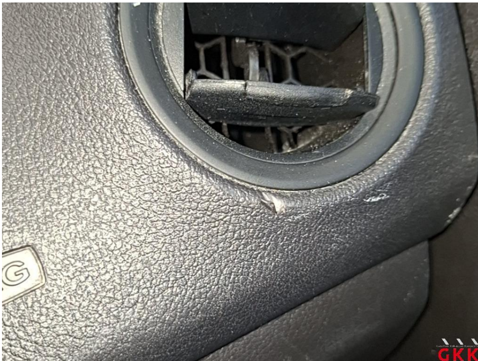
Bild 18 Armaturenbrett, beschädigt, Smartrepair
