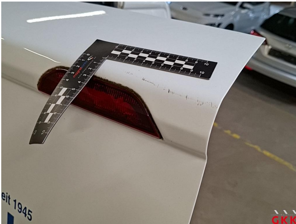
Bild 30 Hecktür links, verkratzt, lackieren
