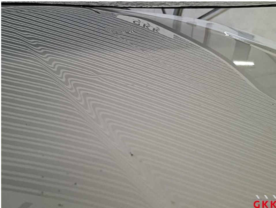
Bild 42 Dach, beschädigt, instand setzen - lackieren
