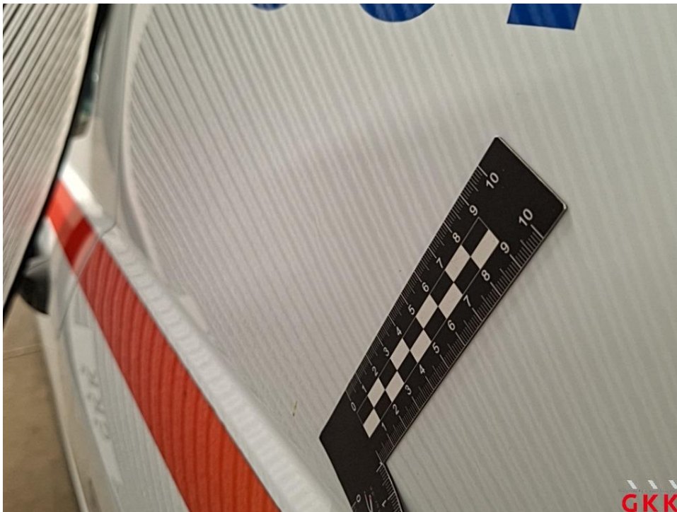
Bild 28 Seitenwand links, beschädigt, kalt drücken
