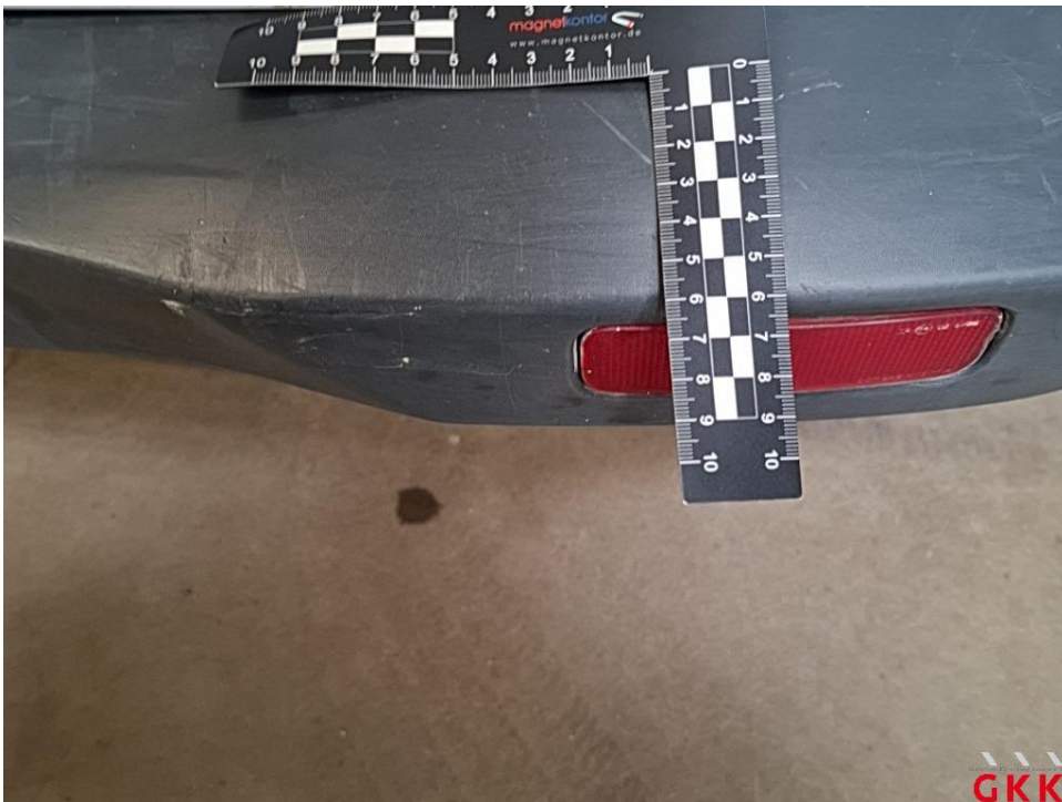
Bild 38 Stoßfänger hinten, Verkleidung -unlackiert-, beschädigt, ersetzen
