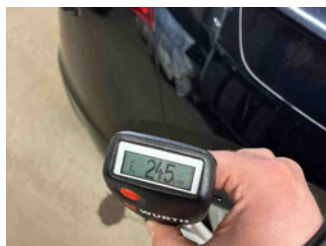
Lackstärke Seitenwand hinten rechts
