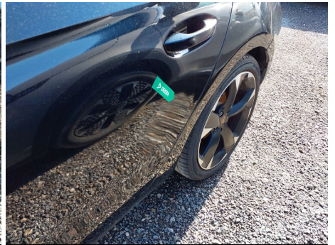
Puerta / Trasero Izquierdo / Mala reparación
