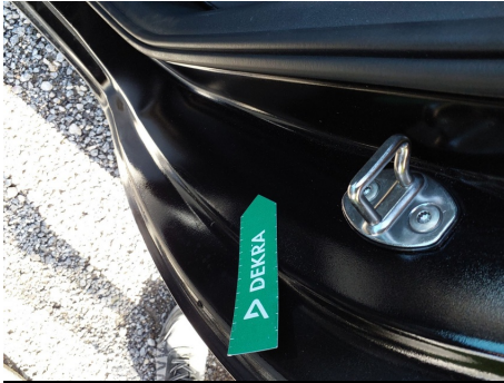
Travesaño de la puerta / Trasero Izquierdo / Mala reparación
