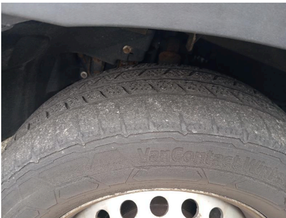
Bild: 23 Reifen vorne abgefahren
