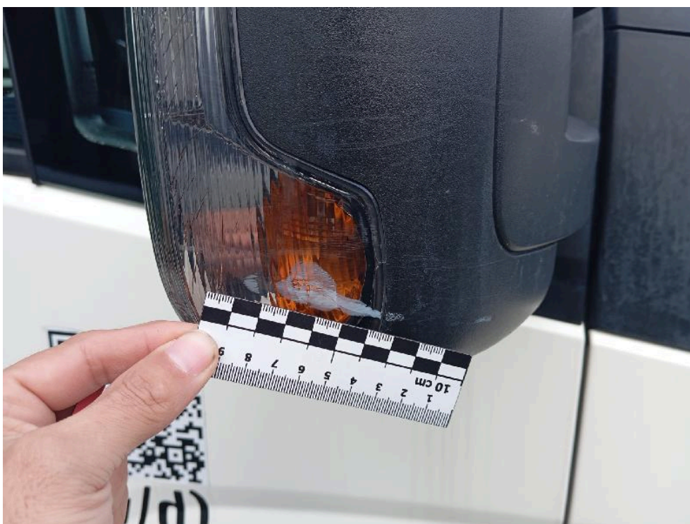
Bild: 18 Seitenspiegel rechts kratzbeschädigt
