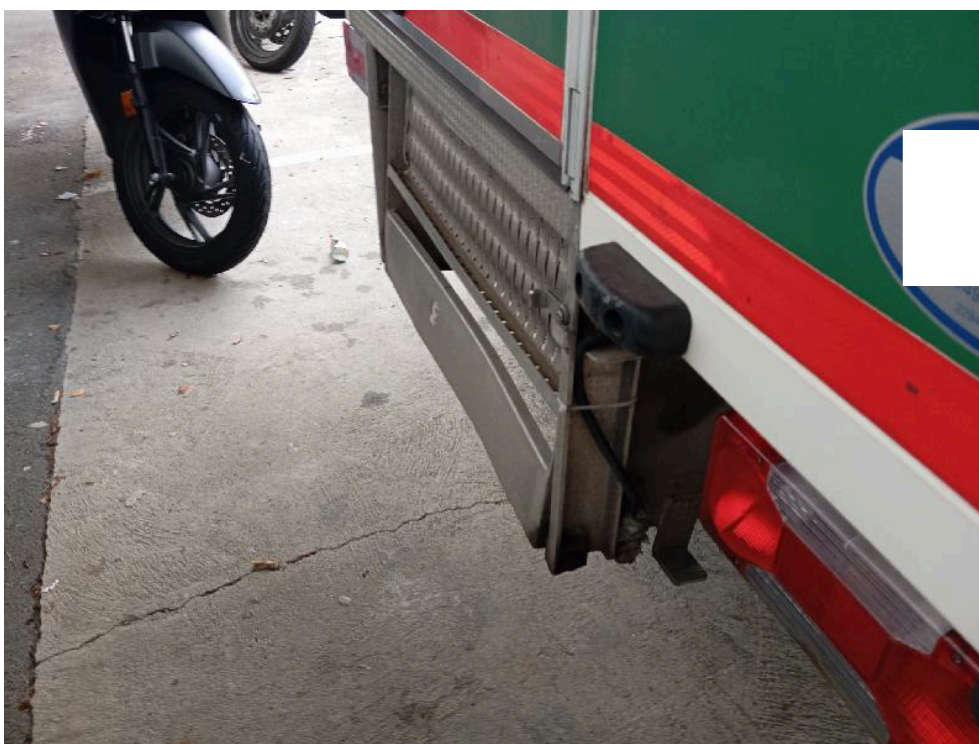
Bild: 26 Trittleiter hinten verformt
