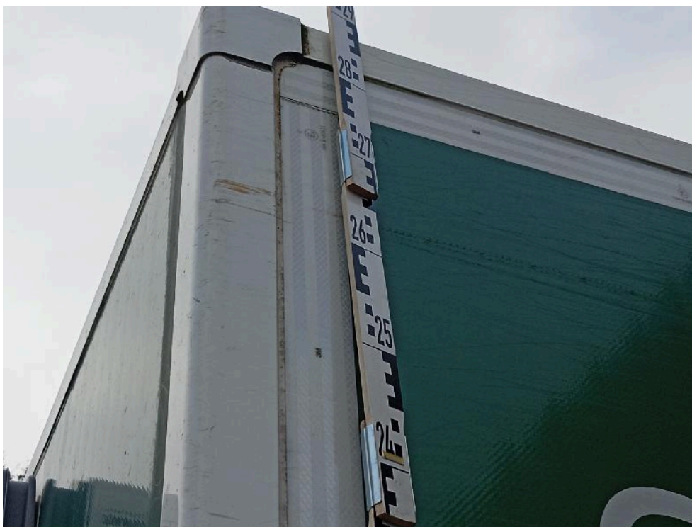
Bild: 21 Kofferaufbau links kratzbeschädigt und verformt
