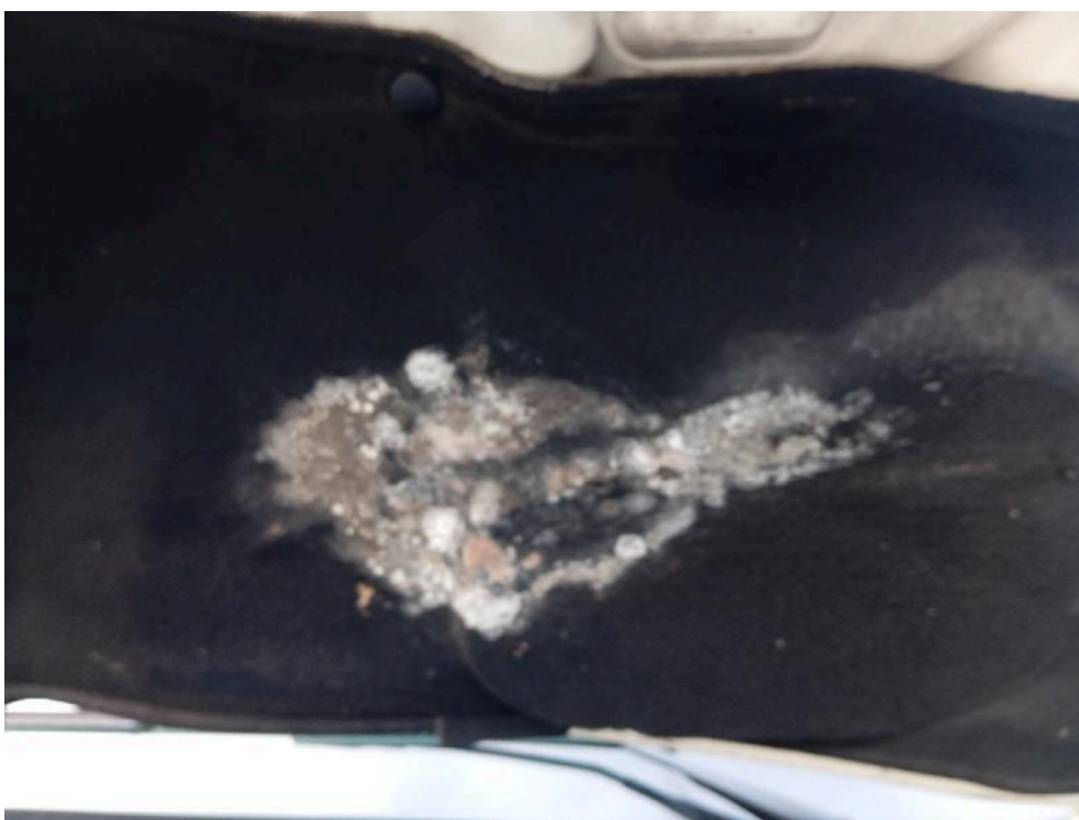
Bild: 10 Motorhaube Dämmung Schimmel
