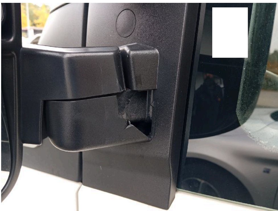
Bild: 34 Spiegelgehäuse links gebrochen
