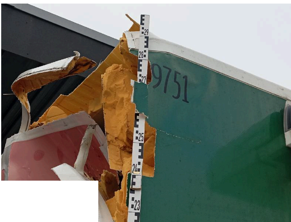
Bild: 30 Kofferaufbau rechts kratzbeschädigt und verformt
