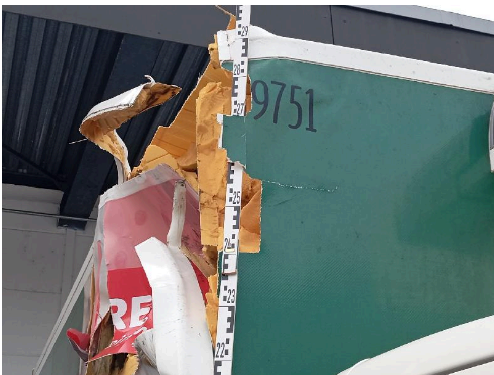
Bild: 31 Kofferaufbau rechts kratzbeschädigt und verformt
