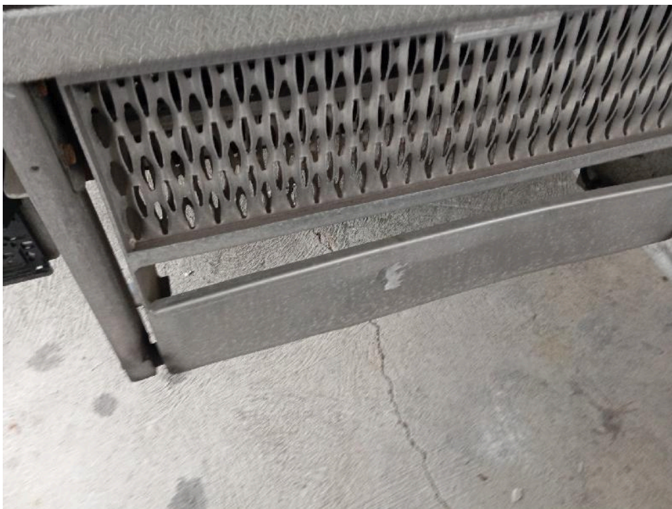
Bild: 25 Trittleiter hinten verformt
