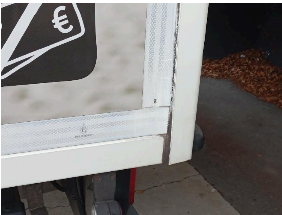
Bild: 22 Kofferaufbau links kratzbeschädigt und verformt
