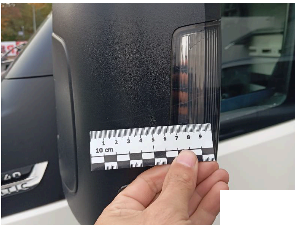
Bild: 14 Seitenspiegel links kratzbeschädigt
