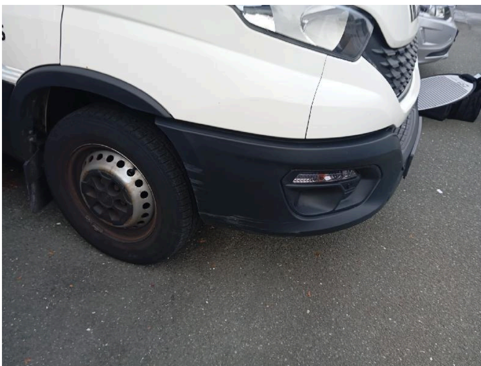
Bild: 16 Stoßfänger vorne kratzbeschädigt
