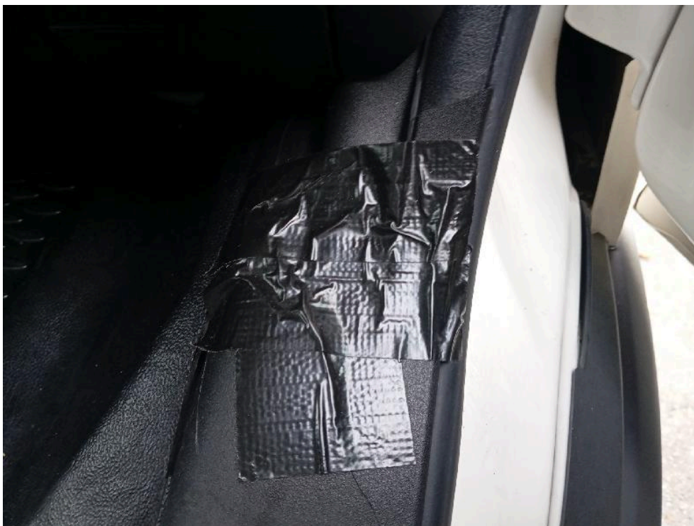
Bild: 19 Innenverkleidung rechts gebrochen
