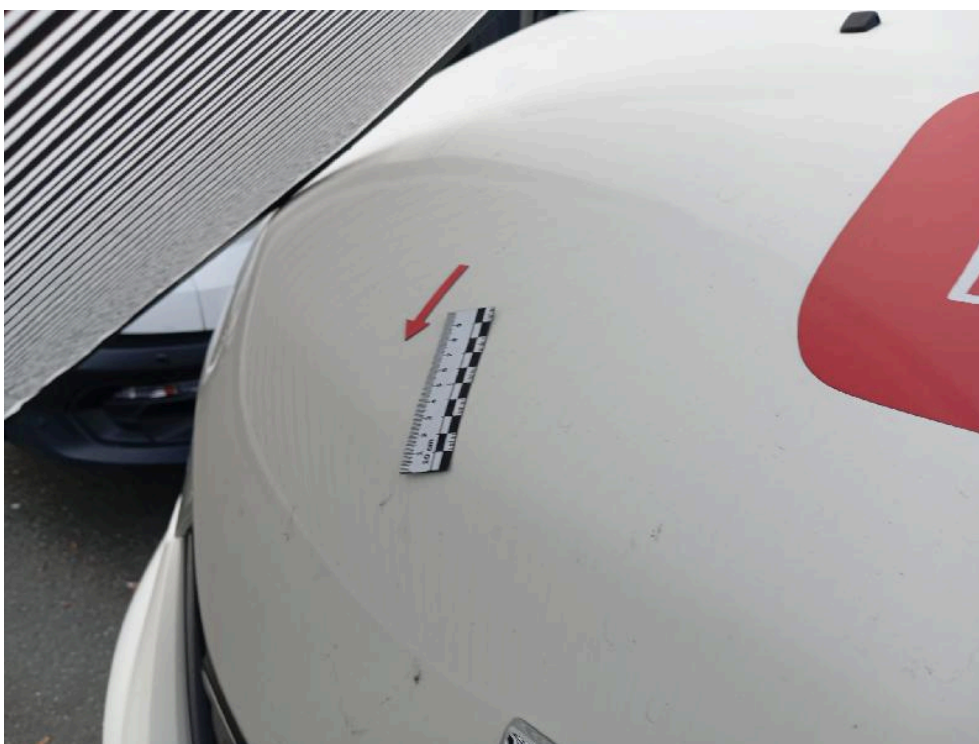
Bild: 12 Motorhaube verformt
