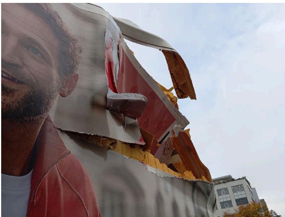
Bild: 32 Kofferaufbau rechts kratzbeschädigt und verformt
