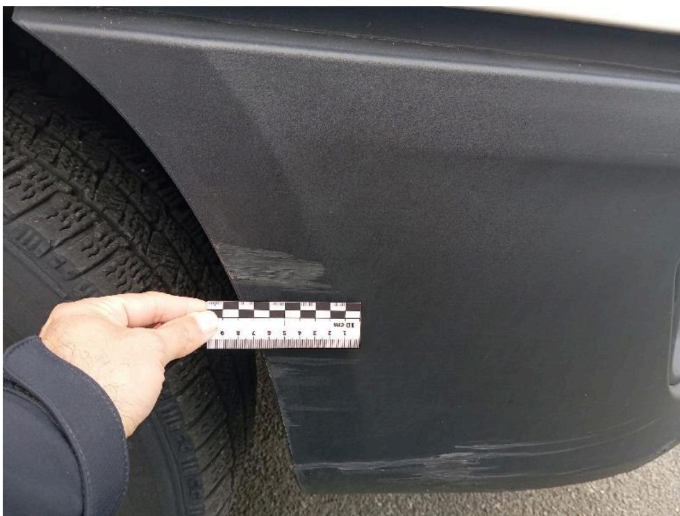
Bild: 17 Stoßfänger vorne kratzbeschädigt
