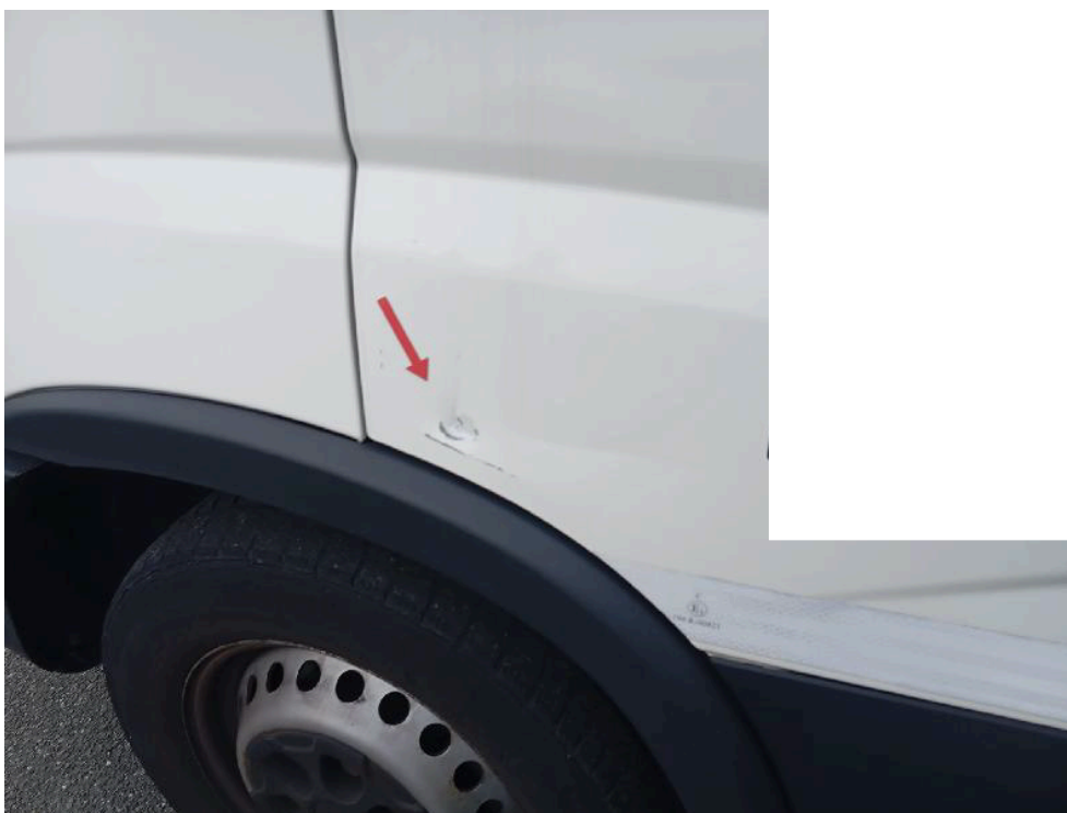
Bild: 13 Tür vorne links verformt
