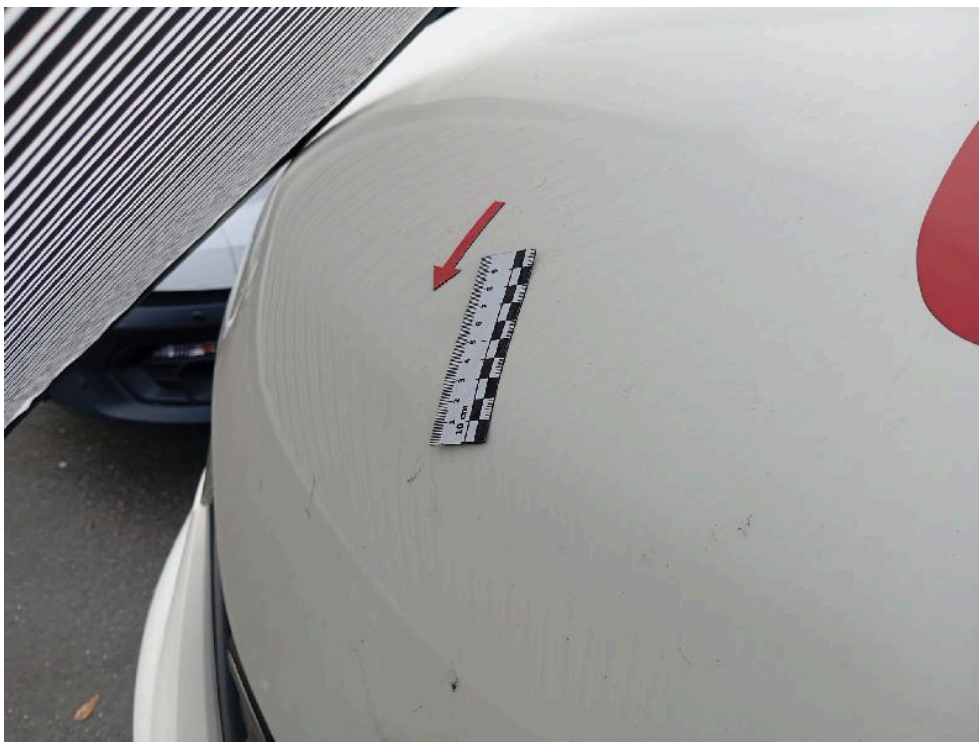
Bild: 11 Motorhaube verformt
