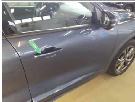
Türgriff Außen / Vorne Rechts / Kratzer
