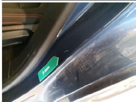
Türeinstieg / Hinten Links / Kratzer
