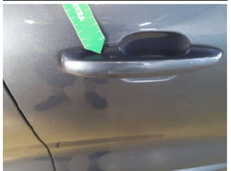
Türgriff Außen / Vorne Rechts / Kratzer
