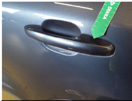
Türgriff Außen / Hinten Links / Kratzer
