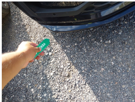
Spoiler / Delantero / Abolladura
