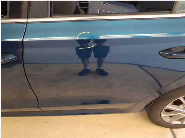
Beschädigung #2: Tür hinten links: Tür - verkratzt / verschürft - auslegen / polieren
