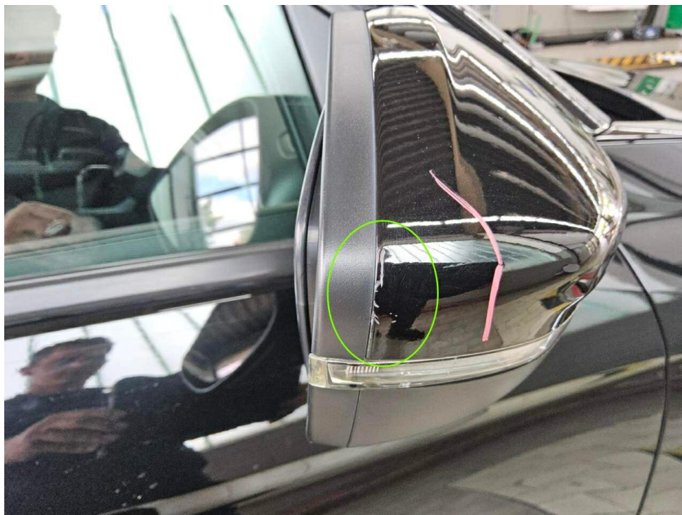
Bild 21 : Außenspiegel rechts Lackierung, verschrammt, smart repair
