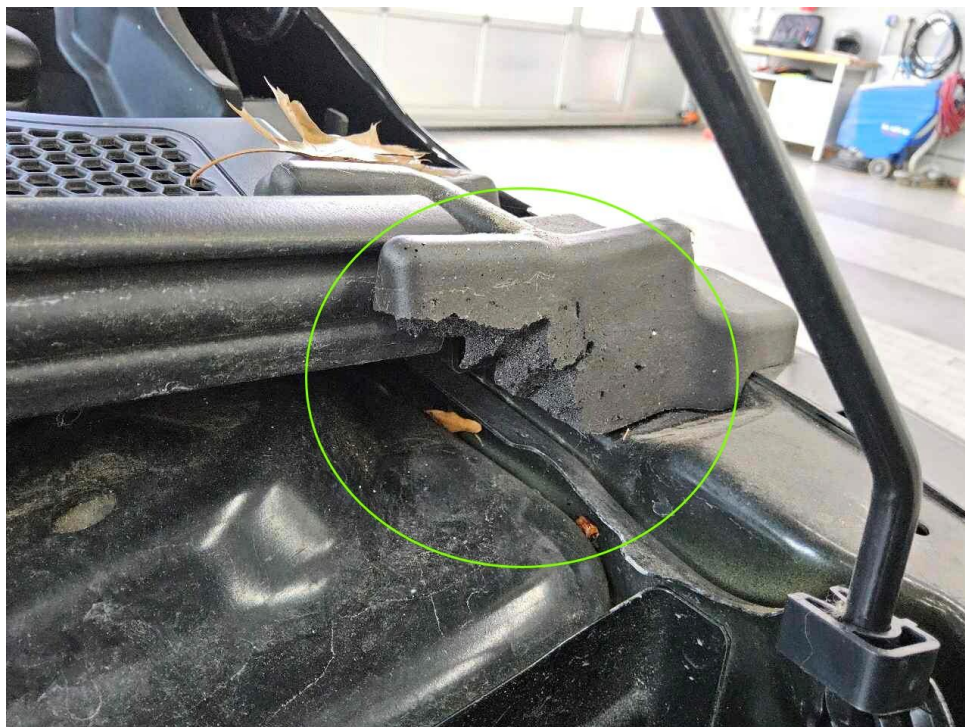
Bild 14 : Tierverschiss Motorraum, Schaumstoffecken erneuern
