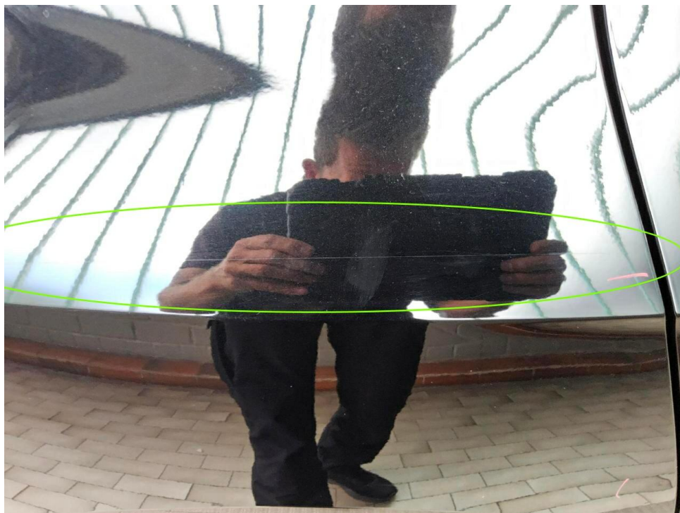
Bild 27 : Seitenteil hinten rechts Lackierung, zerkratzt, polieren
