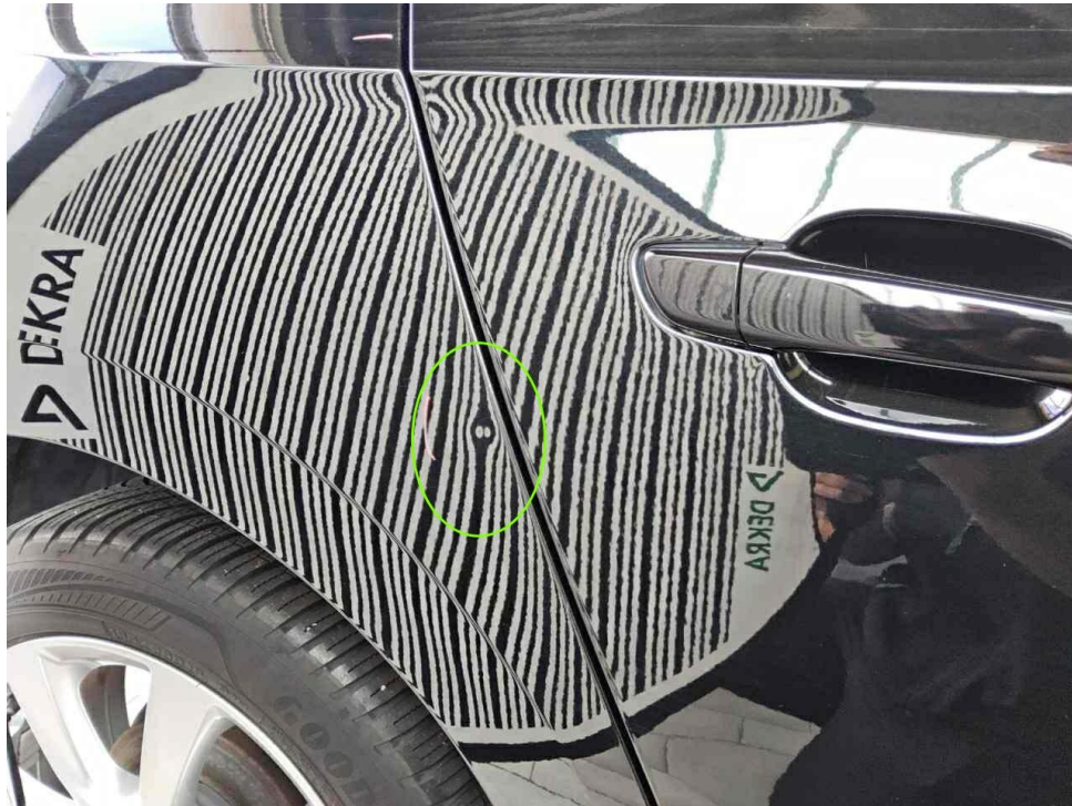
Bild 23 : Seitenteil hinten rechts, eingedellt, drücken
