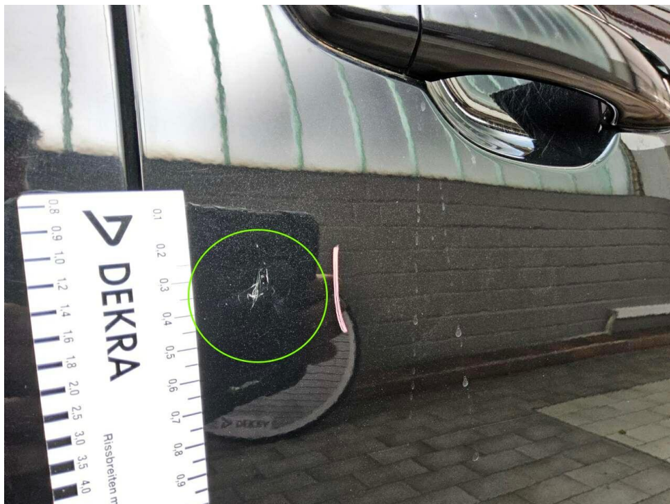
Bild 20 : Tür vorne rechts Lackierung, verschrämmt, lackieren
