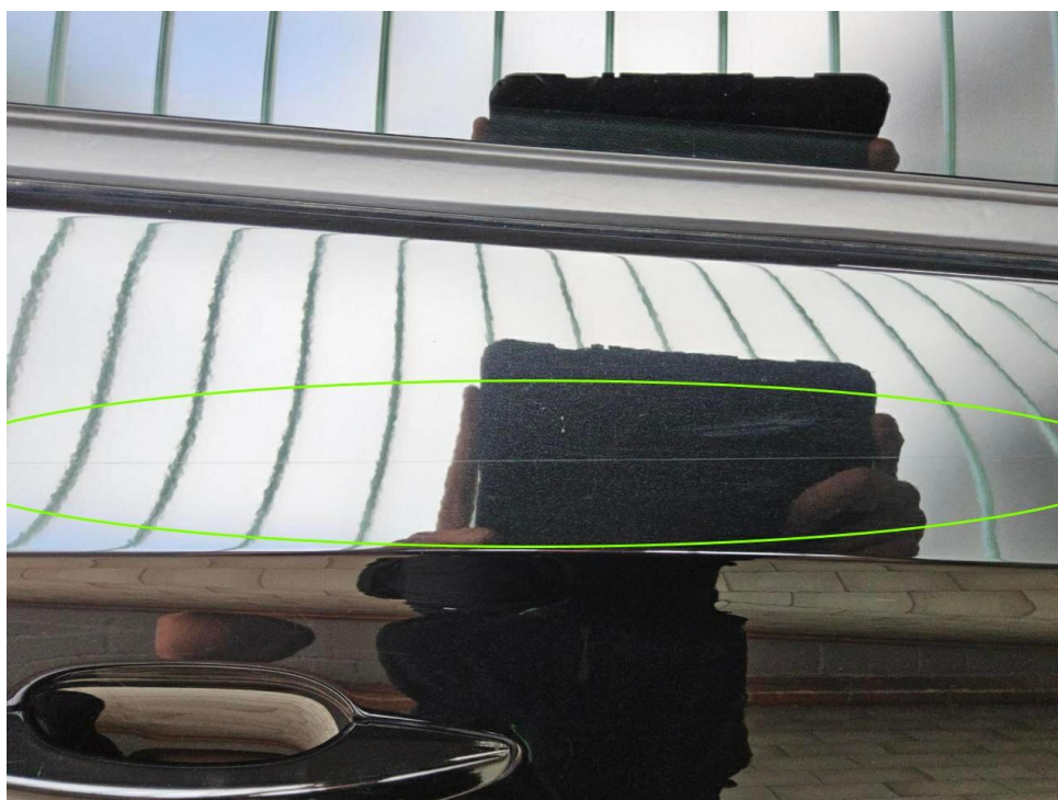
Bild 28 : Tür hinten rechts Lackierung, zerkratzt, polieren
