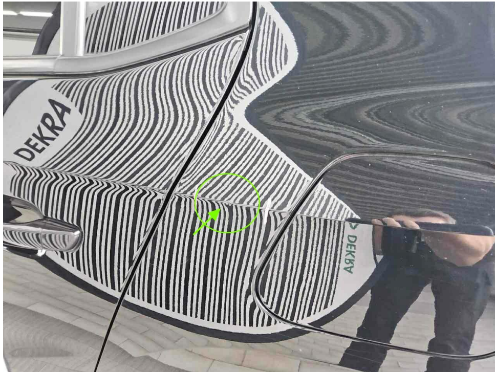
Bild 19 : Seitenteil hinten links, eingedellt, smart repair
