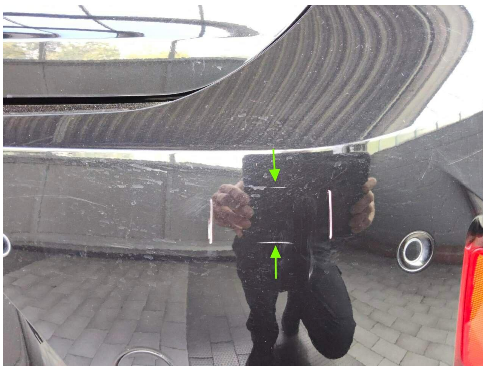
Bild 22 : Stoßfänger hinten Lackierung, verschrammt, smart repair
