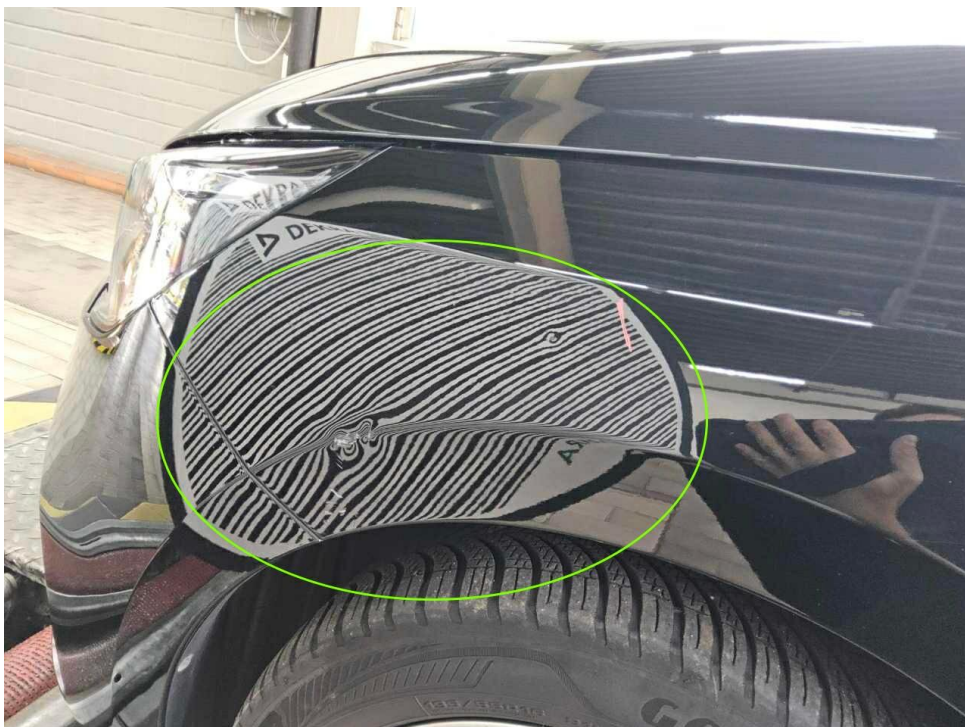
Bild 18 : Kotflügel vorne links, verformt
