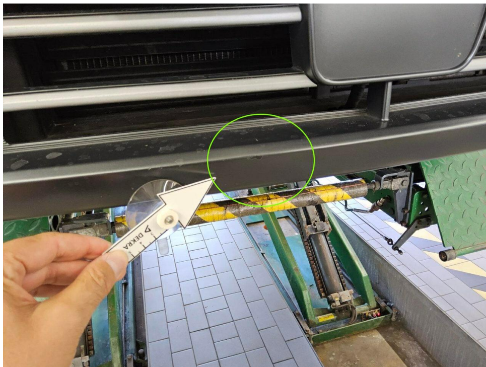
Bild 7 : Frontspoiler, verformt, instandsetzen und lackieren mit Lackaufbau
