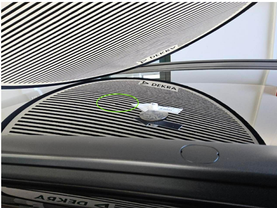
Bild 12 : Dach, mehrfach eingedellt, drücken
