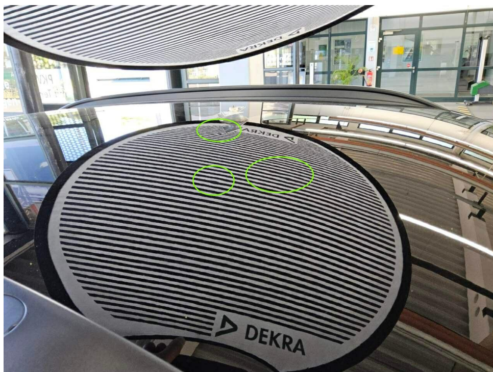
Bild 10 : Dach, mehrfach eingedellt, drücken
