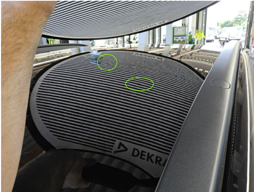
Bild 11 : Dach, mehrfach eingedellt, drücken
