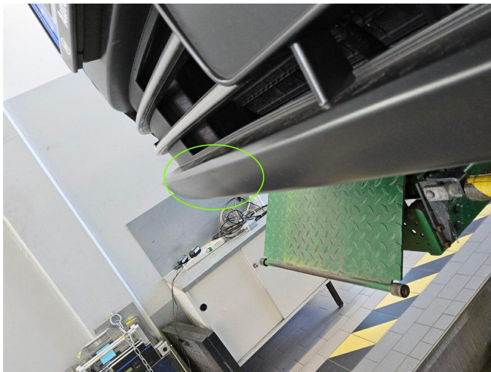
Bild 8 : Frontspoiler, verformt, instandsetzen und lackieren mit Lackaufbau
