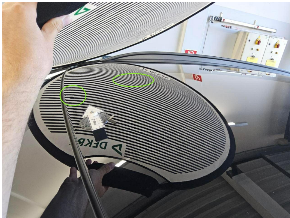
Bild 14 : Dach, mehrfach eingedellt, drücken
