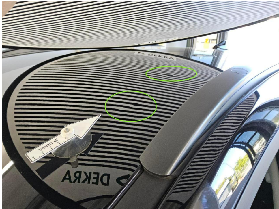
Bild 13 : Dach, mehrfach eingedellt, drücken
