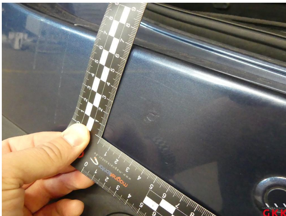
Bild 17 Stoßfänger hinten, Verkleidung -lackiert-, verkratzt, lackieren
