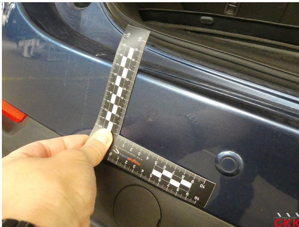
Bild 16 Stoßfänger hinten, Verkleidung -lackiert-, verkratzt, lackieren
