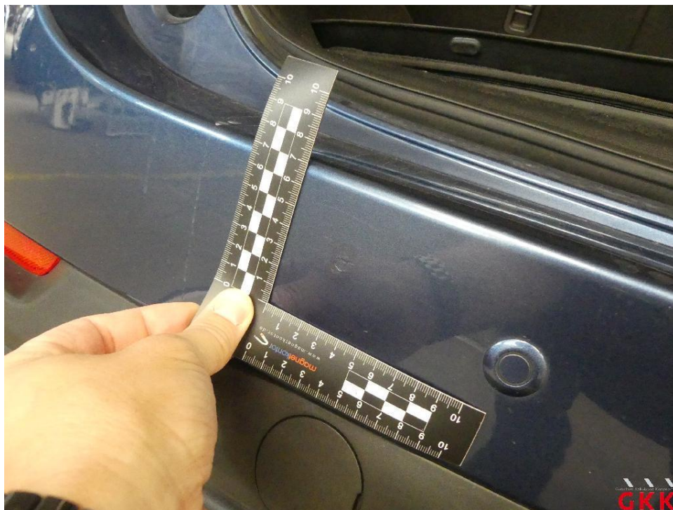
Bild 16 Stoßfänger hinten, Verkleidung -lackiert-, verkratzt, lackieren
