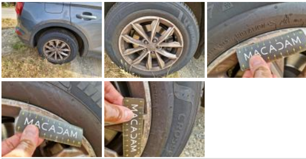
Alloy rim RL, Scratch(es), Repair/replace (lump sum)
